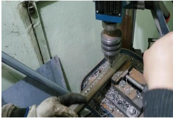
Figura 14: Perforación de los tubos de metal
