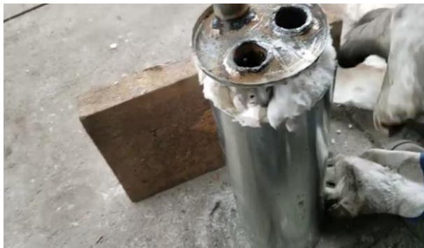
Figura 16: Llenado de la fibra de vidrio en el silenciador
