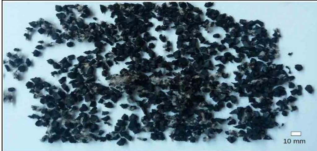
Figura 1. Fibras de caucho de neumáticos fuera de uso utilizadas en concreto.
