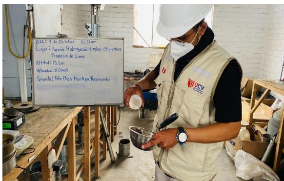
Figura 15. Ensayo de Índice de Plasticidad con la incorporación de ceniza de cascara de coco.
