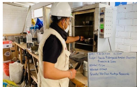
Figura 20. Ensayo de óptimo contenido de humedad y máxima densidad seca con la incorporación de ceniza de cascara de coco.
