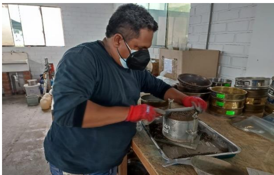
Figura 21. Ensayo de óptimo contenido de humedad y máxima densidad seca con la incorporación de ceniza de cascara de coco.
