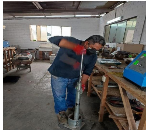
Figura 6. Se precedió a realizar los golpes en un Molde de compactación de C.B.R.
