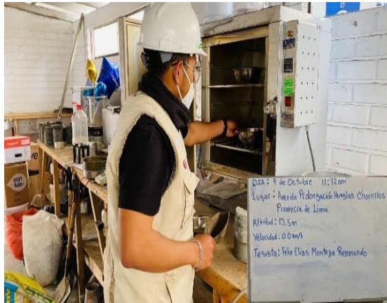
Figura 5. Se llevo al horno la muestra para determinar el optimo contenido de humedad y máxima densidad seca con la incorporación de ceniza de cascara de coco C2-M1
