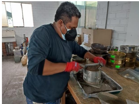
Figura 7. Ensayo de optimo contenido de humedad y máxima densidad seca con la incorporación de ceniza de cascara de coco.
