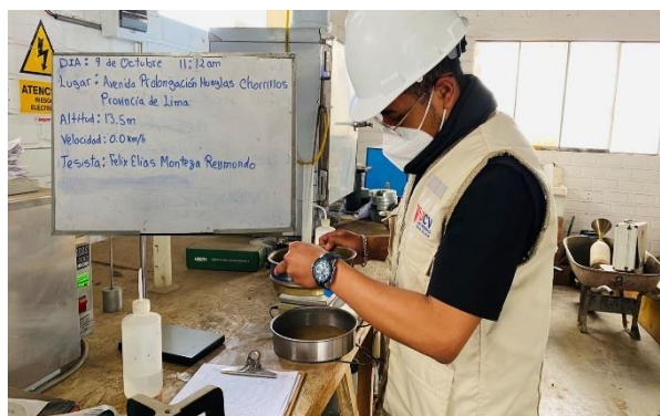
Figura 14. Ensayo de Índice de Plasticidad con la incorporación de ceniza de cascara de coco.
