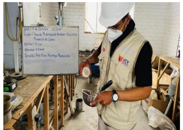
Figura 8. Se incorporo agua en un recipiente con la muestra fina para determinar el ensayo de Índice de Plasticidad con la incorporación de ceniza de cascara de coco
