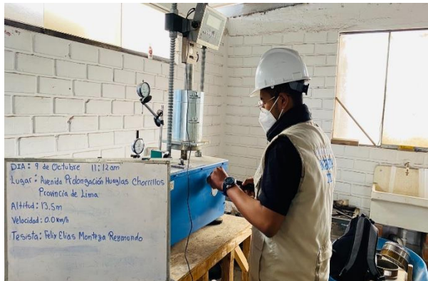
Figura 18. Ensayo de C.B.R con la ceniza de cascara de coco.
