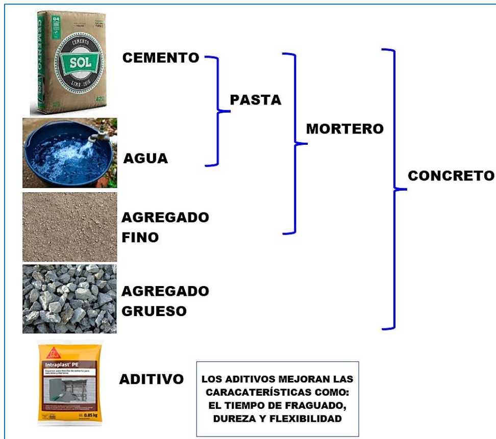
Figura 3. Composición del concreto.
