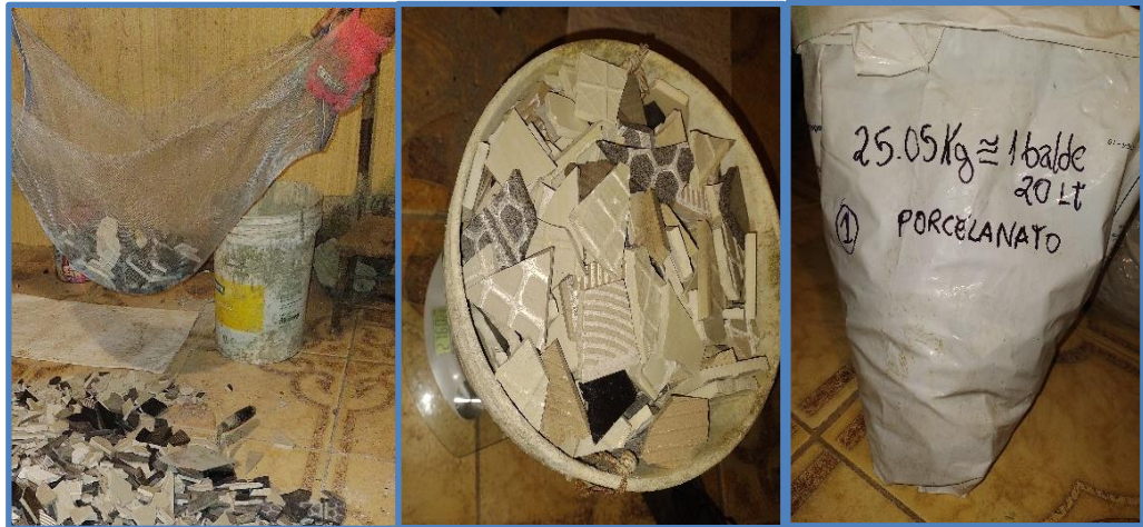
Figura 18. Zarandeo, pesado y empaque del porcelanato triturado.
