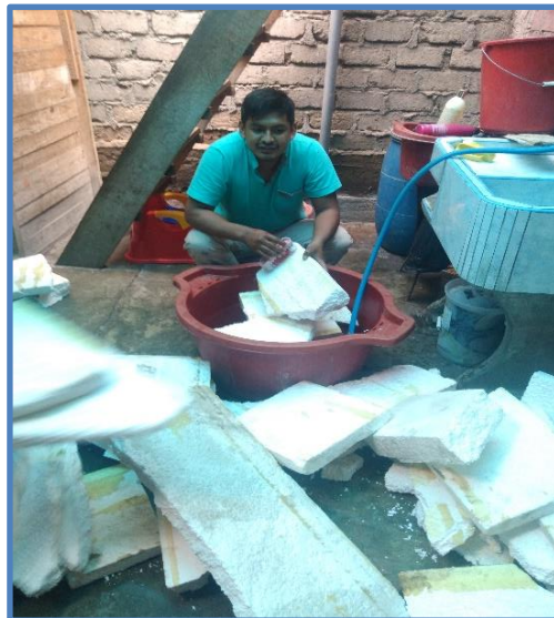
Figura 21. Limpieza del poliestireno reciclado.
