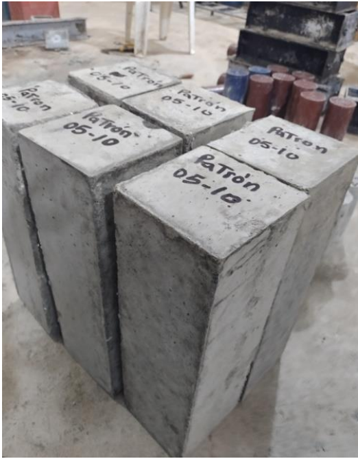
Fotografía 09: Muestras de concreto probetas prismáticas
