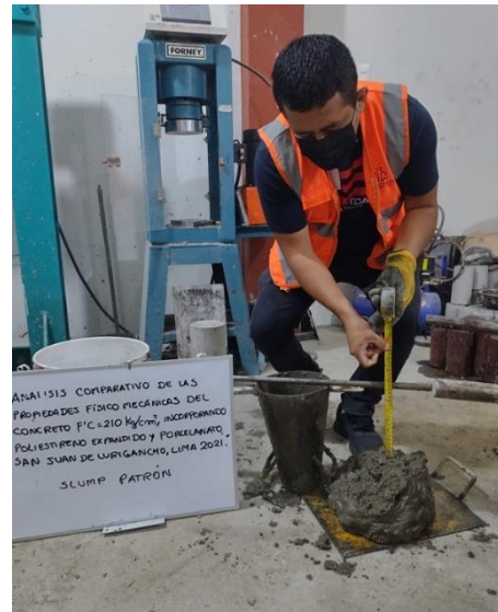
Fotografía 04: Determinación de Slump
