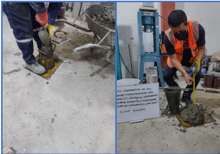
Figura 31. Determinación del asentamiento
