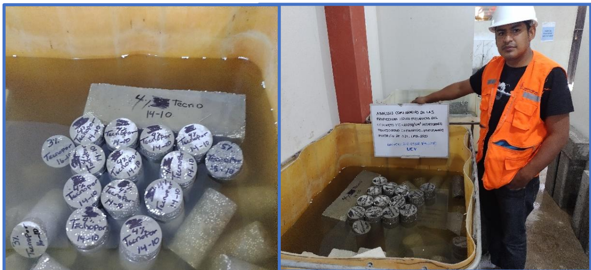
Figura 6. Curado del concreto.
