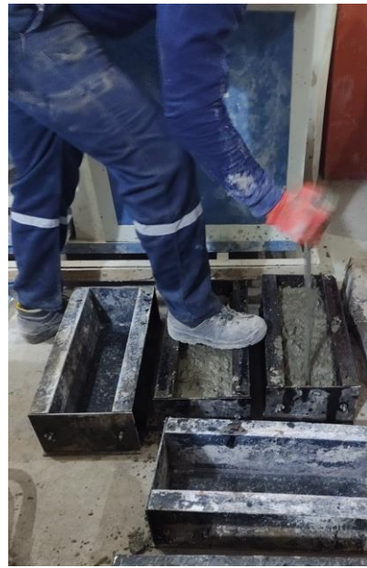
Fotografía 06: Preparación de probetas prismáticas
