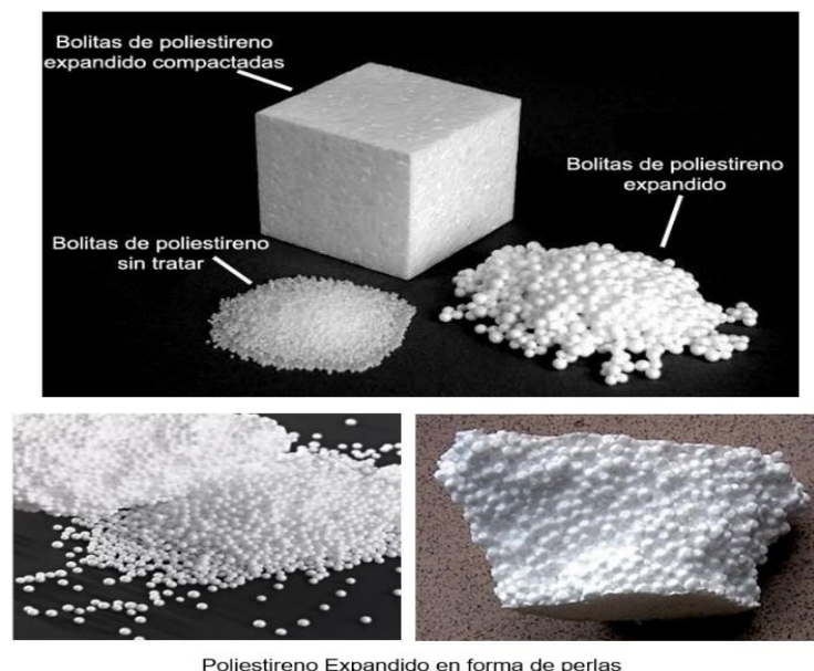
Figura 2. Características del poliestireno expandido y compactado.
