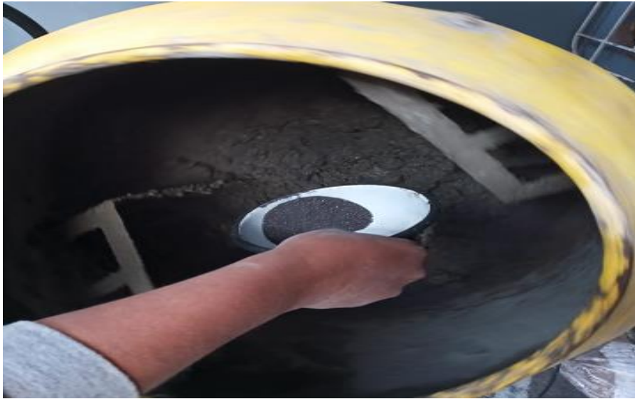
Foto 3.41 Elaboración de concreto con residuos de acero
