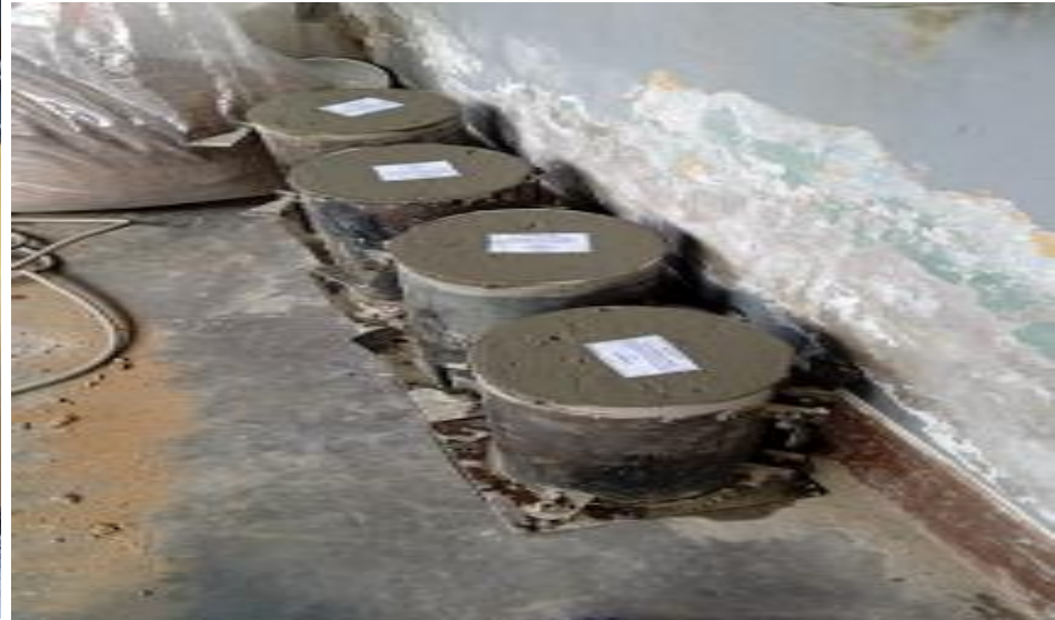
Foto 3.41 Elaboración de concreto con residuos de acero
