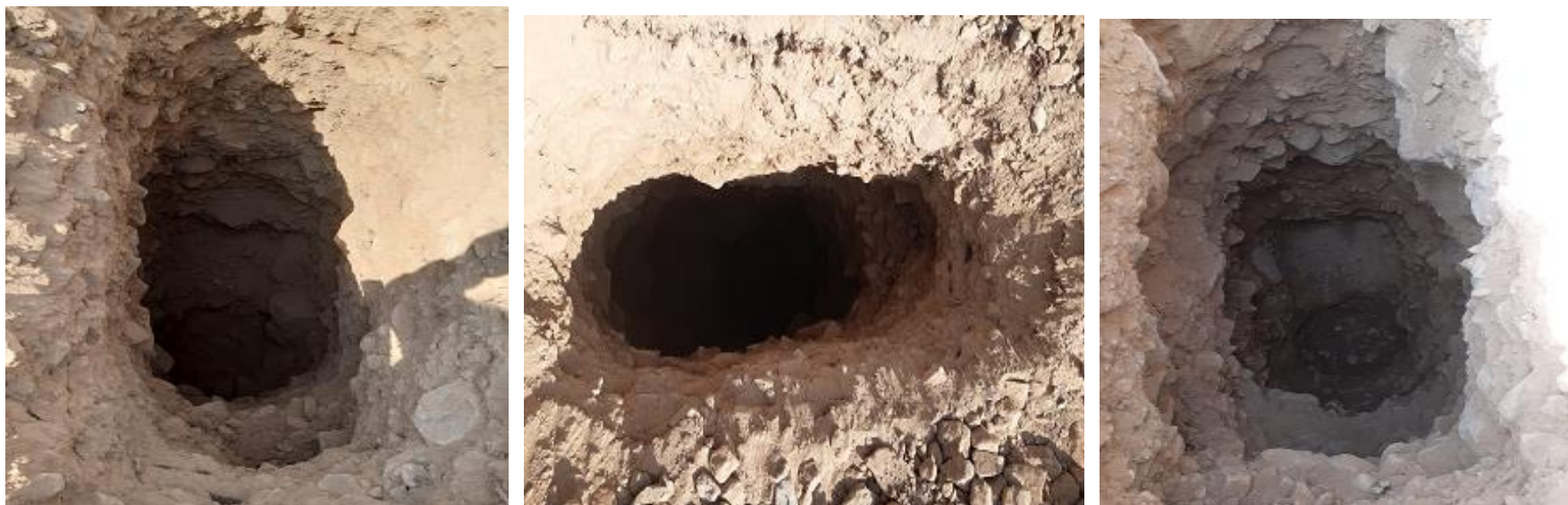
Foto 3.26 Perfil de profundidades de las calicatas 1, 2 y 3
