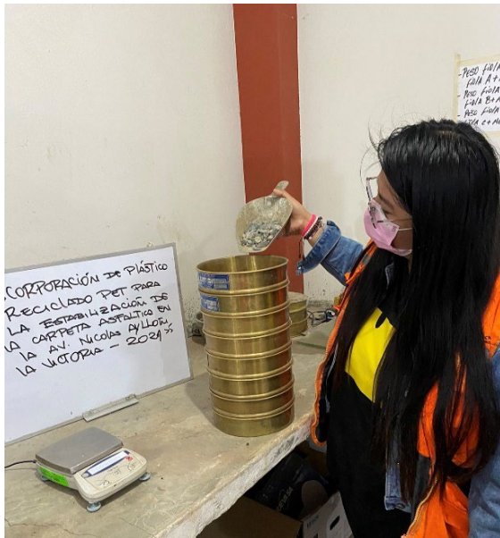
Ensayos de granulometría – 1
