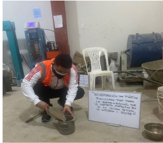
Preparación de briquetas – 2
