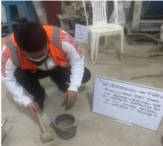
Preparación de briquetas – 1
