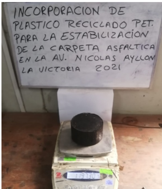
Briqueta de asfalto
