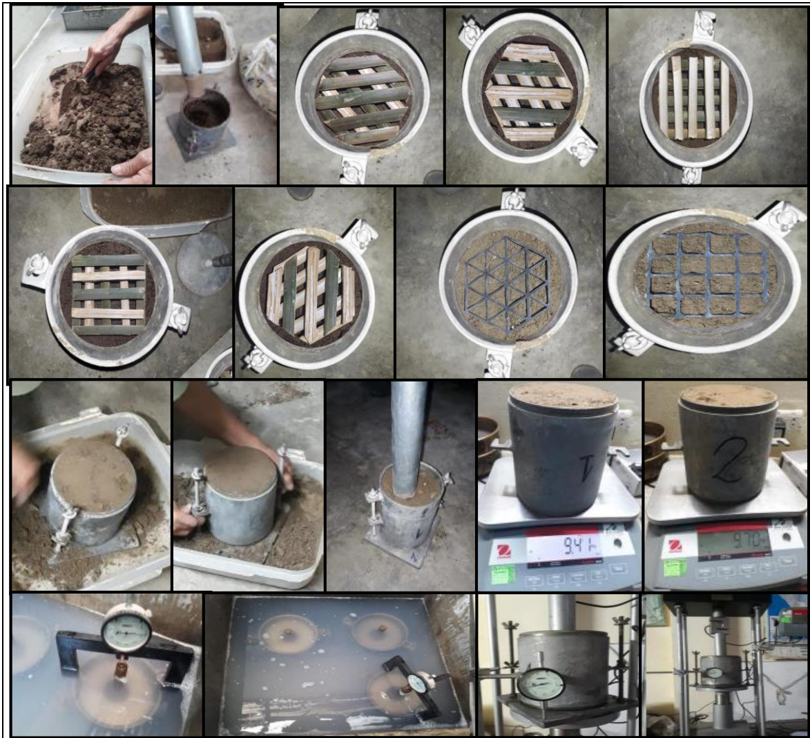
Ensayo de CBR con las geomallas biaxial y multiaxial de bambú y polipropileno.
