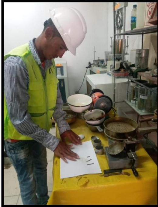
**Figura 33** La muestra se procede a humedecer para realizar el ensayo de limite líquido
