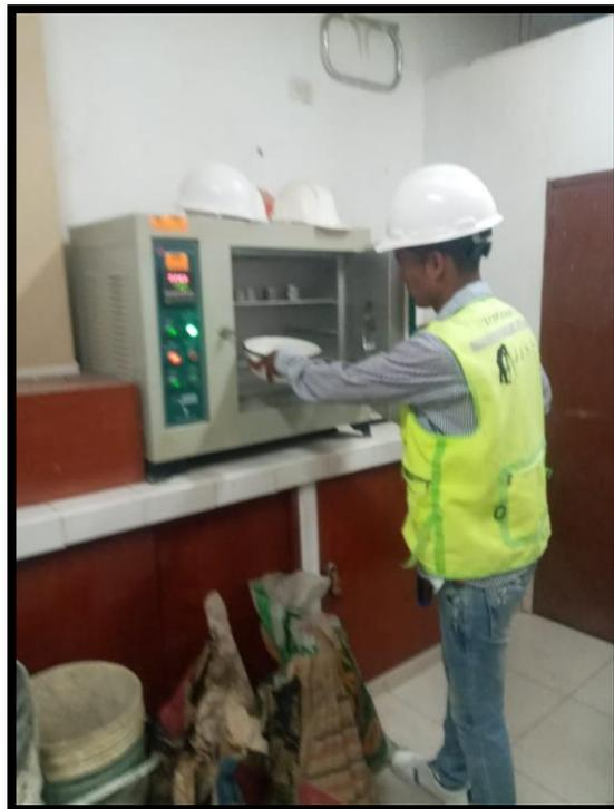
**Figura 34** Las muestras del ensayo de limite líquido, se procede a transportarlos al horno.
