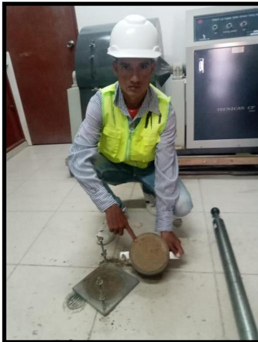
**Figura 30** Se culmino de realizar la compactación, para después ser sumergidas en agua las muestras para el ensayo de CBR.
