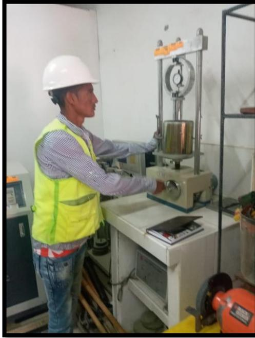
**Figura 31** Se puede observar como el tesista, realiza la prueba de CBR
