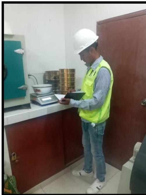
**Figura 32** Se realiza el tamizaje y tomar los datos para realizar los ensayos de límite líquido y límite plástico.
