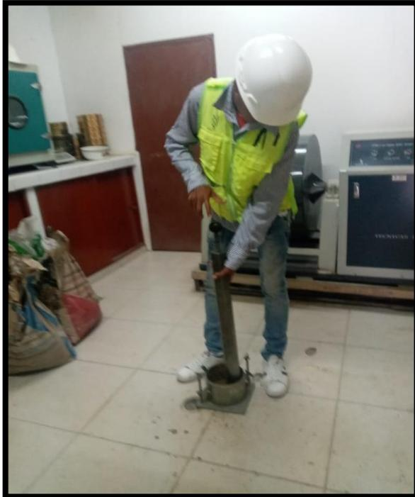
**Figura 29** Se está realizando el ensayo de compactación para el ensayo de CBR
