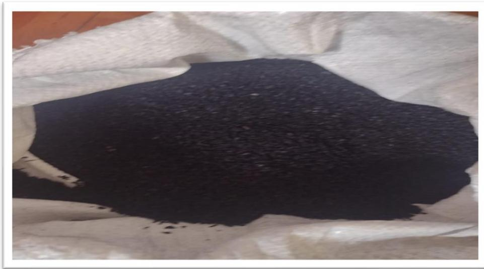
**Figura 5.** Caucho triturado de llantas en desuso.
