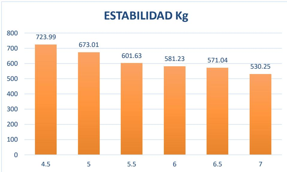
**Figura 40.** Gráfico de barras de la estabilidad de las 6 briquetas del diseño patrón Marshall.
