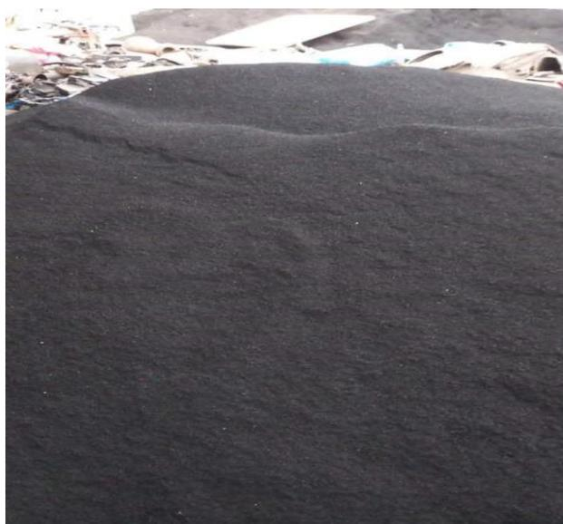
**Figura 32:** Acopio del caucho triturado.
