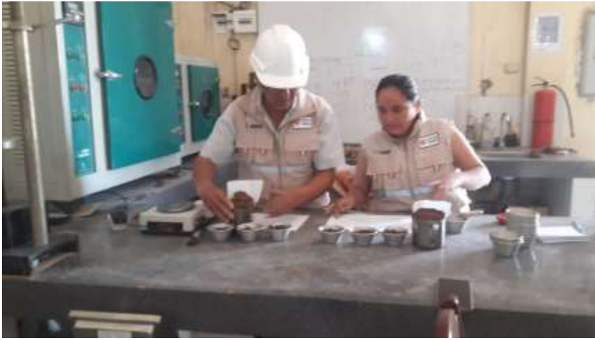
Ilustración 07: Muestra para el ensayo de contenido de humedad
