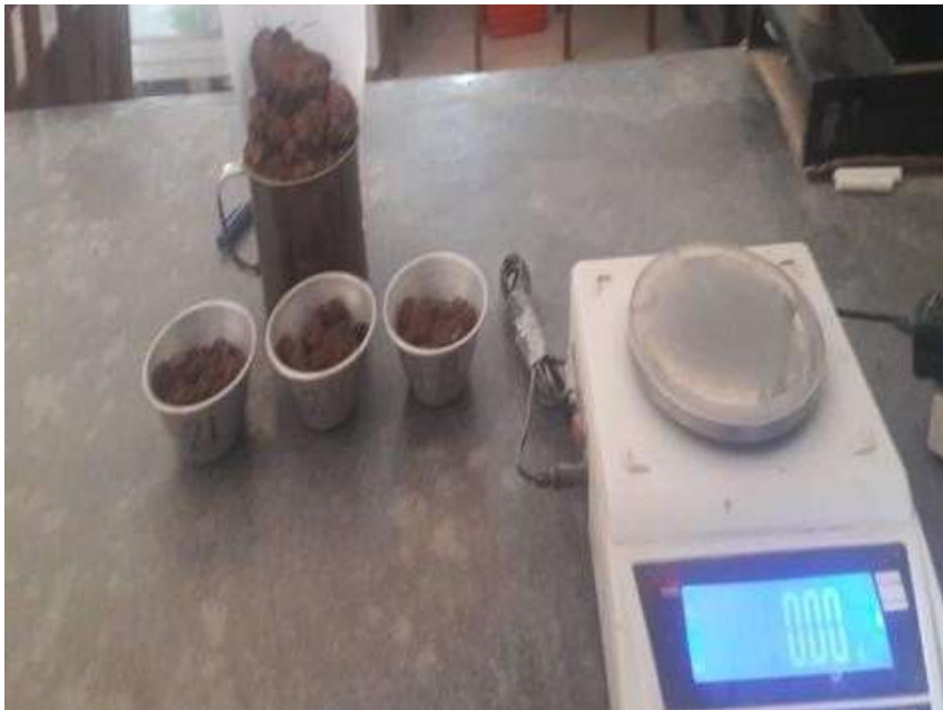
Ilustración 06: Muestra para el ensayo de contenido de humedad
