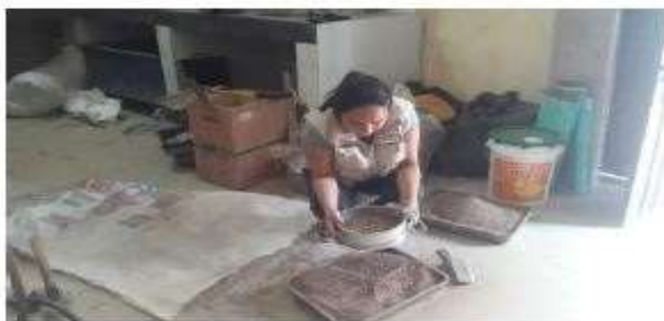
Foto 24: Tamizando la muestra para CBR (tamiz 04)
