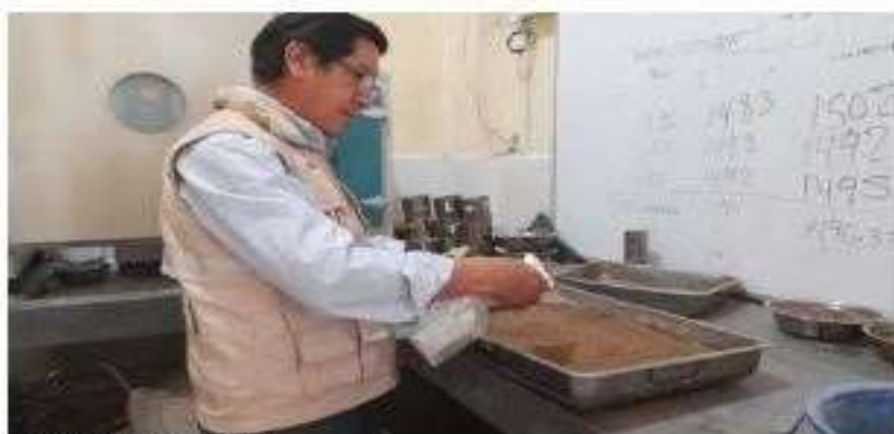
Foto 26: Adición de resina
