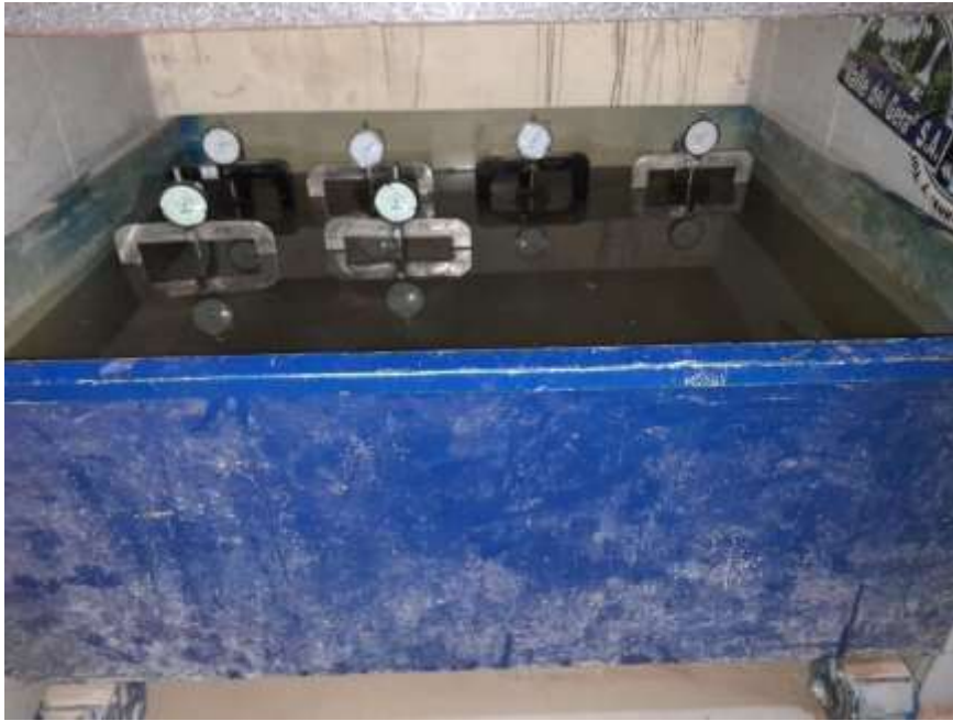
Ilustración 28: Saturación de la muestra de CBR
