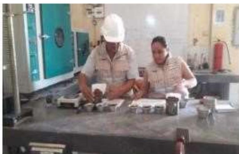
Foto 10: Muestra para el ensayo de contenido de humedad
