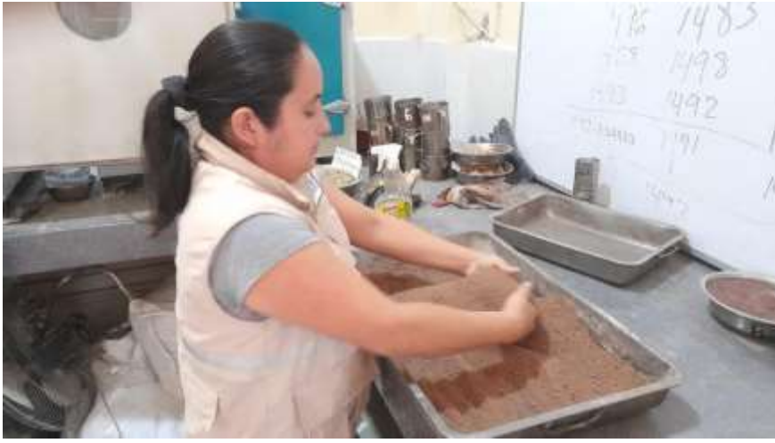
Ilustración 22: Mezclando la muestra para CBR
