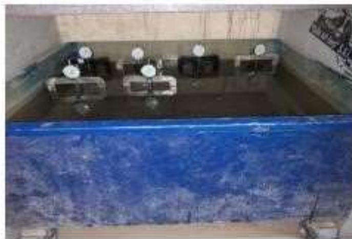
Foto 35: Saturación de la muestra de CBR
