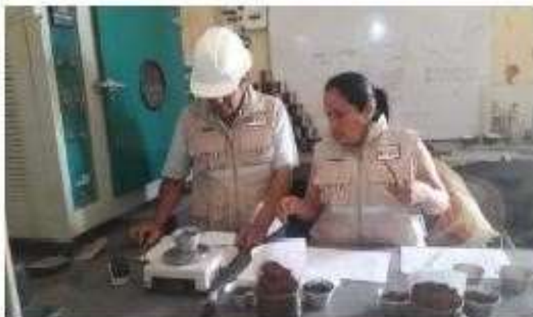
Foto 09: Tarado del peso del material más el molde, para determinar el contenido total de humedad natural.
