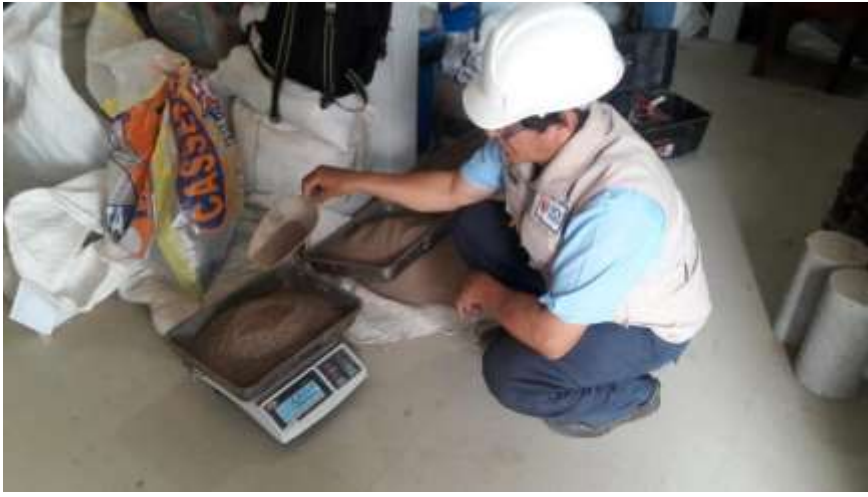
Ilustración 20: Pesando la muestra para CBR
