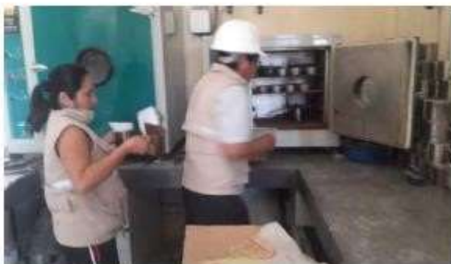
Foto 12: Colocando la muestra al Horno, para contenido de humedad
