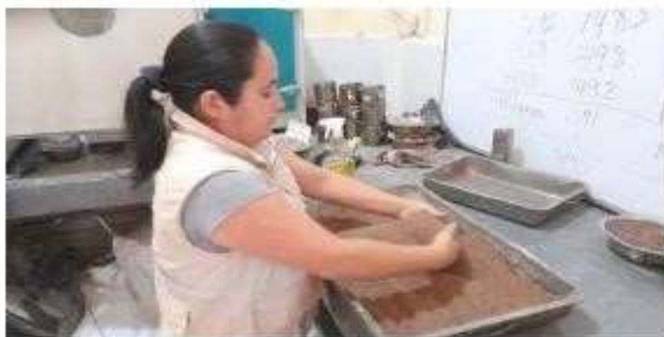
Foto 27: Mezclando la muestra para CBR
