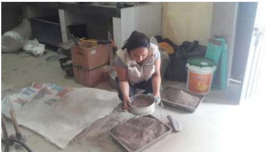
Ilustración 19: Tamizando la muestra para CBR (tamiz 04)
