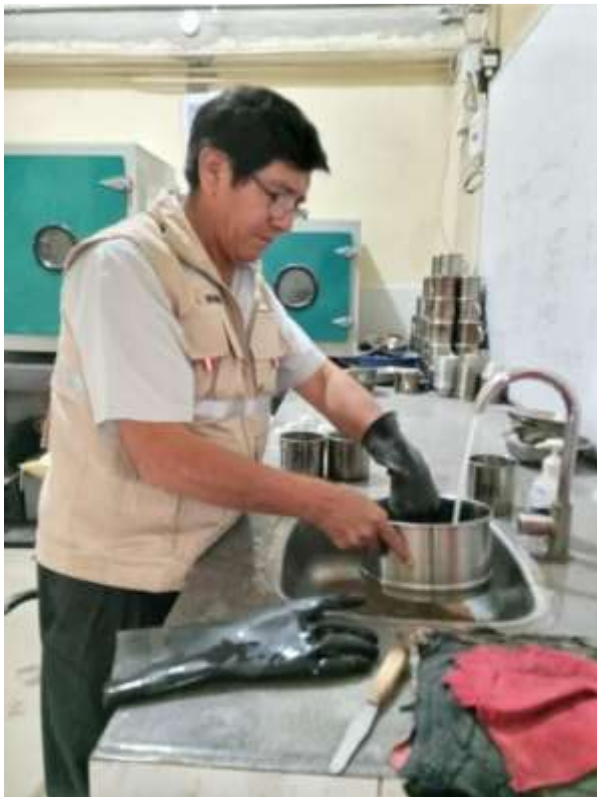
Ilustración 15: Lavando muestra para granulometría
