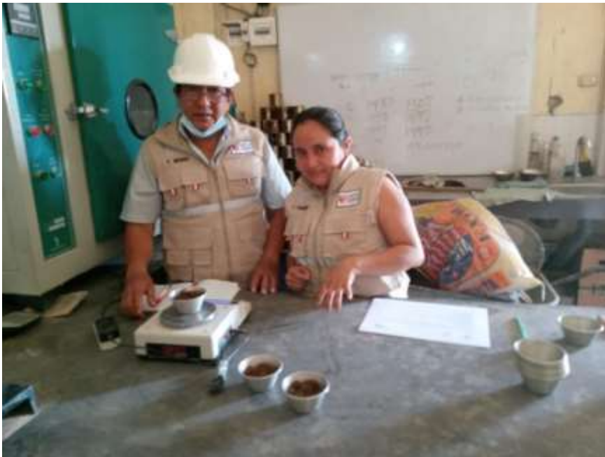
Ilustración 08: Pesando la muestra para contenido de humedad
