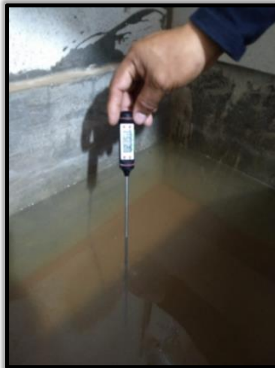
9. Temperatura para el ensayo de absorción 21.5 °c.
