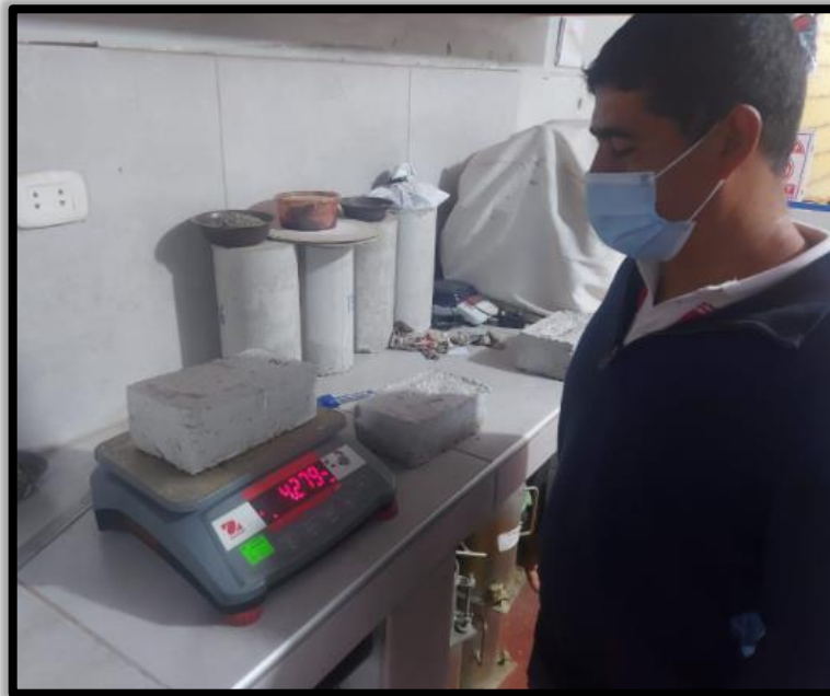
12. El peso del ladrillo de concreto en absorción.
