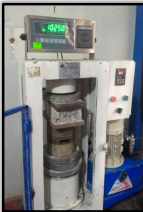
13. El ladrillo de concreto (M-1) sometido en la máquina uniaxial.
