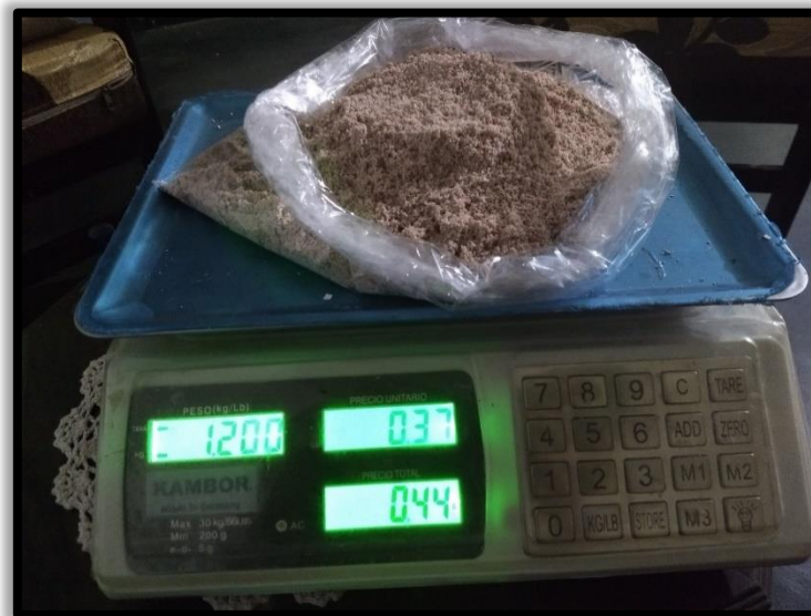
2. Pesando el elemento fino para los ensayos (húmedo).
