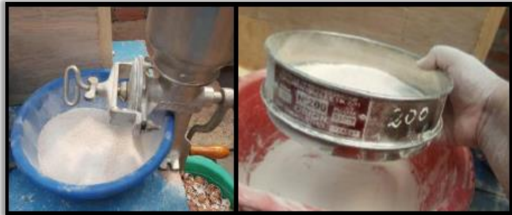
3. Granulometría del elemento fino (Cascara de Huevo).
