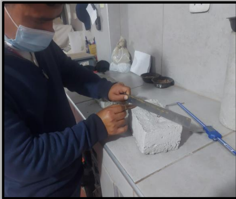
10. Ensayo de Alabeo al ladrillo para verificar su concavidad o convexidad
