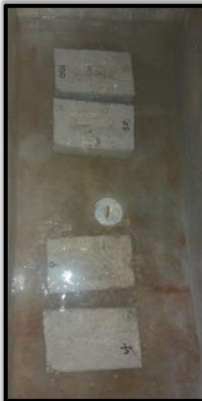
11. El ladrillo de concreto está sometido al curado
