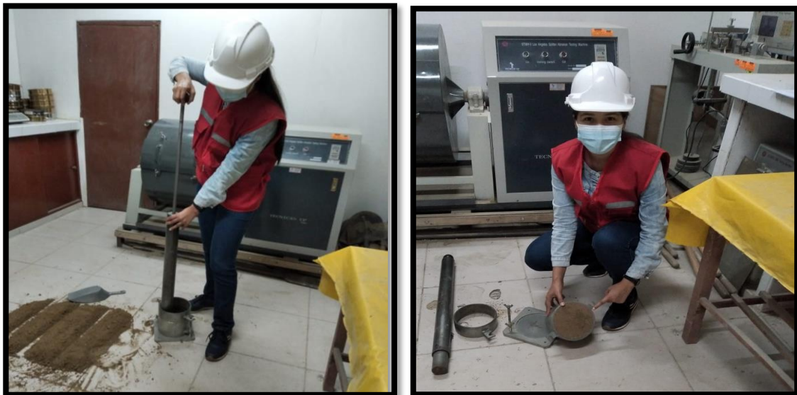
Figura 14 Procedimiento de Proctor Modificado.
