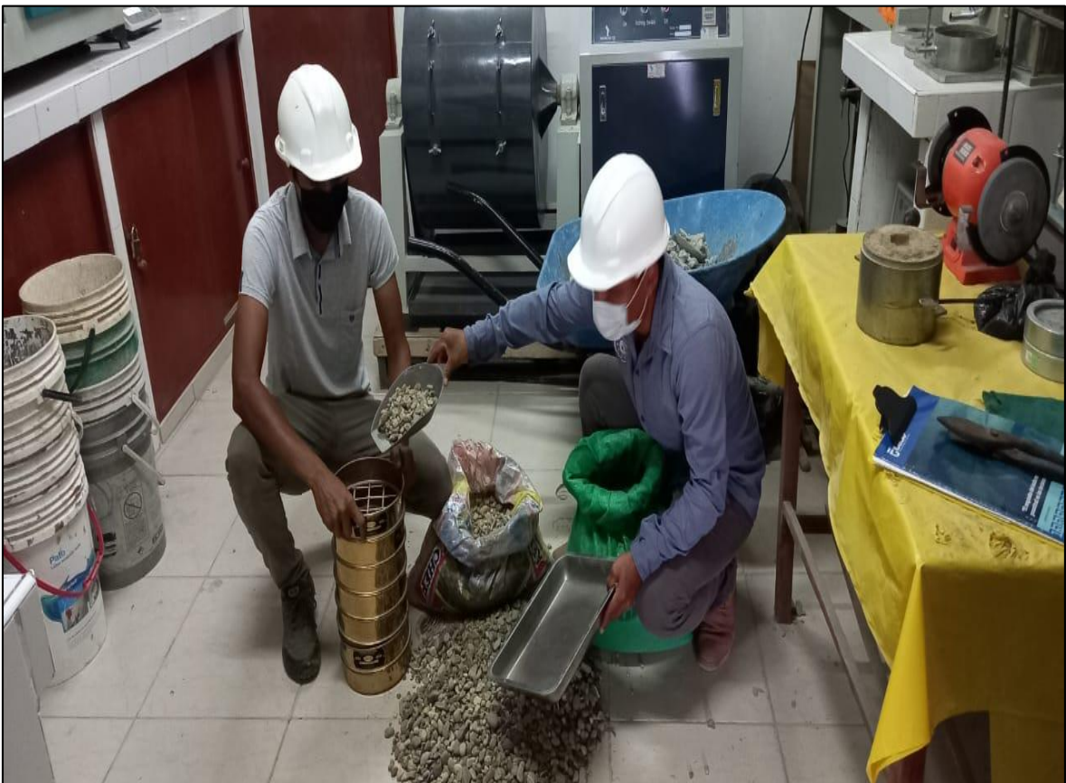
Análisis granulométrico por tamizado
