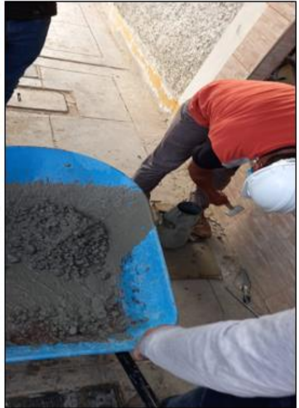
Ensayo cono de Abrams del concreto patrón F'c = 210 \text{ kg/m}^2
