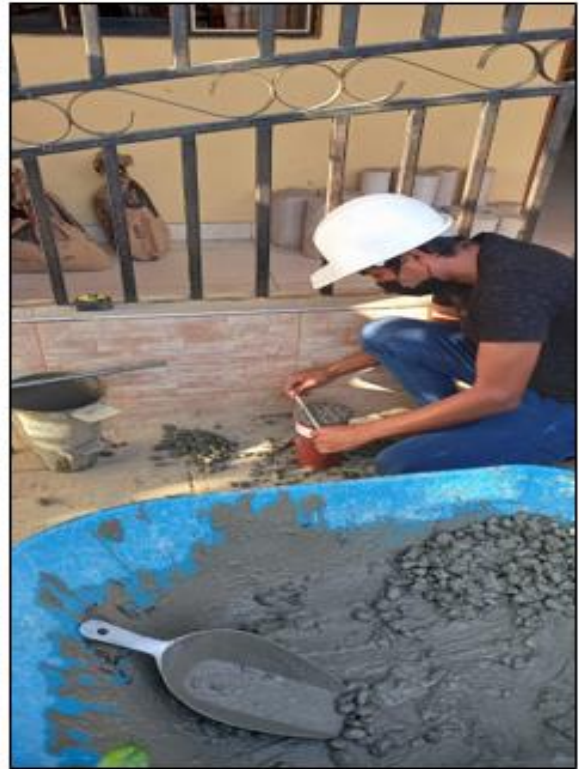
Elaboración de probetas de concreto modificado – F'c = 210 \text{ kg/cm}^2 con adición de fibras de acero.
