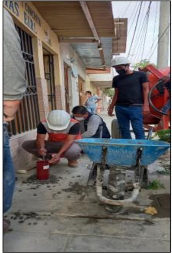
Elaboración de probetas de concreto modificado – F'c = 210 \text{ kg/cm}^2 con adición de fibras de acero.
