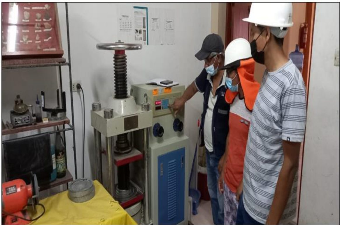
Ensayo de resistencia a la compresión de las probetas
