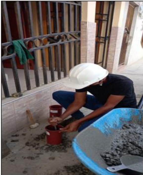
Elaboración de probetas de concreto modificado – F'c = 210 \text{ kg/cm}^2 con adición de fibras de acero.
