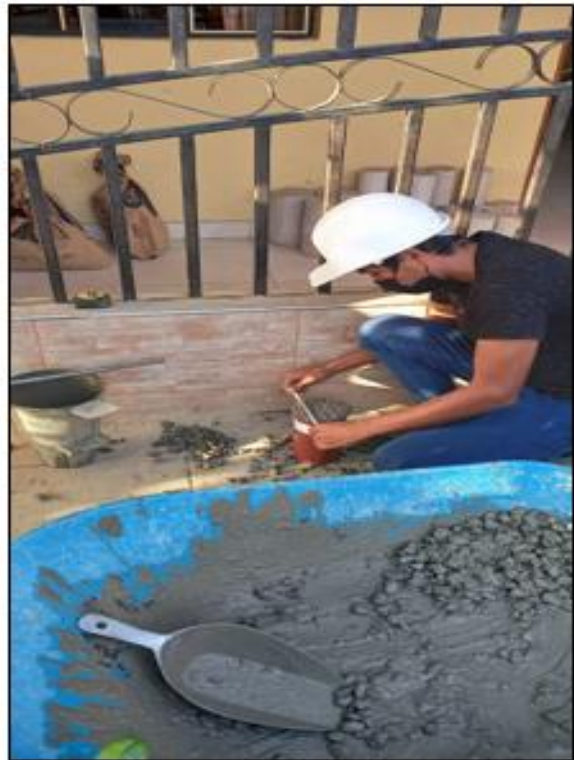
Elaboración de probetas con el concreto patrón – F'c = 210 \text{ kg/cm}^2 .
