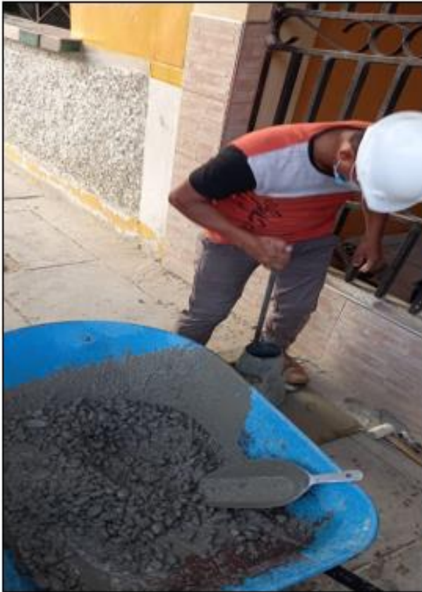
Ensayo cono de Abrams del concreto patrón F'c = 210 \text{ kg/m}^2
