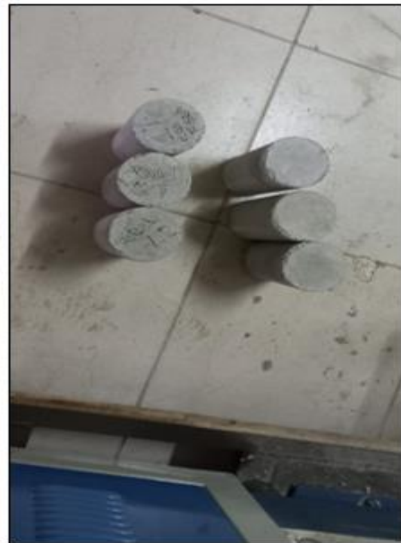
Elaboración de probetas de concreto modificado – F'c = 210 \text{ kg/cm}^2 con adición de fibras de acero.
