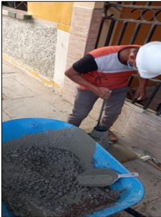
Elaboración de probetas con el concreto patrón – F'c = 210 \text{ kg/cm}^2 .
