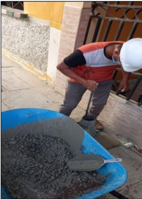
Elaboración de probetas con el concreto patrón – F'c = 210 \text{ kg/cm}^2 .
