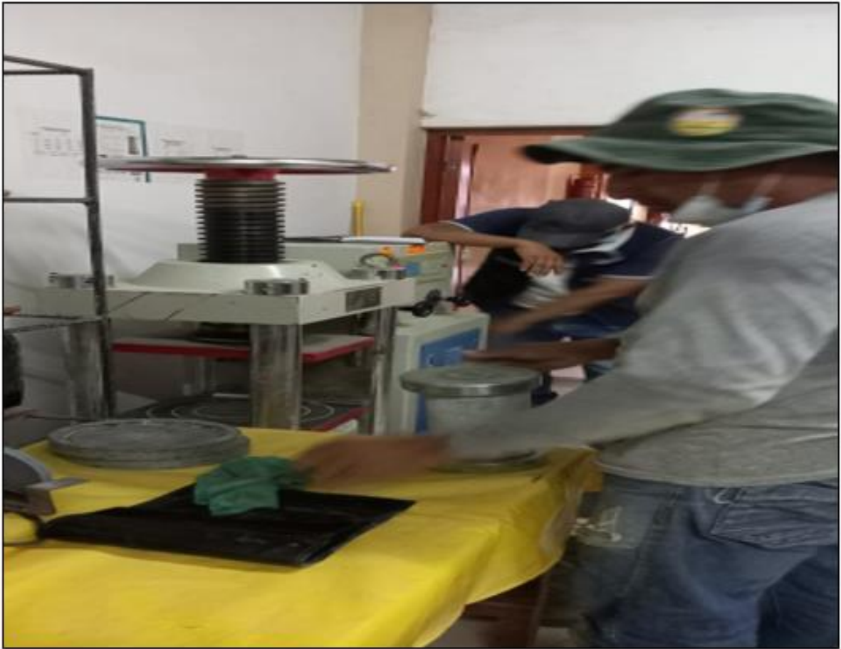
Ensayo de resistencia a la compresión de las probetas
