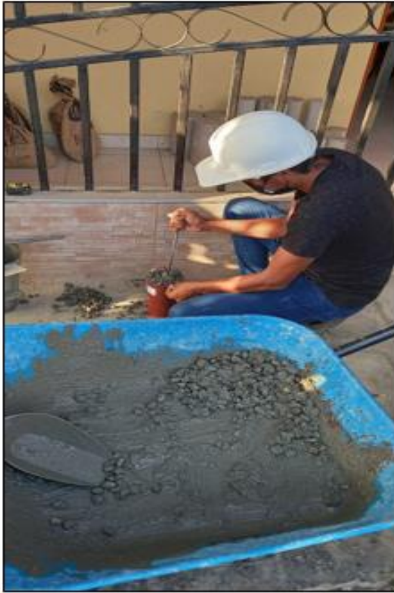
Elaboración de probetas de concreto modificado – F'c = 210 \text{ kg/cm}^2 con adición de fibras de acero.
