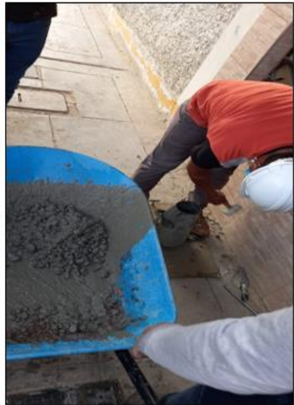
Elaboración de probetas con el concreto patrón – F'c = 210 \text{ kg/cm}^2 .
