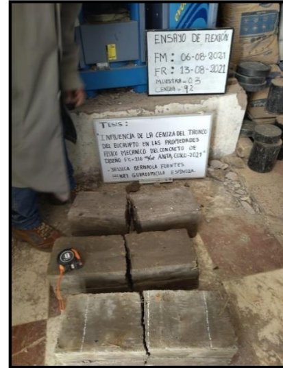
Figura N° 19: Vigas después del ensayo
