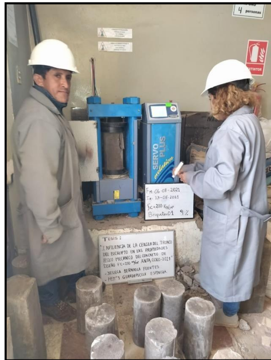
VISTA: TOMA DE DATOS DE ROTURA DE BRIQUETAS
