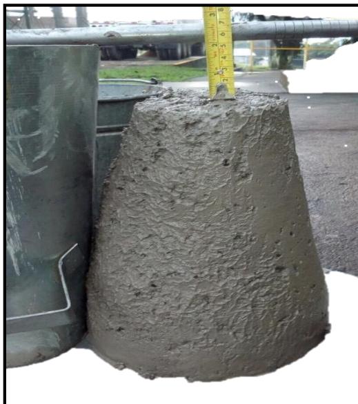
Figura Nº 20: Prueba de trabajabilidad del concreto (Slump)
