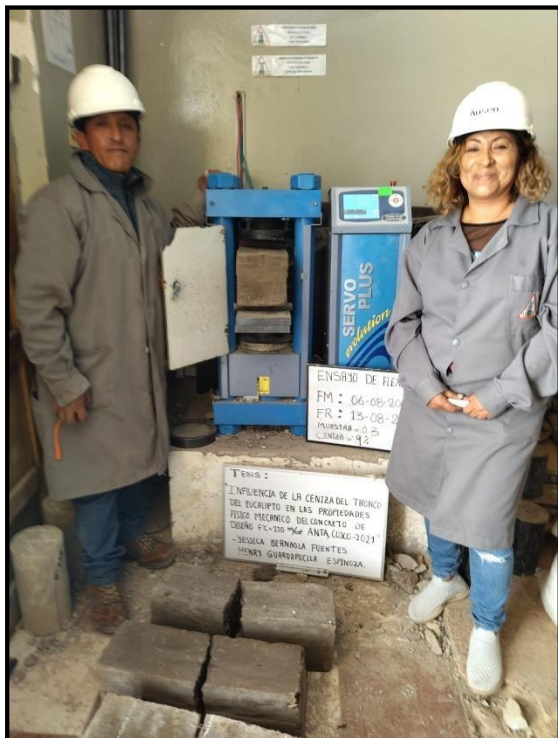
VISTA: PRUEBA DE FLEXIÓN EN VIGAS
