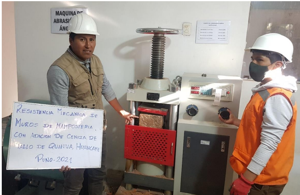
Figura 7.5: Ensayo de la resistencia a flexión por adherencia en pilas con ladrillos artesanales
