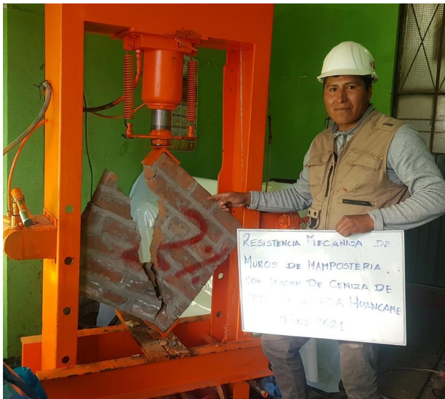
Figura 7.6: Ensayo de resistencia a corte diagonal en muretes con ladrillo artesanal
