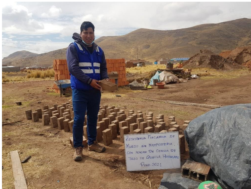
Figura 7.2: Elaboración de ladrillos artesanales con incorporación de tallo de quinua
