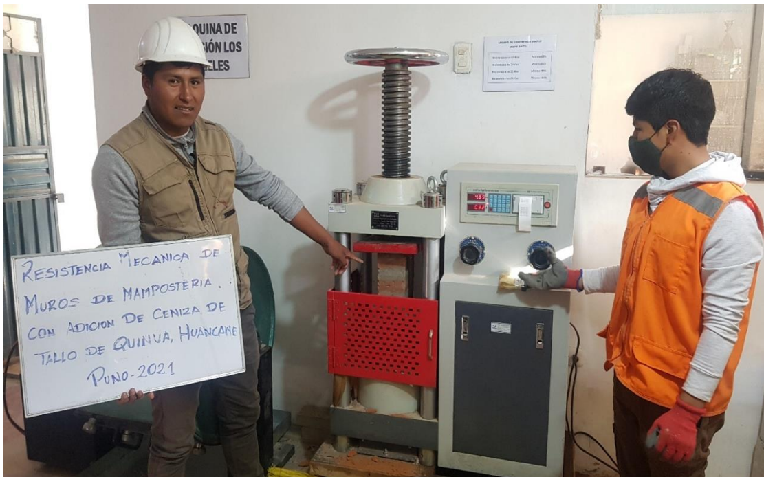
Figura 7.4: Ensayo de la resistencia a compresión axial en pilas con ladrillos artesanales
