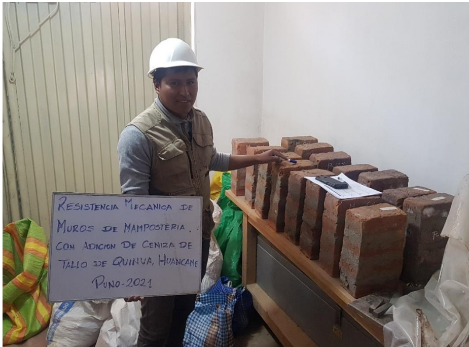
Figura 7.3: Elaboración de muros y pilas con ladrillos artesanales
