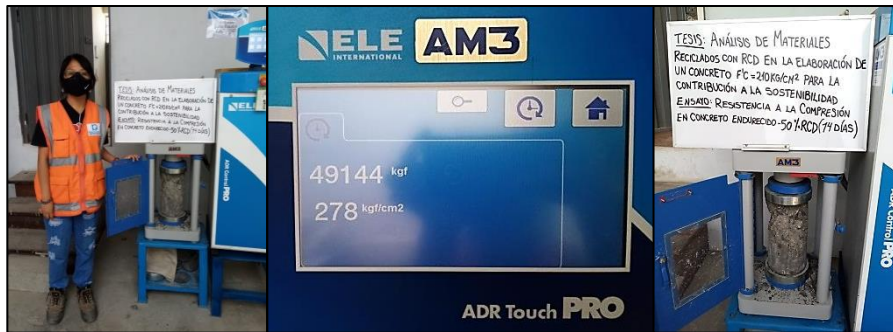
Figura 35. Rotura de probetas de concreto 50% RCD (14 días)
