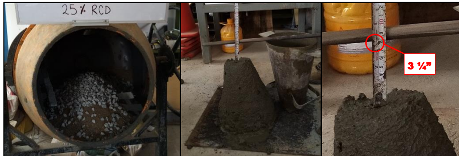
Figura 24. Ejecución de mezcla (25% RCD) y Slump Test Fuente: Propia
