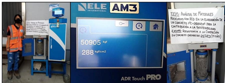
Figura 34. Rotura de probetas de concreto 25% RCD (14 días) Fuente: Propia
