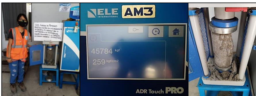
Figura 30. Rotura de probetas de concreto 25% RCD (7 días) Fuente: Propia
