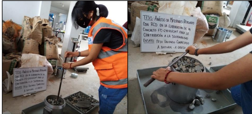
Figura 17. Chuseado y enrasado de agregado grueso natural seco
