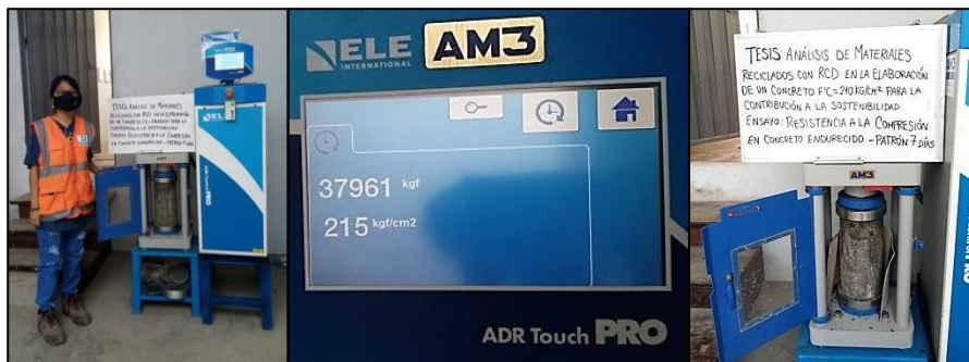
Figura 29. Rotura de probetas de concreto Patrón (7 días) Fuente: Propia
