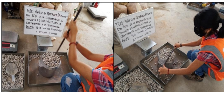
Figura 19. Chuseado y enrasado de agregado grueso reciclado seco
