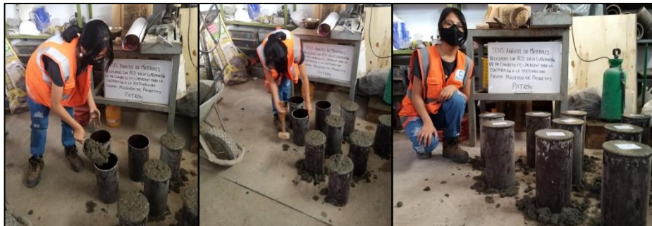
Figura 27. Vaciado de concreto en probetas cilíndricas Fuente: Propia
