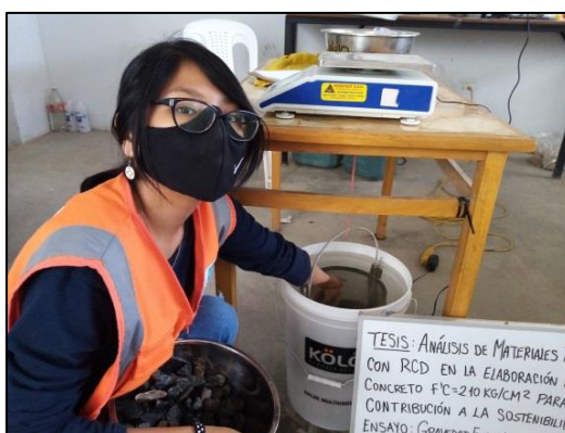
Figura 21. Muestra sumergida SSS en agua
