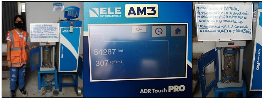
Figura 38. Rotura de probetas de concreto 25% RCD (28 días)
