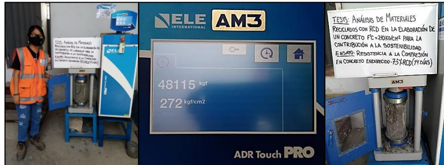
Figura 36. Rotura de probetas de concreto 75% RCD (14 días)
