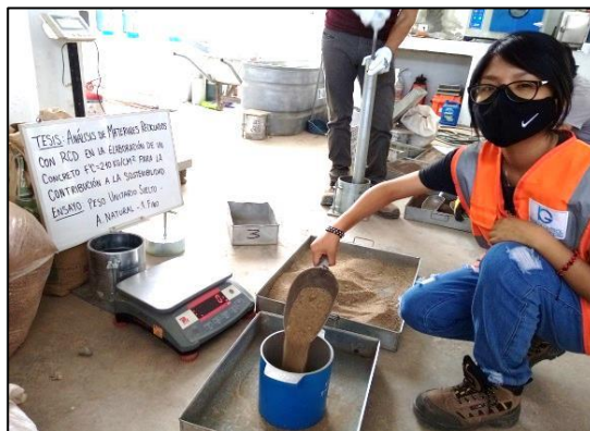
Figura 14. Colocación del agregado fino natural seco Fuente: Propia
