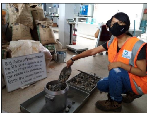
Figura 16. Colocación del agregado grueso natural seco
