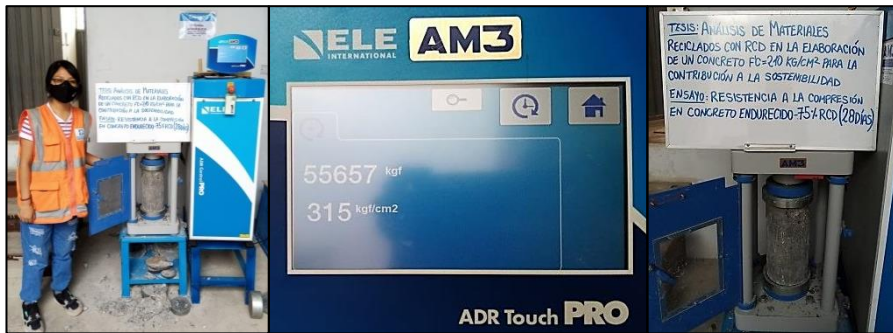
Figura 40. Rotura de probetas de concreto 75% RCD (28 días)
