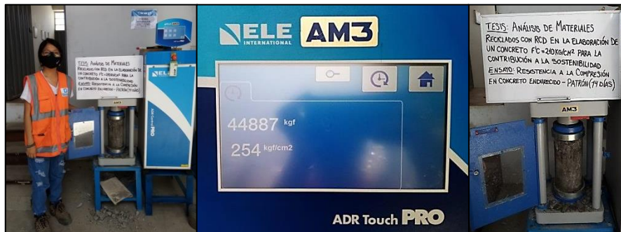
Figura 33. Rotura de probetas de concreto Patrón (14 días) Fuente: Propia
