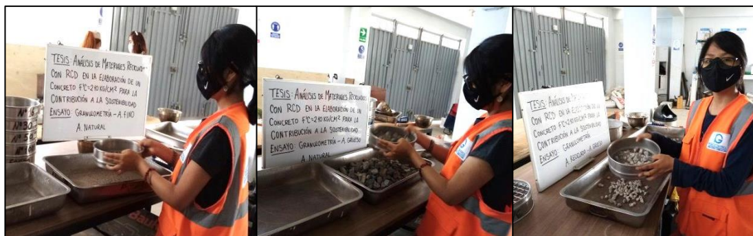
Figura 13. Tamizado de los agregados naturales y reciclado Fuente: Propia
