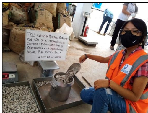
Figura 18. Colocación del agregado grueso reciclado seco
