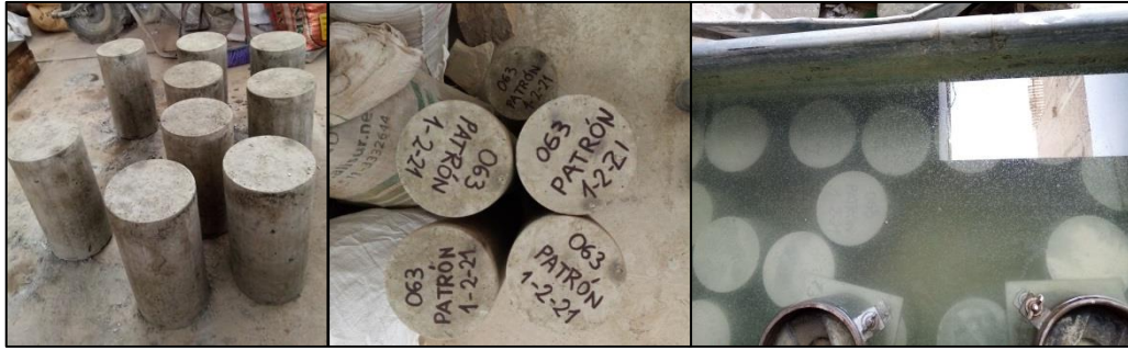
Figura 28. Traslado de probetas al tanque de curados de concreto Fuente: Propia
