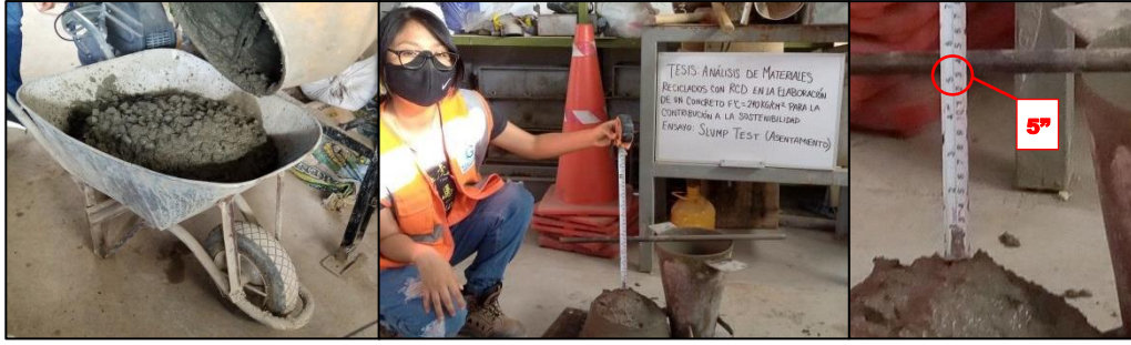
Figura 23. Ejecución de mezcla patrón y Slump Test Fuente: Propia
