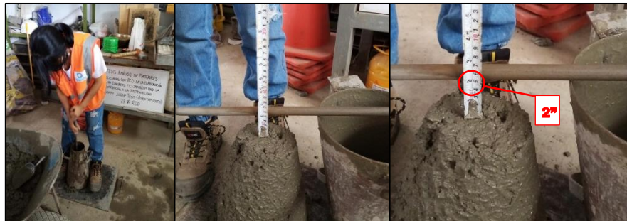
Figura 26. Ejecución de mezcla (75% RCD) y Slump Test Fuente: Propia
