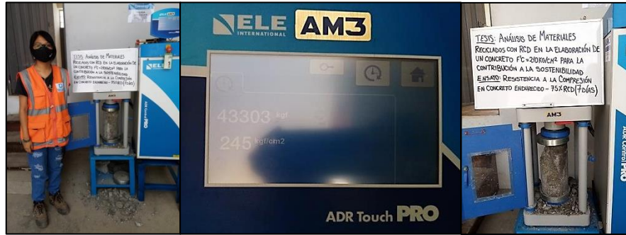
Figura 32. Rotura de probetas de concreto 75% RCD (7 días) Fuente: Propia
