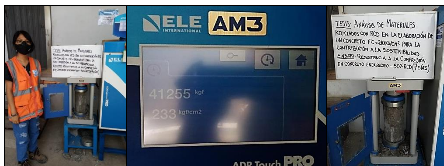
Figura 31. Rotura de probetas de concreto 50% RCD (7 días) Fuente: Propia
