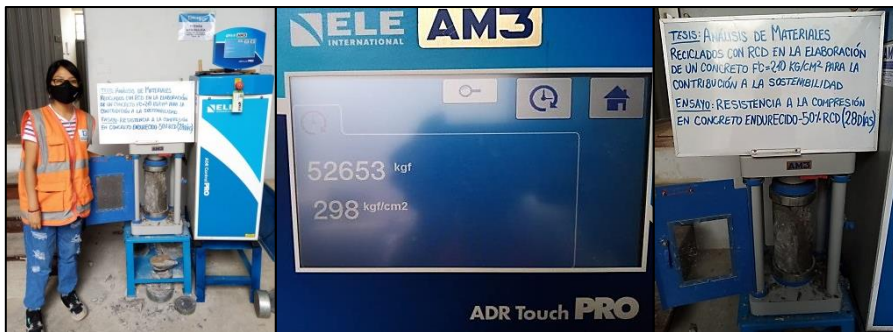
Figura 39. Rotura de probetas de concreto 50% RCD (28 días)
