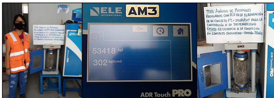
Figura 37. Rotura de probetas de concreto Patrón (28 días)
