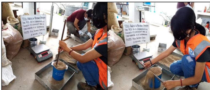
Figura 15. Chuseado y enrasado de agregado fino natural seco
