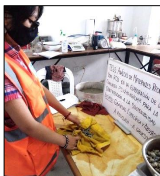
Figura 22. Muestra saturada superficialmente seca (SSS)
