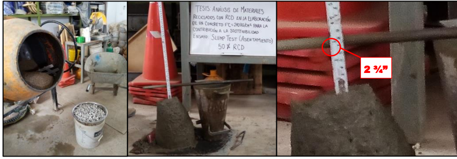
Figura 25. Ejecución de mezcla (50% RCD) y Slump Test Fuente: Propia
