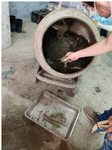
Foto N°37: Problemas que se presentaron antes de los ensayos, que fue en la parte de trabajabilidad que se trabajó con un 2% de fibra
