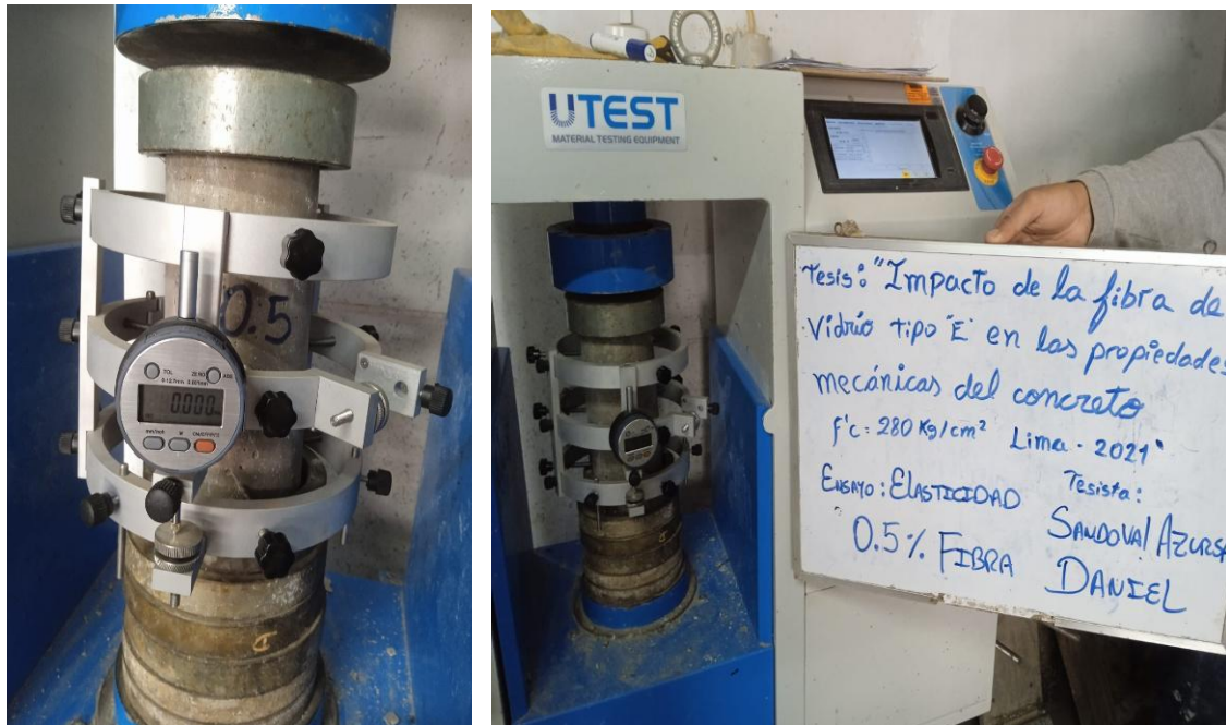
Foto N°35: Ensayo de módulo de elasticidad a los 28 días de curado para el 0.50% de fibra de vidrio
