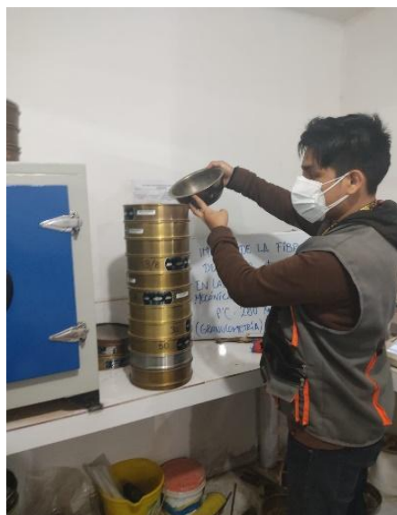
Foto N°01: Adición de los agregados en las diversas dimensiones de tamizados para conocer la curva granulométrica.
