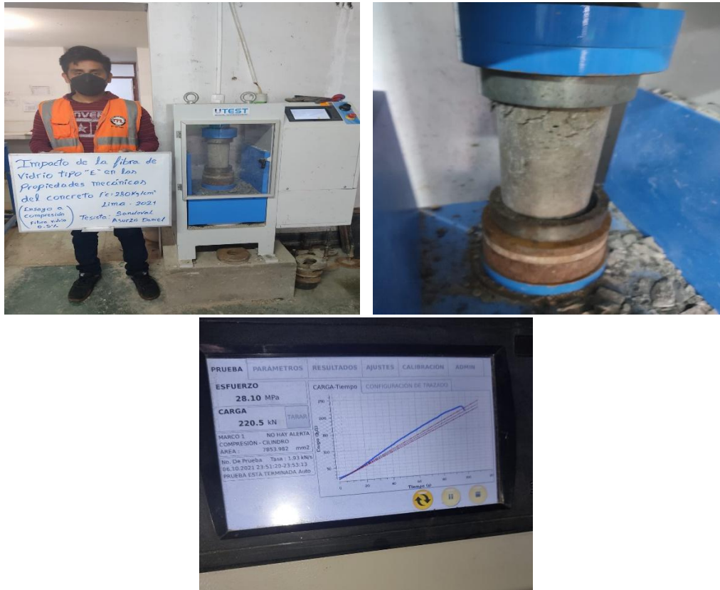
Foto N°22: Ensayo a compresión a los 7 días de curado para 0.50% de fibra
