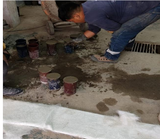
Foto N°16: Colocación de la mezcla a la probetas y 25 golpes por cada capa del concreto patrón, 0.20%, 0.50% y 0.80% de fibra
