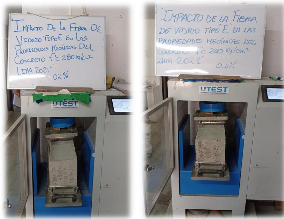
Figura N° 17: Lectura de la Resistencia de la viga patrón y adición de fibra hasta la presentación de la falla
