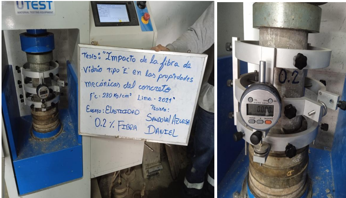
Foto N°34: Ensayo de módulo de elasticidad a los 28 días de curado para el 0.20% de fibra de vidrio
