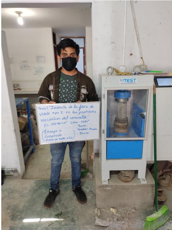
Foto N°28: Ensayo a compresión a los 28 días de curado para 0.50% de fibra
