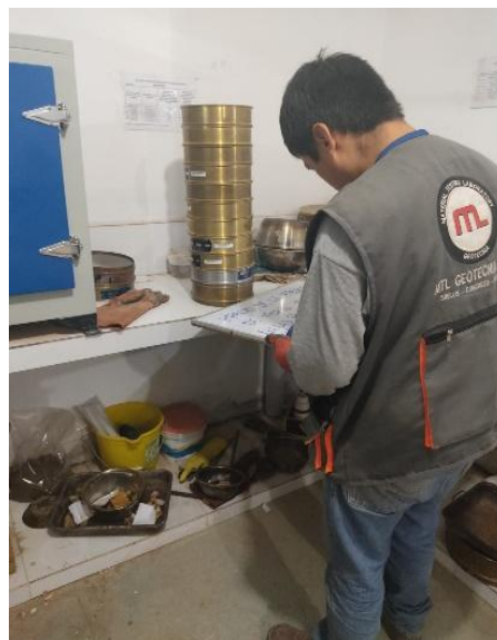
Foto N°02: Anotación de los datos de la cantidad de agregado que paso en los tamices.
