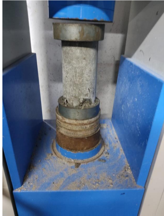
Foto N°26: Ensayo a compresión a los 14 días de curado para 0.80% de fibra
