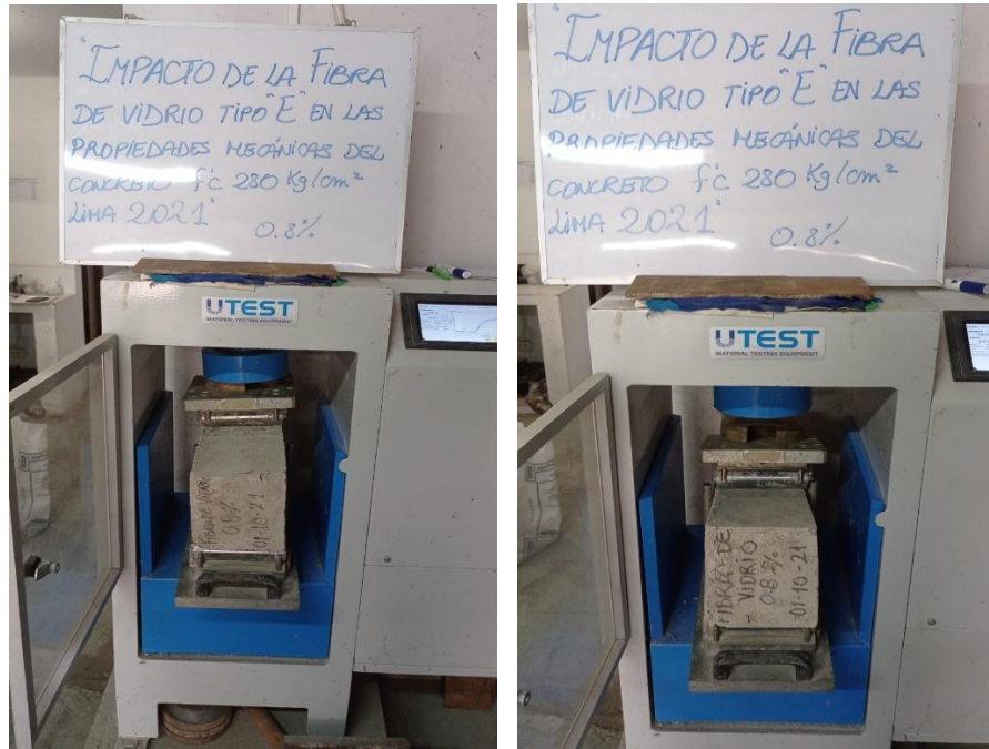
Foto N°32: Ensayo a flexión de las dos muestras a los 28 días de curado para 0.80% de fibra
