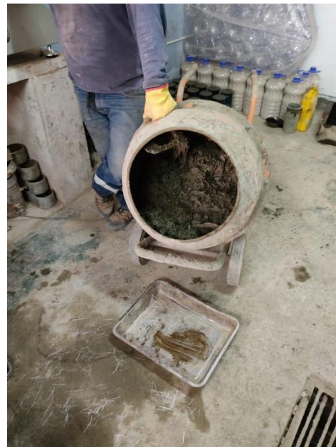
Foto N°37: Problemas que se presentaron antes de los ensayos, que fue en la parte de trabajabilidad que se trabajó con un 2% de fibra
