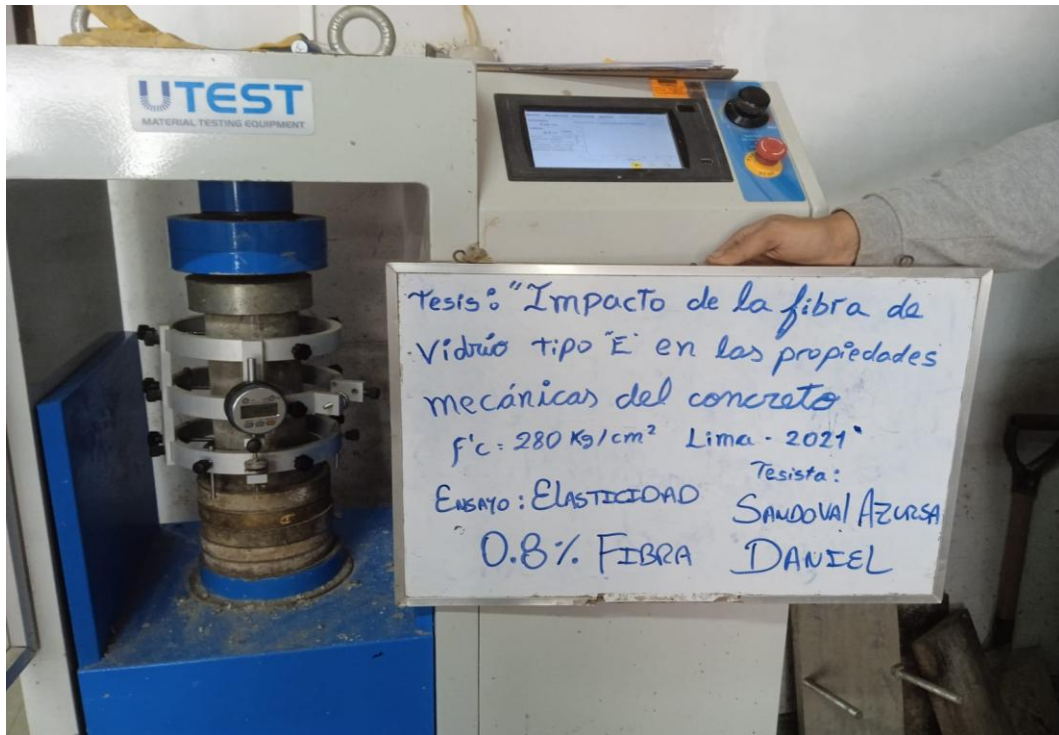
Foto N°36: Ensayo de módulo de elasticidad a los 28 días de curado para el 0.80% de fibra de vidrio
