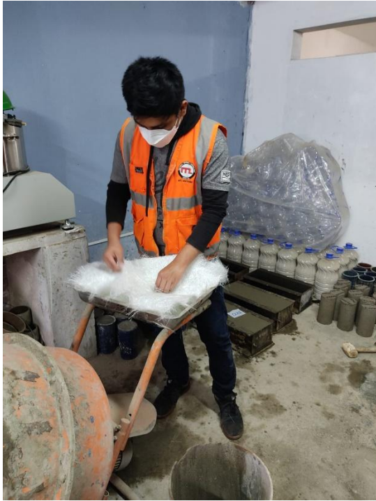
Foto N°07: Deshilachado de la fibra de vidrio para una mejor proporción
