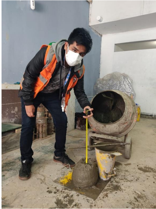
Foto N°12: Prueba de asentamiento del concreto patrón para un f'c=280\text{kg/cm}^2
