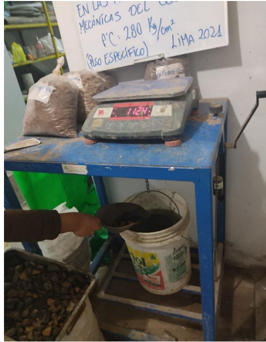
Foto N°05: Peso Específico y Absorción del agregado grueso
