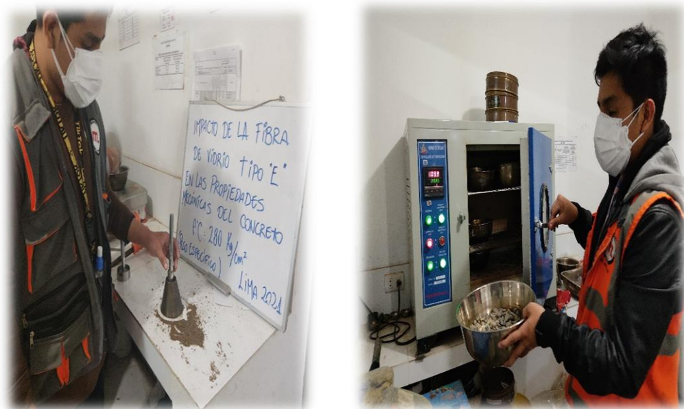
Figura N° 14: Verificación de la humedad en un molde cónico y llevarlo al horno
