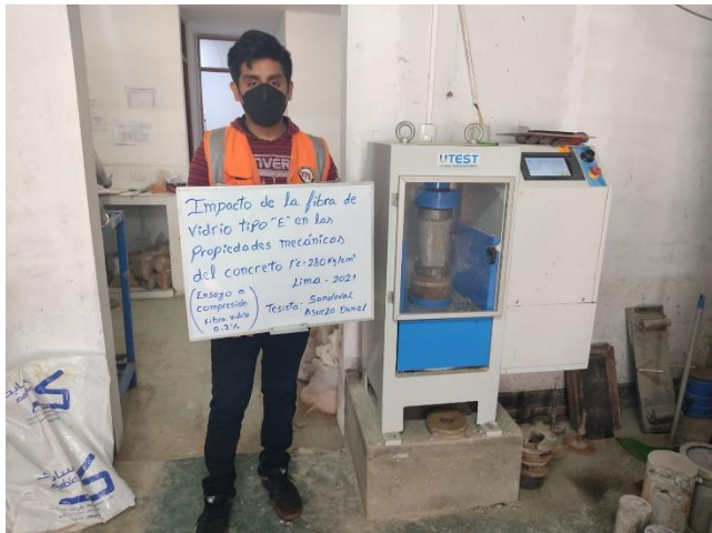
Foto N°21: Ensayo a compresión a los 7 días de curado para 0.20% de fibra
