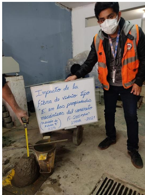
Foto N°13: Prueba de asentamiento del concreto 0.20% de fibra de vidrio para un f'c=280\text{kg/cm}^2
