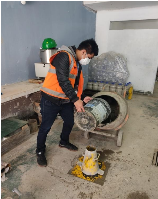
Foto N°11: Adición de los elementos que conforma el concreto, incluyendo la fibra de vidrio
