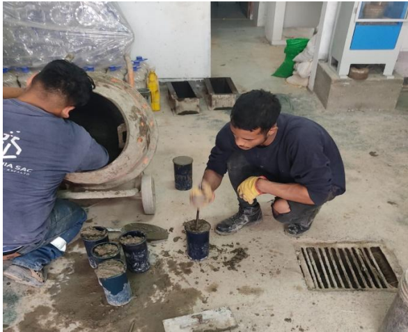
Foto N°16: Colocación de la mezcla a la probetas y 25 golpes por cada capa del concreto patrón, 0.20%, 0.50% y 0.80% de fibra
