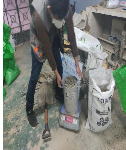
Foto N°03: Peso Unitario de los agregados
