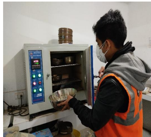
Foto N°04: Peso Específico y Absorción del agregado fino
