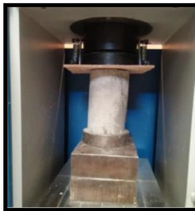
Figura N° 5 Ensayo a Compresión
