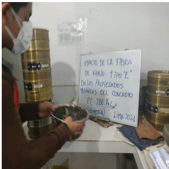
Foto N°01: Adición de los agregados en las diversas dimensiones de tamizados para conocer la curva granulométrica.
