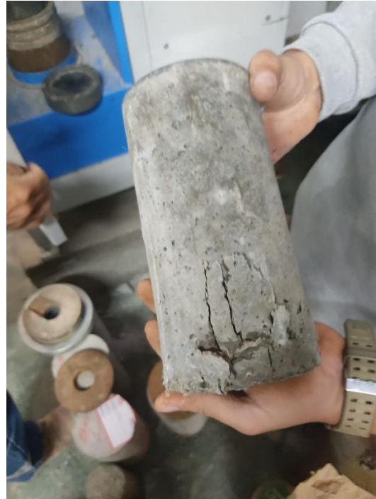
Foto N°24: Ensayo a compresión a los 14 días de curado para 0.20% de fibra
