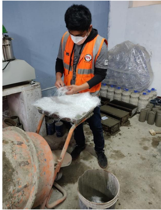
Foto N°07: Deshilachado de la fibra de vidrio para una mejor proporción
