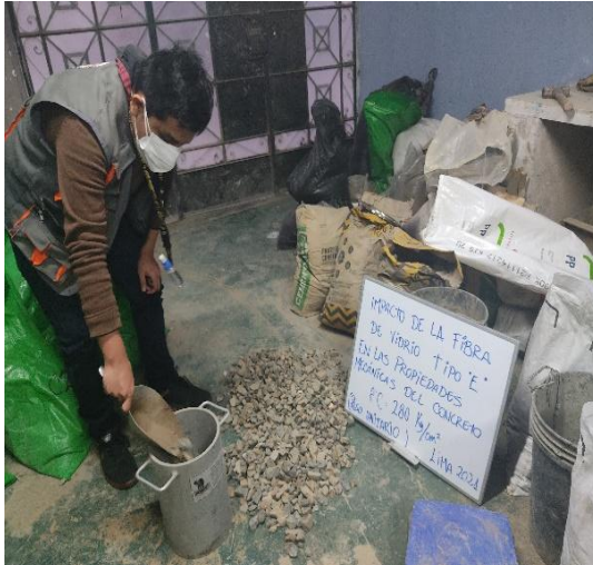
Foto N°03: Peso Unitario de los agregados
