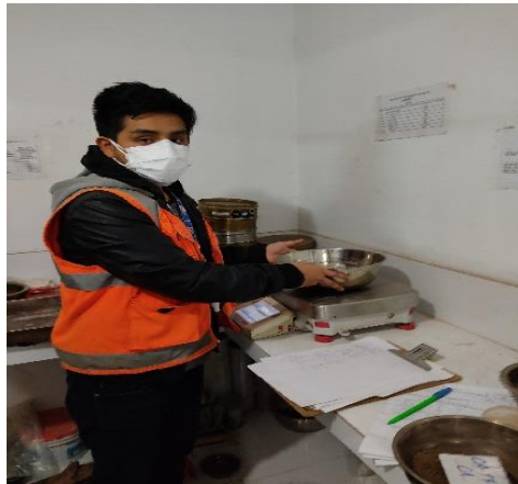
Foto N°04: Peso Específico y Absorción del agregado fino
