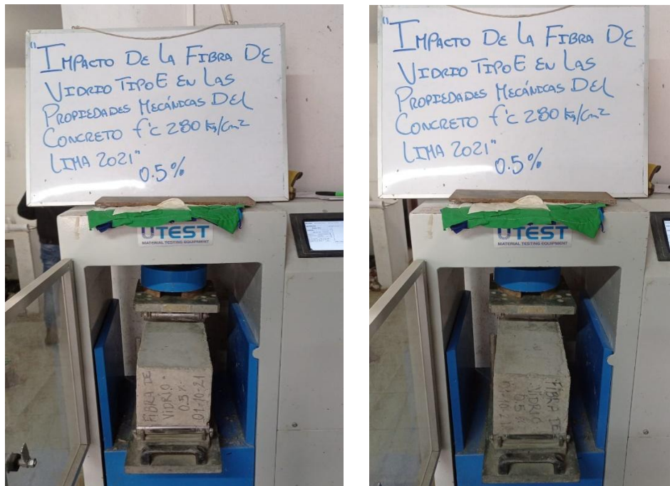
Foto N°31: Ensayo a flexión de las dos muestras a los 28 días de curado para 0.50% de fibra
