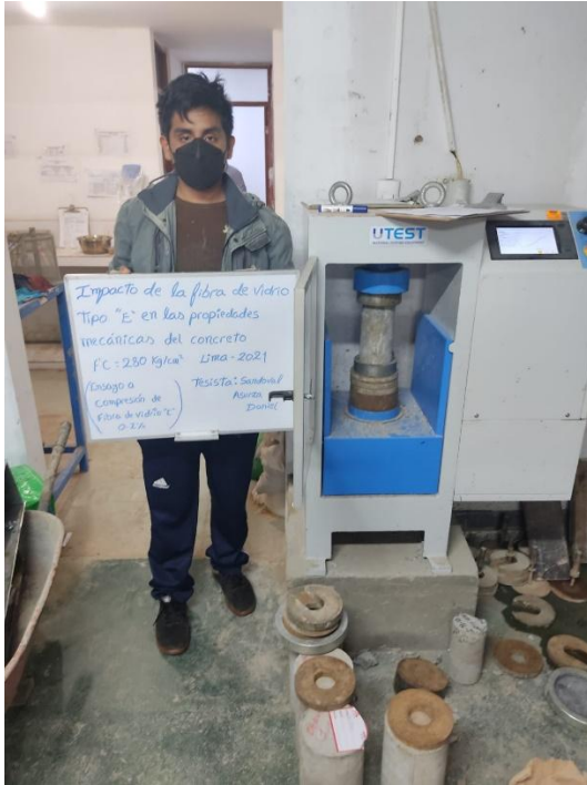
Foto N°24: Ensayo a compresión a los 14 días de curado para 0.20% de fibra
