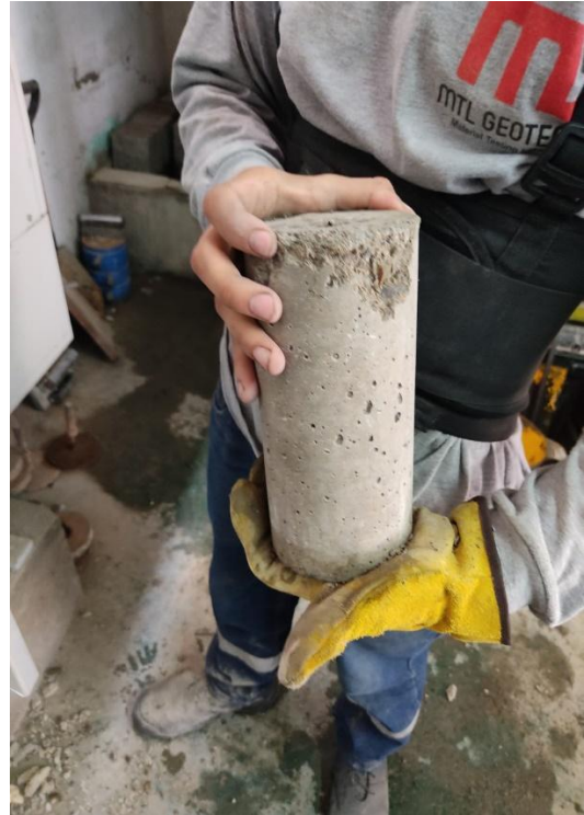
Foto N°28: Ensayo a compresión a los 28 días de curado para 0.50% de fibra
