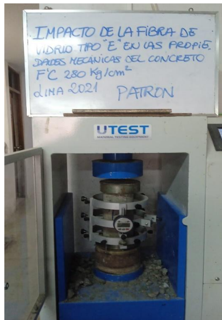
Foto N°33: Ensayo de módulo de elasticidad a los 28 días de curado para el concreto patrón
