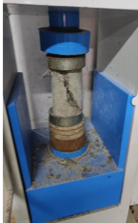
Foto N°25: Ensayo a compresión a los 14 días de curado para 0.50% de fibra
