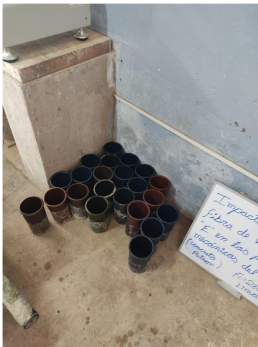
Foto N°8: Moldes para los ensayos de Compresión, flexión y M.R.
