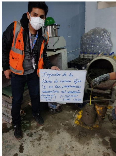
Foto N°15: Prueba de asentamiento del concreto 0.80% de fibra de vidrio para un f'c=280\text{kg/cm}^2
