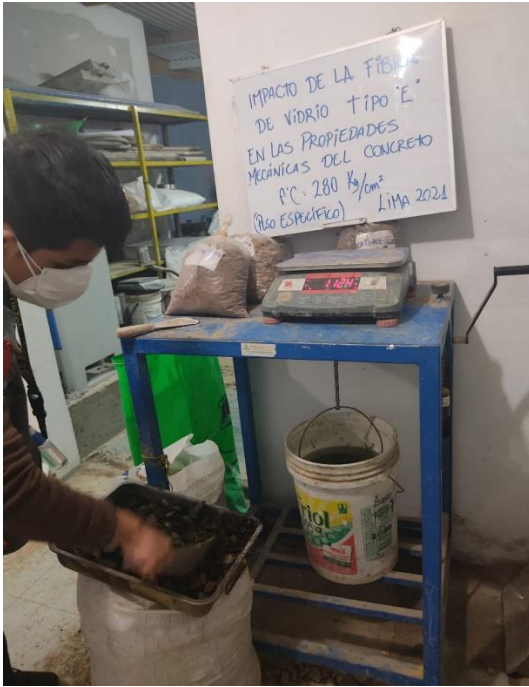
Foto N°05: Peso Específico y Absorción del agregado grueso
