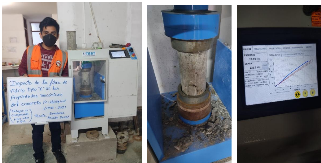
Foto N°23: Ensayo a compresión a los 7 días de curado para 0.80% de fibra
