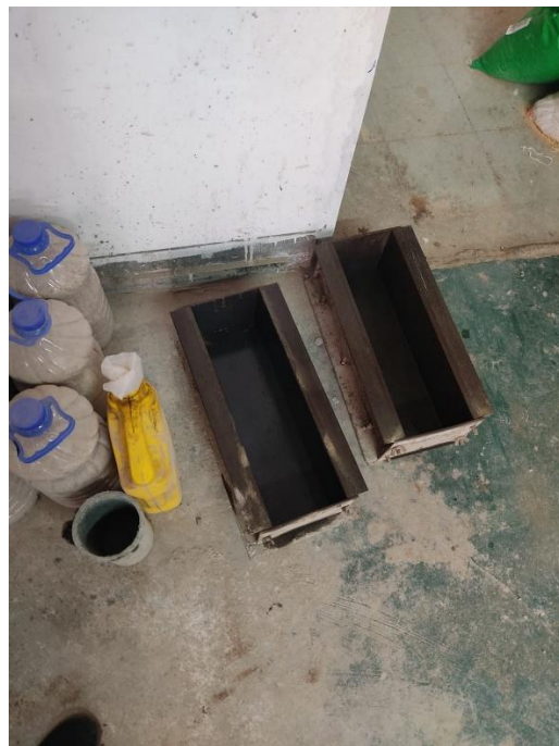
Foto N°8: Moldes para los ensayos de Compresión, flexión y M.R.
