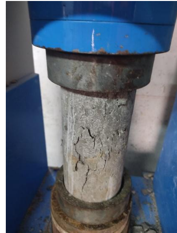
Foto N°21: Ensayo a compresión a los 7 días de curado para 0.20% de fibra
