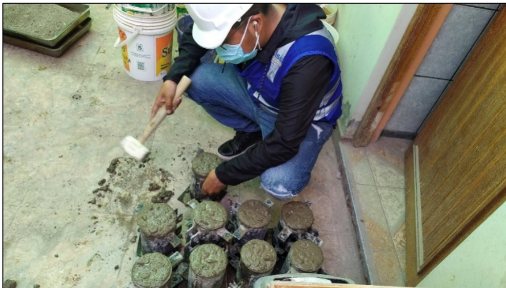
Figura 19. Preparación de especímenes cilíndricos de concreto. Fuente: elaboración propia.
