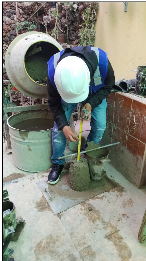
Figura 20. Realización del ensayo de asentamiento. Fuente: Fotografía propia.
