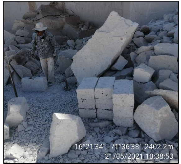
Figura 9. Fabricación de bloques de sillar para tabiquería.
