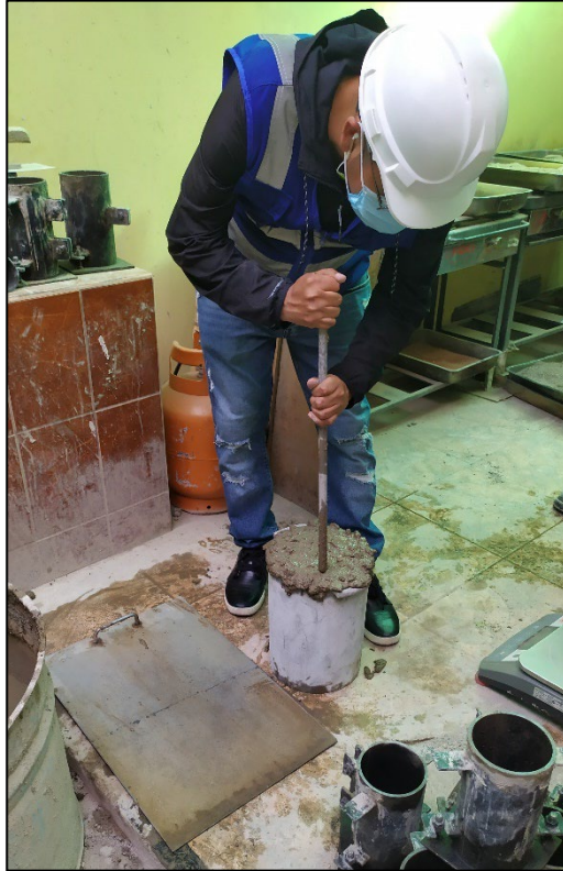
Figura 23. Ejecución del ensayo de p. unitario en el concreto fresco. Fuente: Fotografía propia
