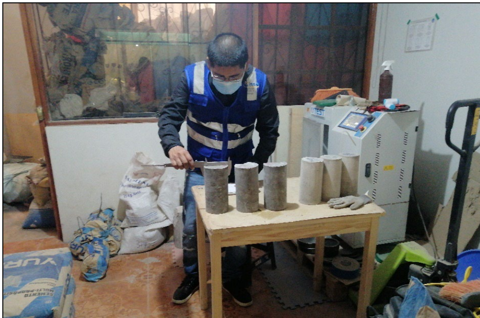
Figura 26. Toma de medidas de las probetas cilíndricas con vernier. Fuente: Fotografía propia.
