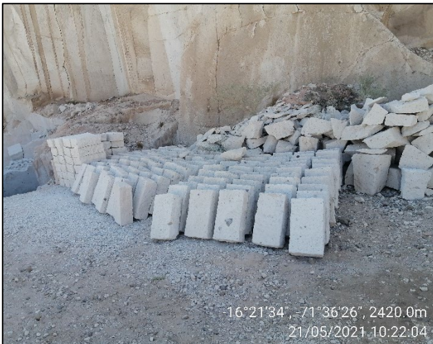
Figura 10. Bloques de tabiquería de sillar terminados.
