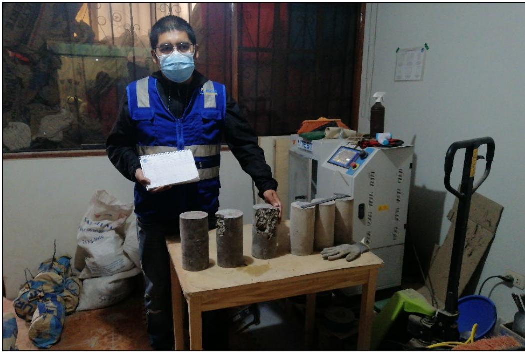
Figura 27. Realización de rotura de probetas. Fuente: Fotografía propia.
