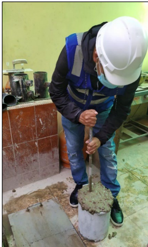
Figura 24. Ejecución del ensayo de p. unitario en el concreto fresco. Fuente: Fotografía propia.
