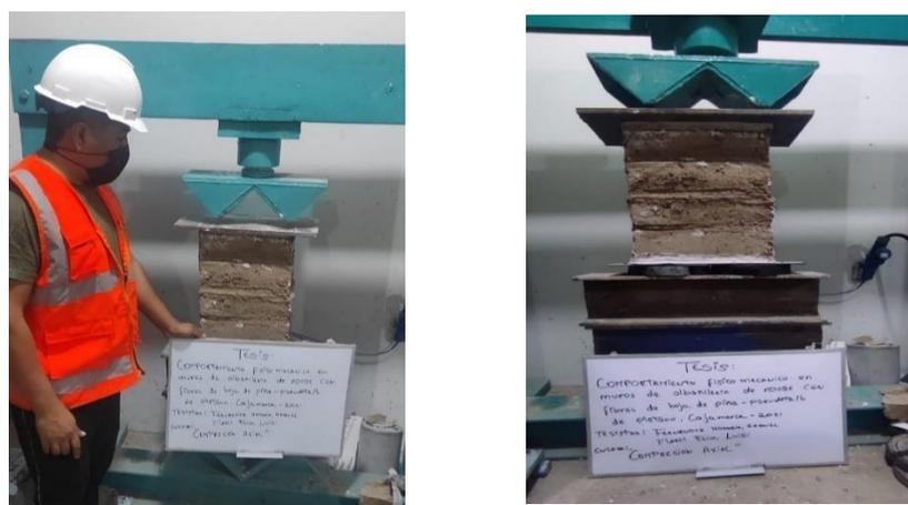
**Figura 86.** Ensayo de resistencia del murete (pilas) a la compresión en laboratorio (Elaboración propia)
