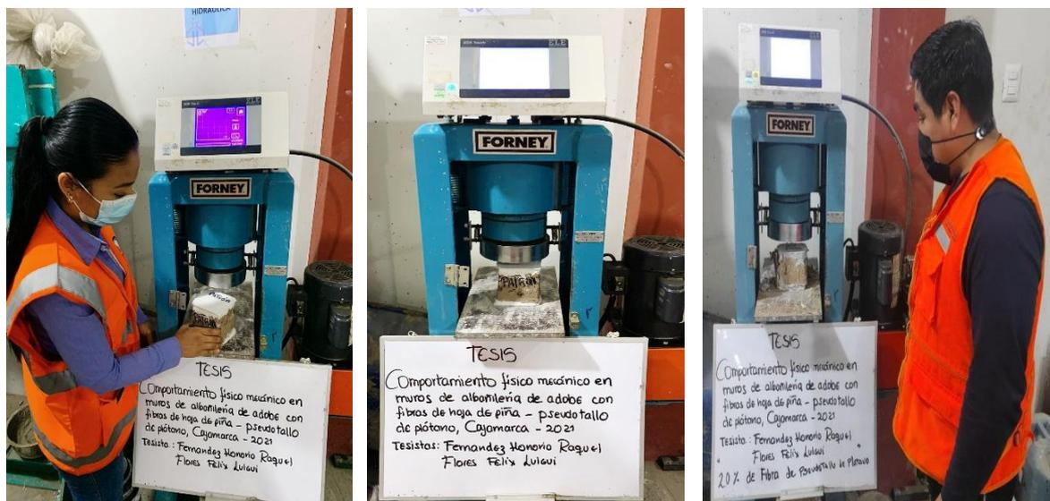
Figura 78. Ensayo de resistencia a la compresión en laboratorio (Elaboración propia)
