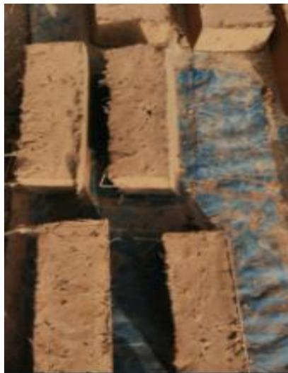
**Figura 55.** Colocar de canto para su secado similar (Elaboración Propia)
