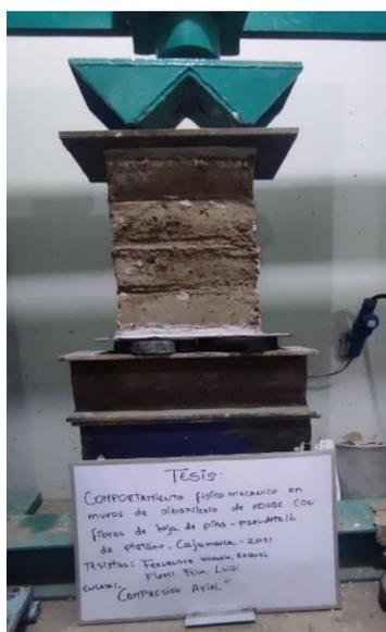
**Figura 57.** Ensayo de compresión a las pilas (Elaboración Propia)
