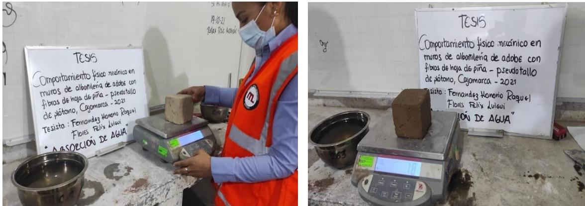
**Figura 73.** Procedimiento para medir la absorción en las unidades de adobe (Elaboración propia)
