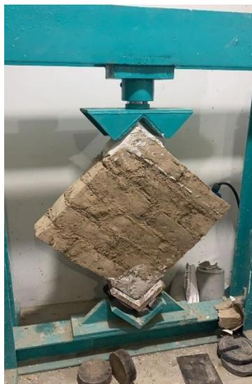
**Figura 56.** Ensayo de compresión diagonal (Elaboración Propia)
