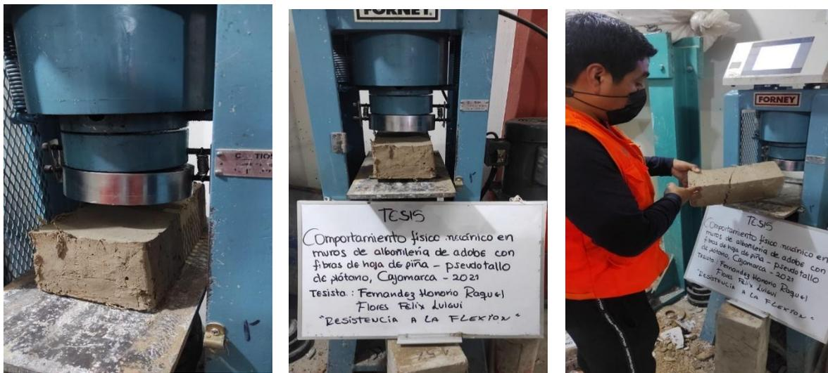
Figura 83. Ensayo de resistencia a la flexión en laboratorio (Elaboración propia)
