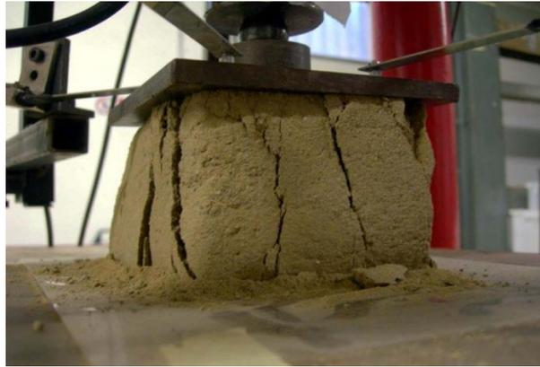
**Figura 4.** Ensayo de compresión
