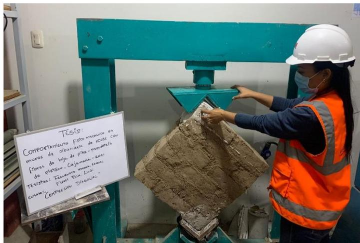
**Figura 89.** Ensayo de resistencia diagonal del murete en laboratorio (Elaboración propia)
