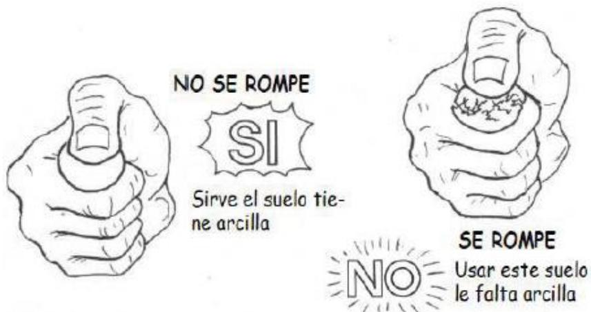
**Figura 23.** Prueba de "Resistencia seca" - Presión de las esferas con dedo índice y pulgar (Norma Técnica E0-80, 2016)
