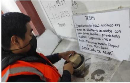
10. Pesando la muestra antes de ensayo de absorción
