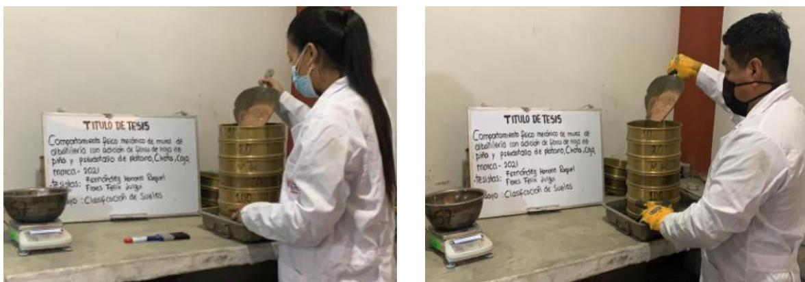
Figura 63. Ensayo de granulometría (Elaboración propia)
