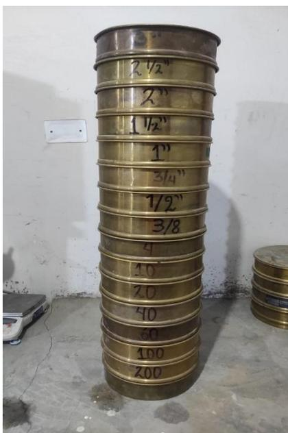
**Figura 49.** Análisis granulométrico por tamizado (Elaboración Propia)
