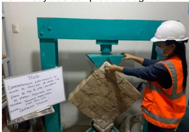
14. Ensayo de compresión axial
