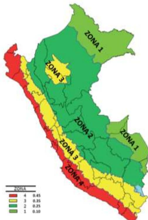
*Figura 3: Modelo Zona Sísmica*
