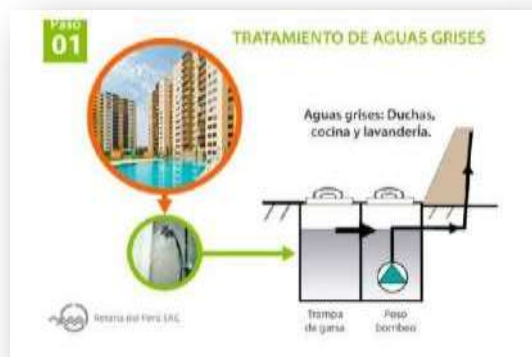
Figura 27. Tratamiento de aguas residuales.
