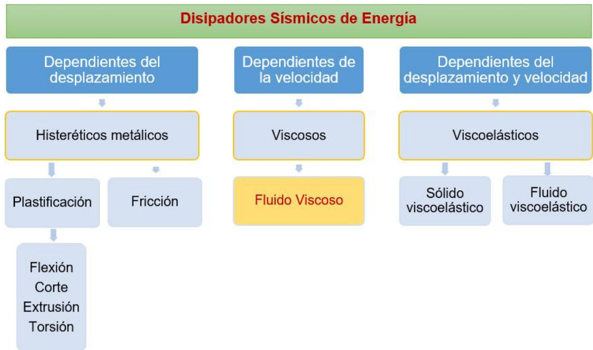
Figura 5. Categorización de los dispositivos que disipan energía
