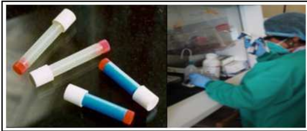
Figura 7 Análisis de muestras tomadas por método de tubos pasivos para el NO2
