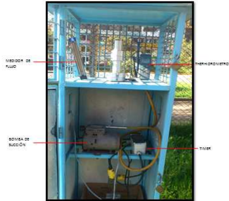
Figura 9 Equipo impactador harvard – Método activo para material particulado PM10
