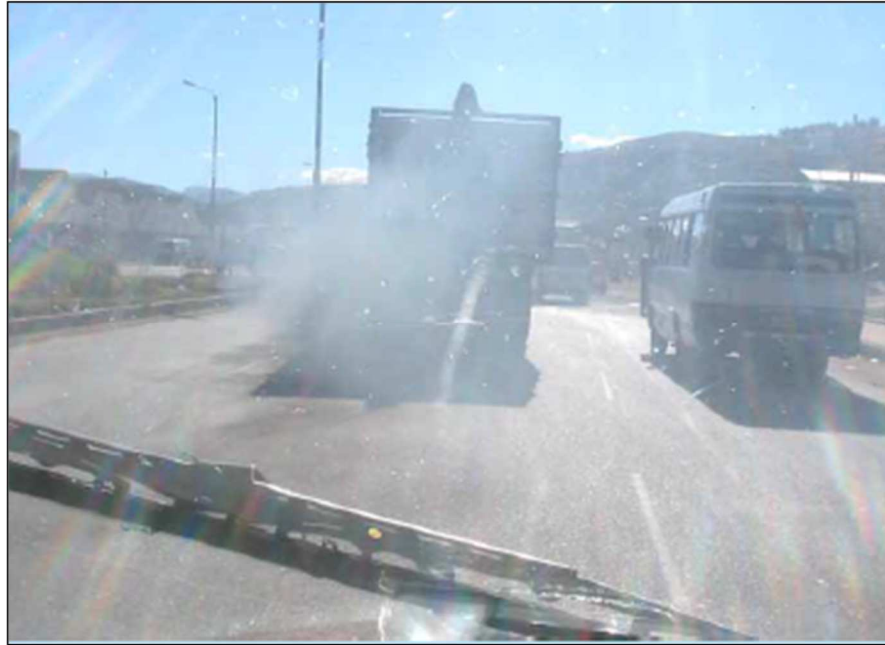
Figura 5 Emisión De Polvo Fugitivo Por Los Vehículos
