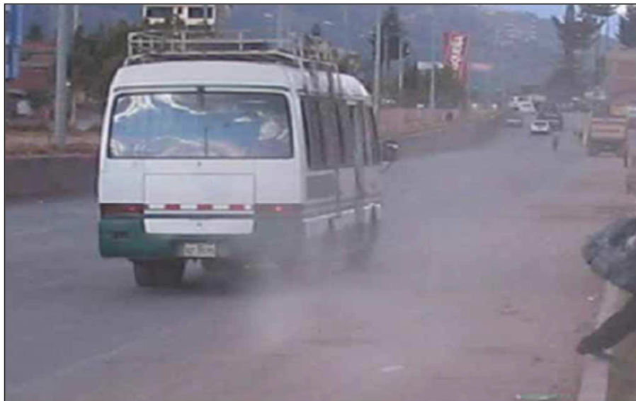
Figura 6 Emisión de CO, SOX, NOX, COV de combustión por los vehículos
