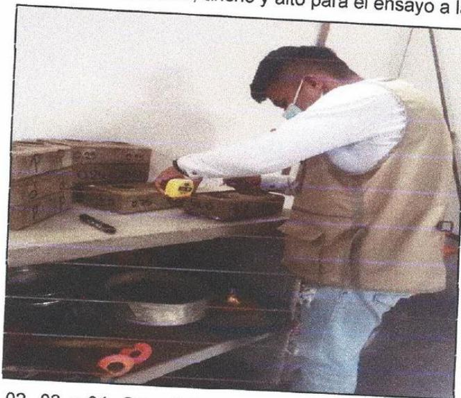
Fotografía N° 02, 03 y 04. Se señalo al ecoladrillo por la mitad para luego ser cortado para el ensayo a la resistencia a compresión.
