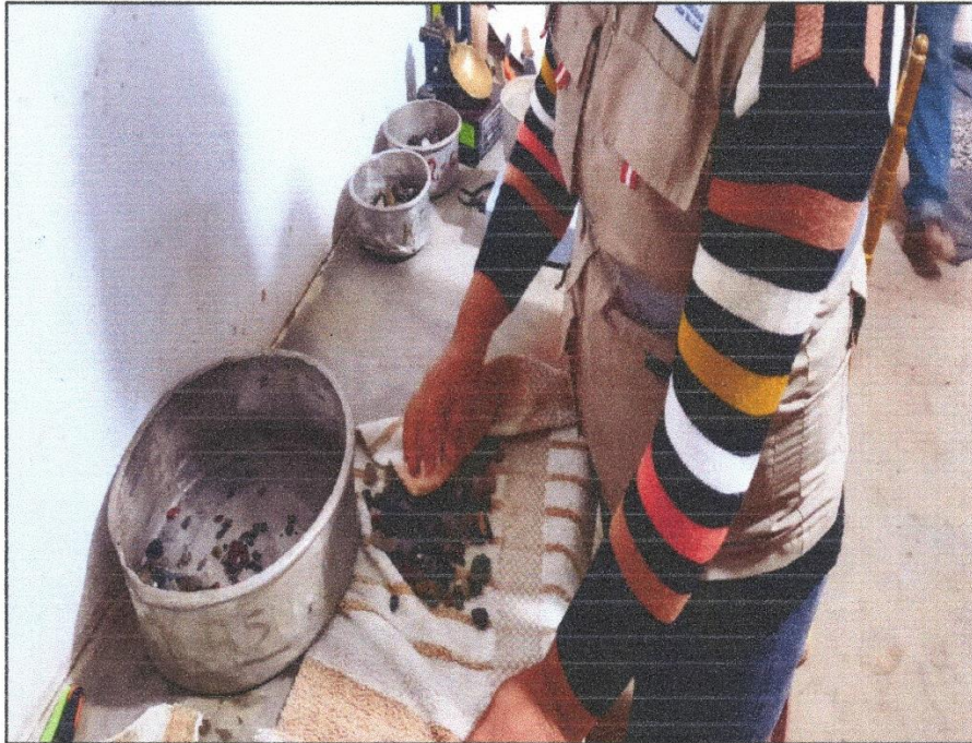
Realización de ensayo de porcentaje de absorción del agregado grueso (piedra chancada tamaño máximo ½" (peso específico) y absorción del agregado fino NTP 400.022 - 2013
