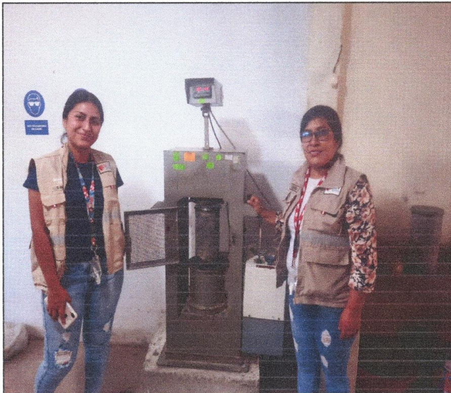
Realización de ensayo normalizado para la determinación de la resistencia a la compresión del concreto en muestras cilíndricas. NTP 339.034 - 2008
