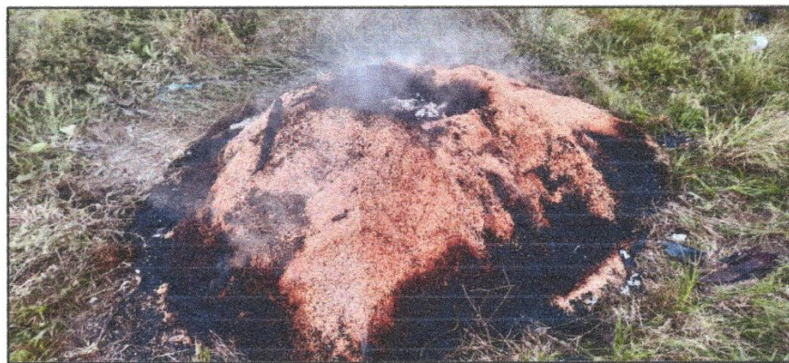
Proceso de calcinación de la cascarilla de arroz en un lugar abierto en la ciudad de Moyobamba
