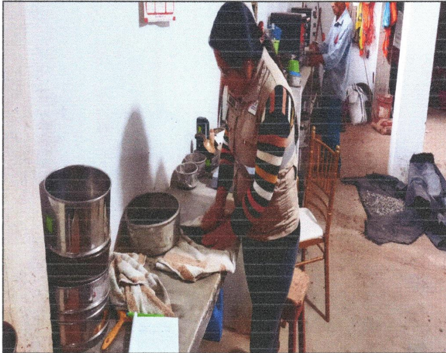
Realización de ensayo de porcentaje de absorción del agregado grueso (piedra chancada tamaño máximo \frac{1}{2} " (peso específico) y absorción del agregado fino NTP 400.022 - 2013
