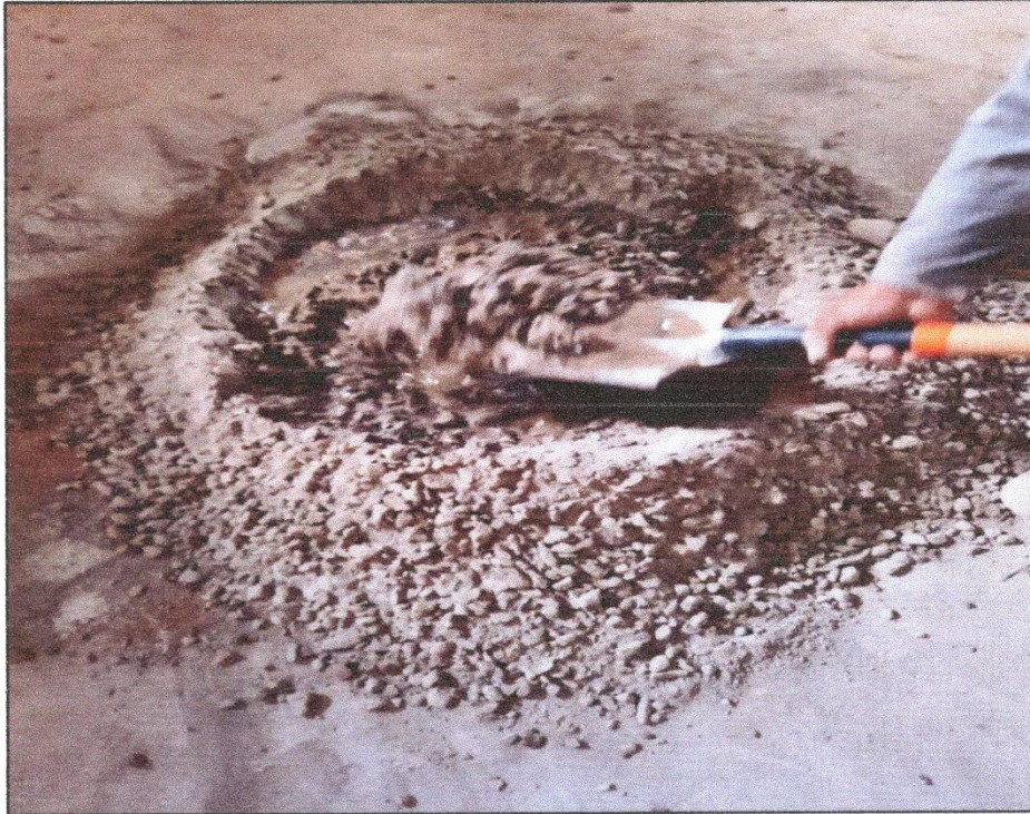
Realización de batido de concreto para la muestra patrón de cilindros de concreto
