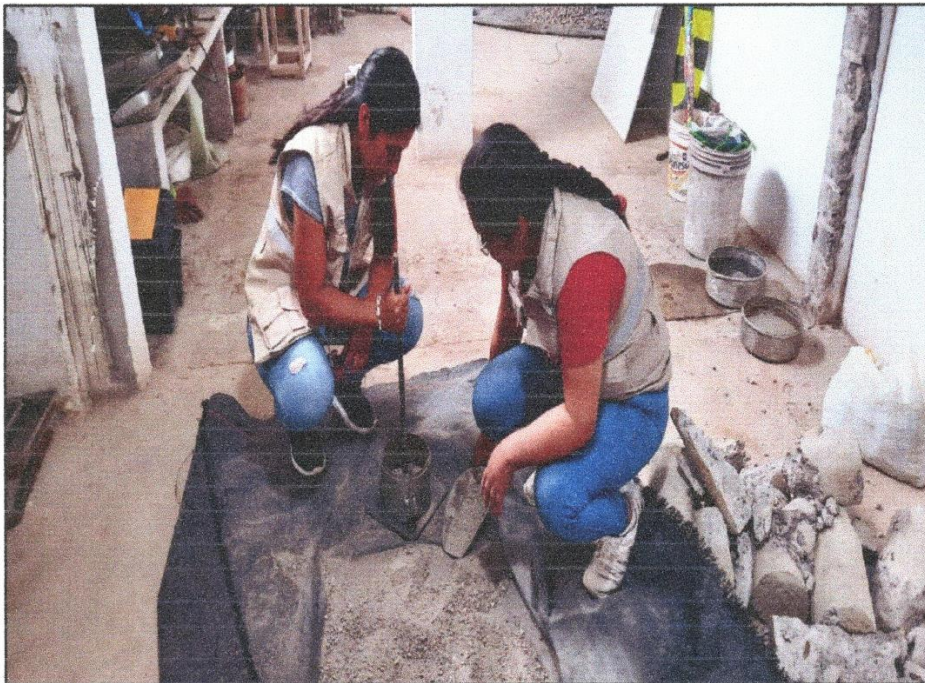
Realización de ensayo de peso volumétrico suelto y peso volumétrico compactado NTP-400.017-2011 (Agregados) Método de Ensayo Para Determinar El Peso Unitario Del Agregado
