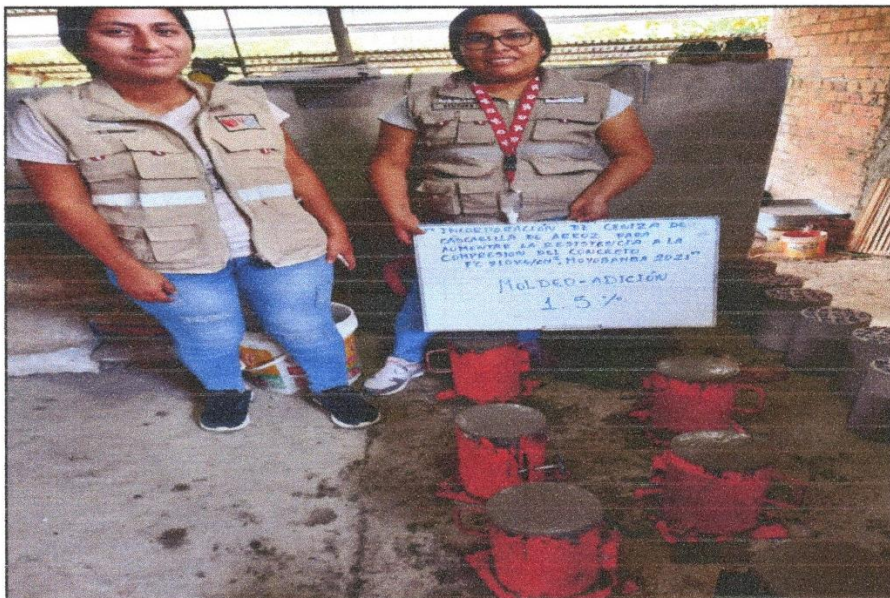
Realización de moldeo patrón de probetas de 15 x 30 cm – Hormigón concreto método de ensayo normalizado para la determinación de la resistencia a la compresión del concreto en muestras cilíndricas. NTP 339.034 – 2008
