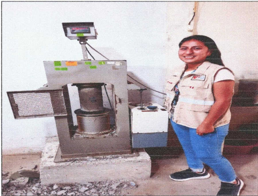
Realización de ensayo normalizado para la determinación de la resistencia a la compresión del concreto en muestras cilíndricas. NTP 339.034 - 2008
