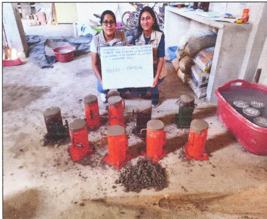
Realización de moldeo patrón de probetas de 15 x 30 cm – Hormigón concreto método de ensayo normalizado para la determinación de la resistencia a la compresión del concreto en muestras cilíndricas. NTP 339.034 - 2008
