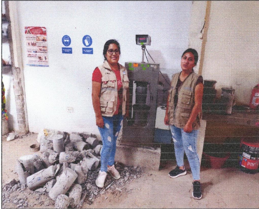
Realización de ensayo normalizado para la determinación de la resistencia a la compresión del concreto en muestras cilíndricas. NTP 339.034 - 2008
