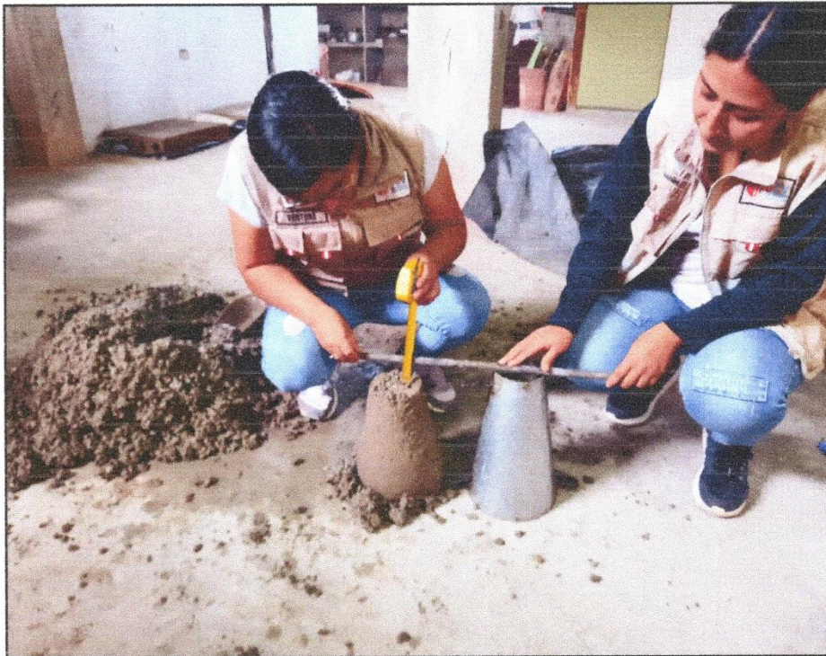
Realización de medición del ensayo de asentamiento "SLUMP" de 3" a 4" HORMIGÓN (CONCRETO). Método de ensayo para la medición del asentamiento del concreto de cemento Portland - NTP 339.035 – 2009.
