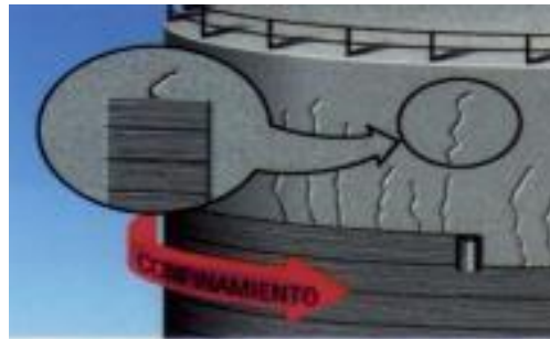
Figura 5 Reforzamiento estructural especial con láminas de fibra de carbono
