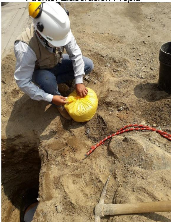
*Figura 10 Muestra para ensayo de granulometría por tamizado*
