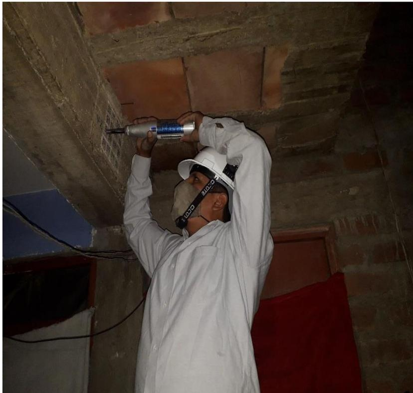
*Figura 28 Ensayo de esclerometría en viga peraltada*
