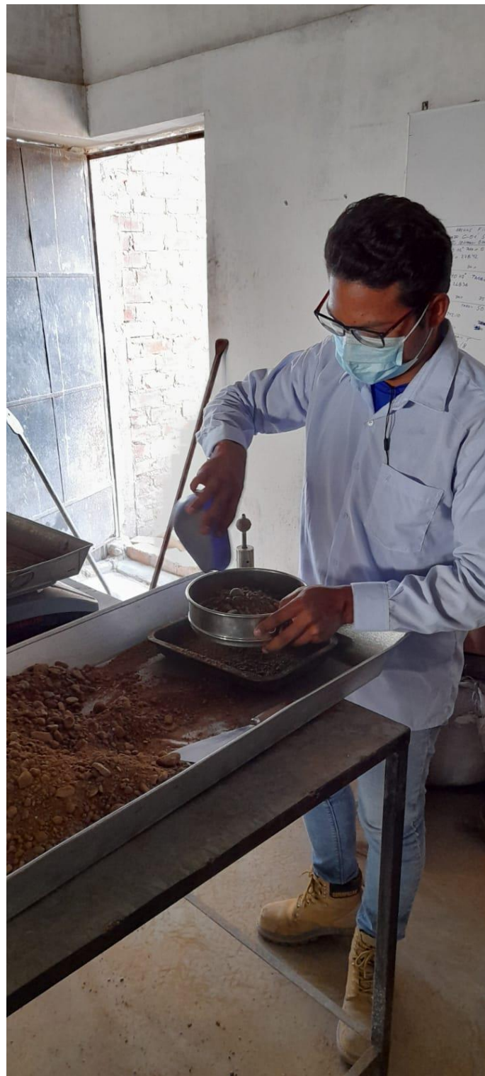
FOTO: TAMIZADO DE MATERIAL EXTRAIDO DE CALICATAS DEL JR. MARIANO DIAZ CON MALLA N° 04
