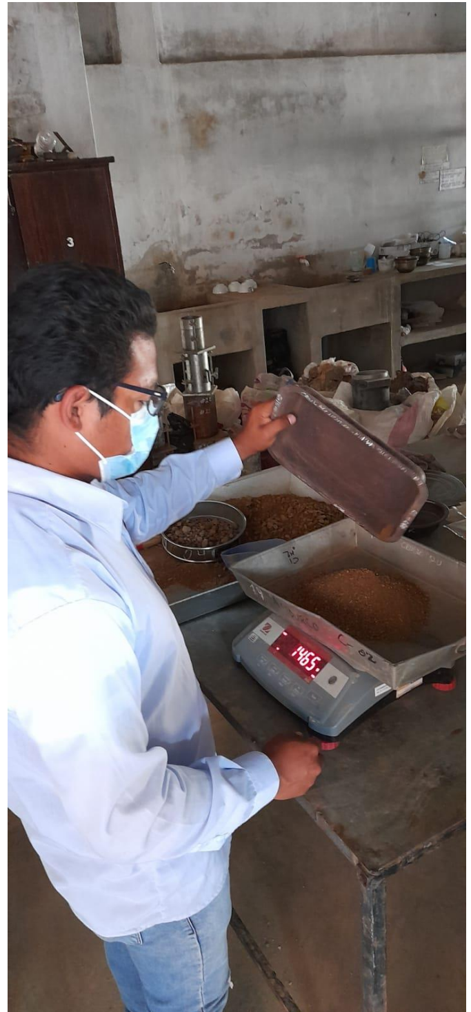
FOTO: PESADO Y ANOTACION DE MATERIAL EXTRAIDO DE CALICATAS LOS CUALES FUERON TAMIZADOS PREVIAMENTE CON MALLA N°04
