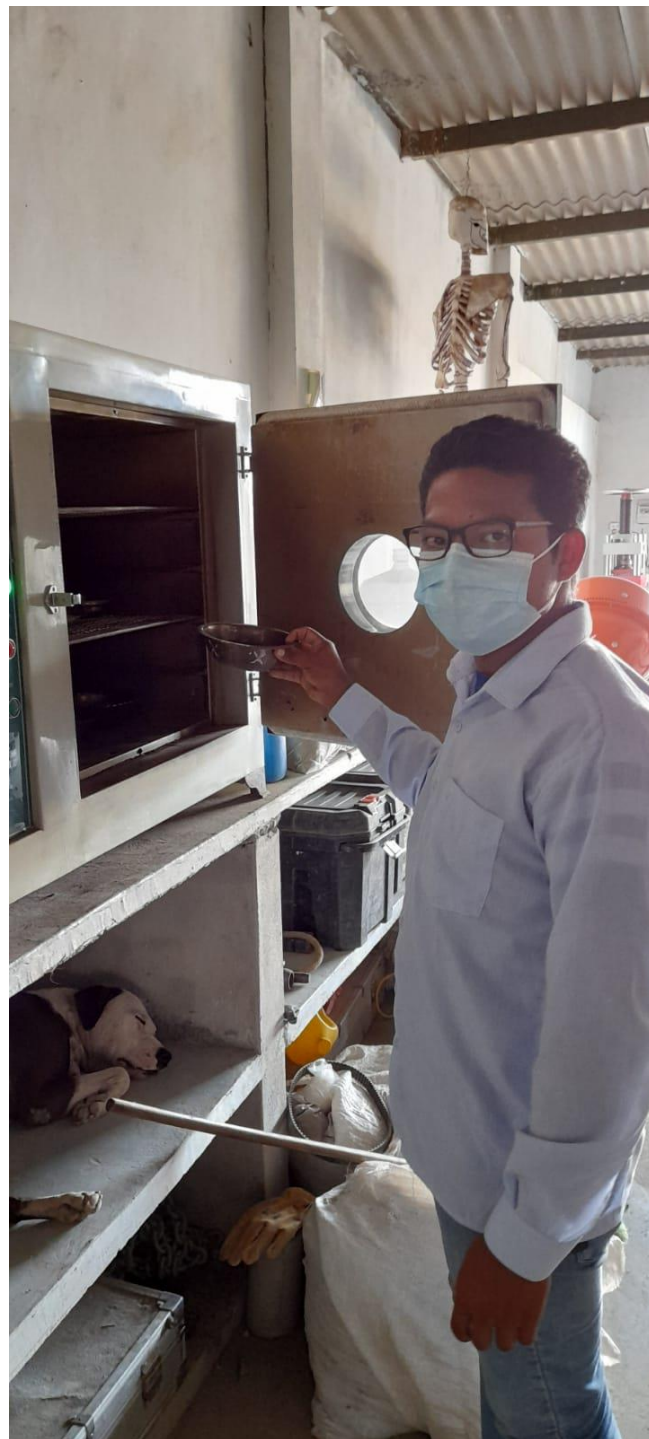
FOTO: COLOCACION DE MUESTRA AL HORNO PARA DETERMINAR EL PESO DEL MATERIAL SECO
