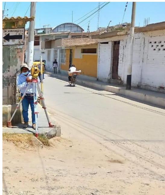
FOTO: TOMA DE PUNTOS CON ESTACION TOTAL DEL JIRÓN MARIANO DIAZ ENTRE LAS CALLES JUNIN Y MOQUEGUA
