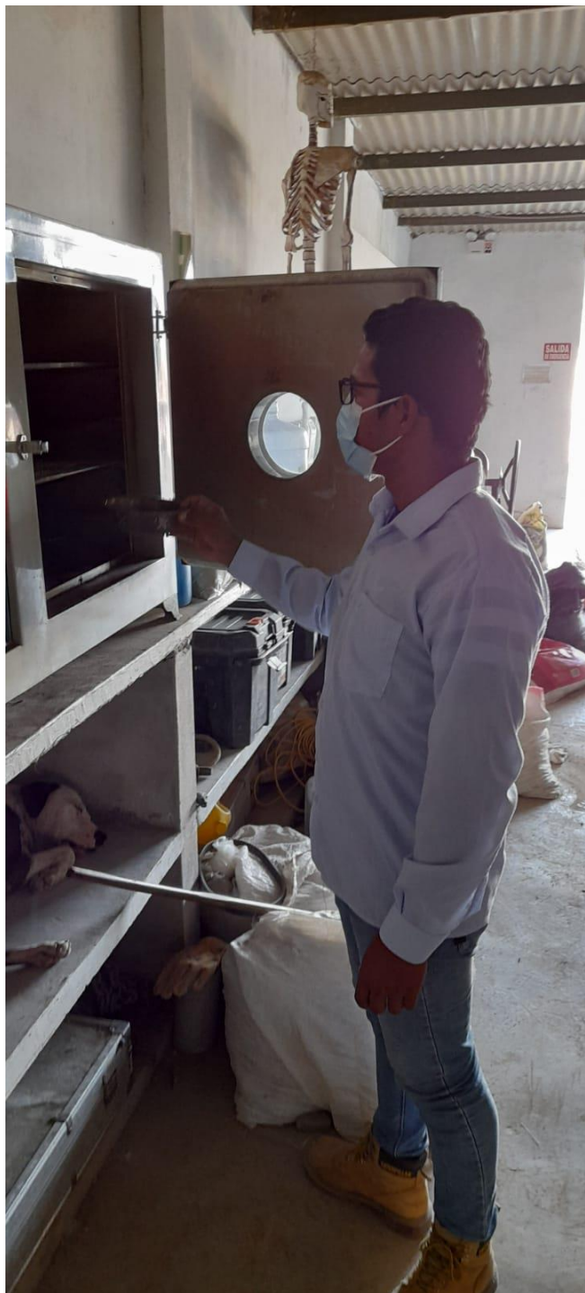
FOTO: COLOCACION DE MUESTRA AL HORNO PARA DETERMINAR EL PESO DEL MATERIAL SECO
