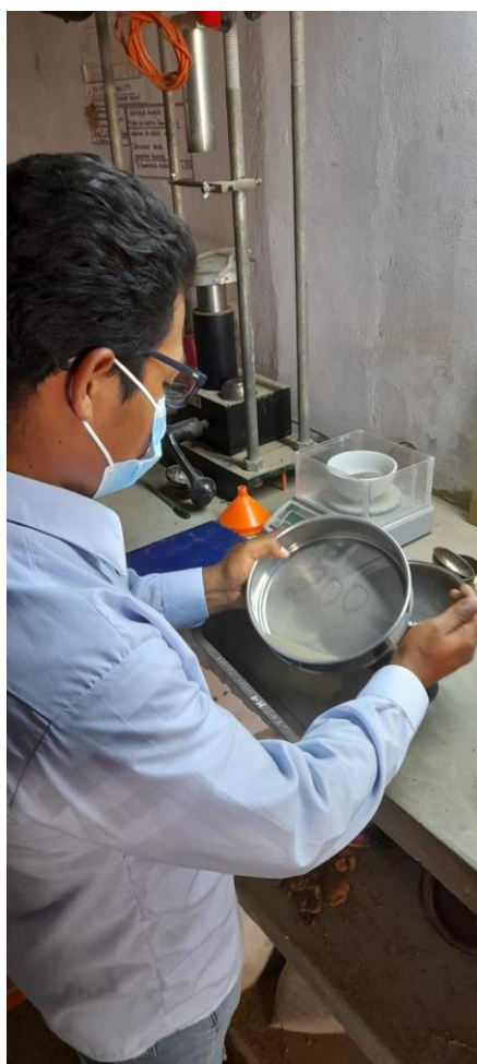
FOTO: PESADO Y ANOTACION DE MATERIAL TAMIZADO CON MALLA N° 200
