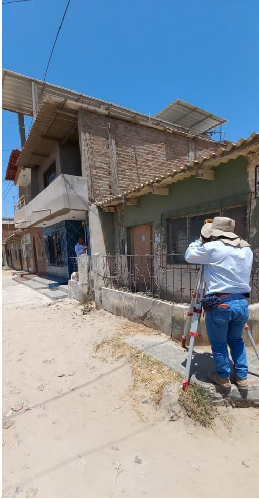
FOTO: TOMA DE PUNTOS CON ESTACION TOTAL DEL JIRÓN MARIANO DIAZ ENTRE LAS CALLES ICA Y PISCO
