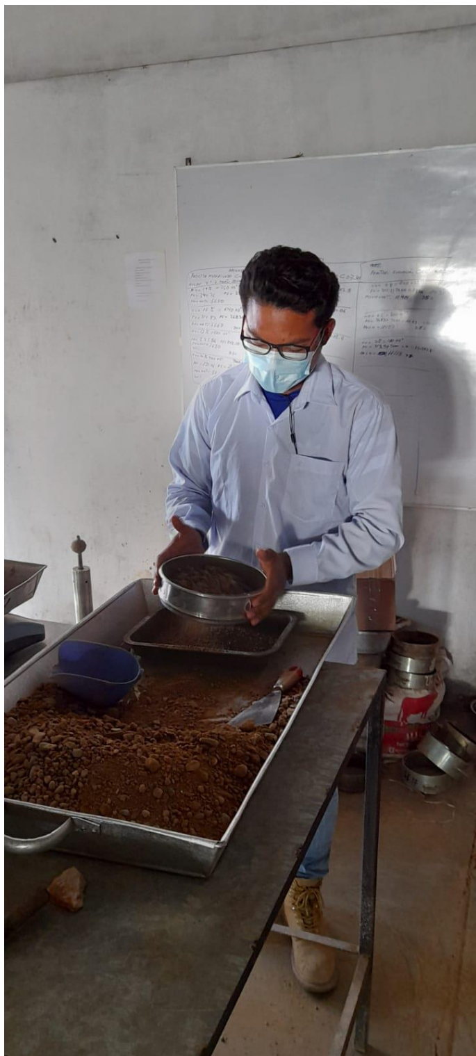
FOTO: TAMIZADO DE MATERIAL EXTRAIDO DE CALICATAS DEL JR. MARIANO DIAZ CON MALLA N° 04
