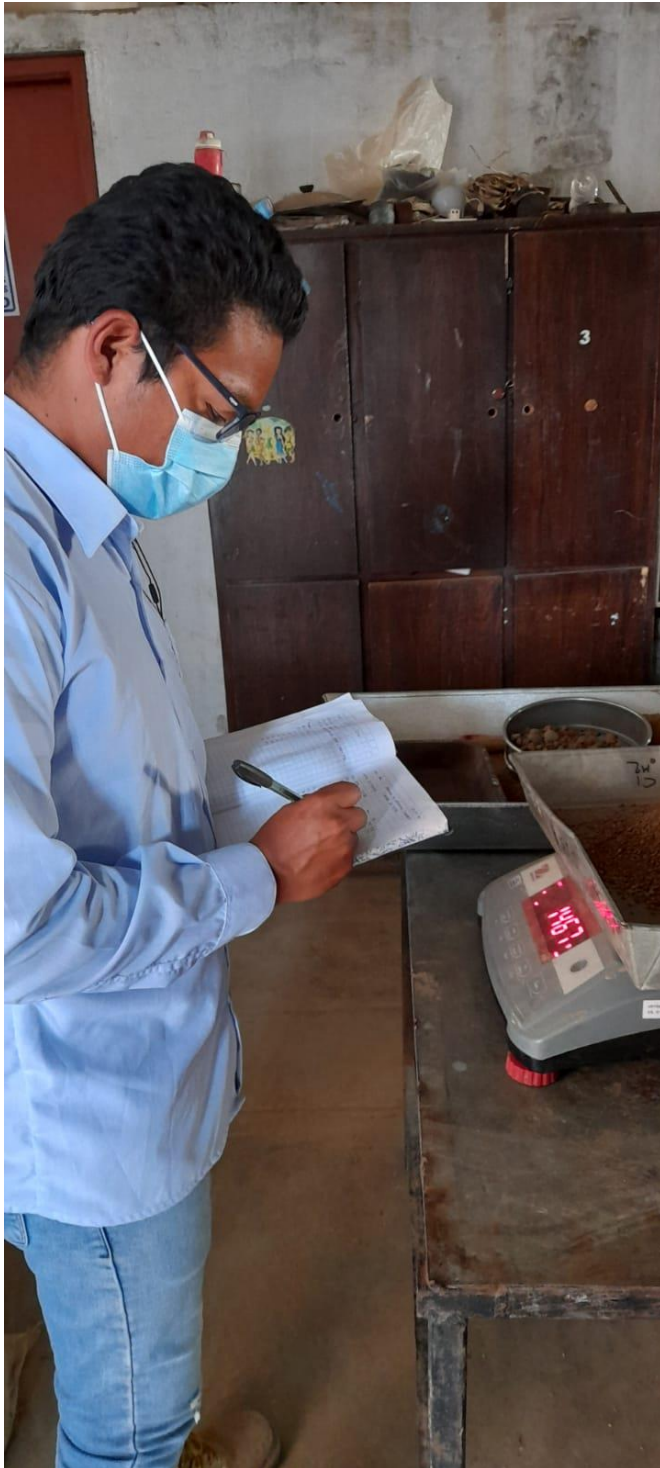
FOTO: PESADO Y ANOTACION DE MATERIAL EXTRAIDO DE CALICATAS LOS CUALES FUERON TAMIZADOS PREVIAMENTE CON MALLA N°04
