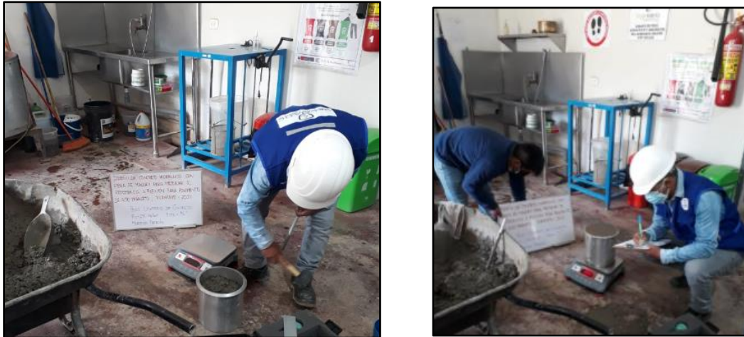
Figura 17: Ensayo de peso unitario de concreto sin y con fibra de maguey
