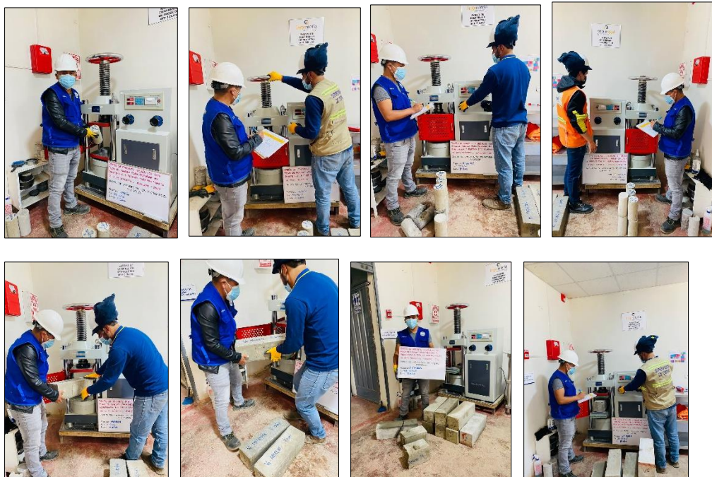
Foto 14: Rotura de probetas y vigas
