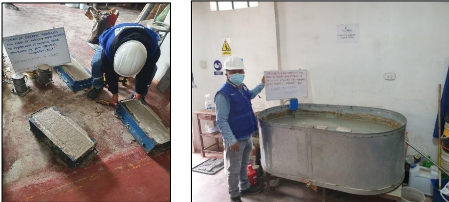
Figura 20: Desencofrado y curado de probetas y vigas
