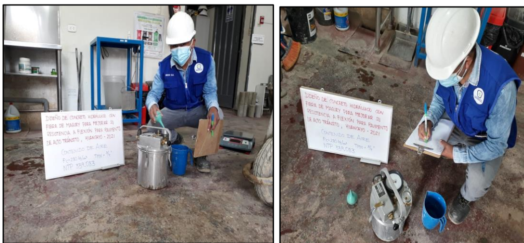
Figura 16: Ensayo de contenido de aire sin y con fibra de maguey
