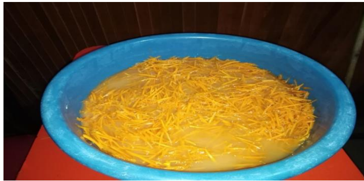
Figura 13. Fibras tratadas con cal hidratada
