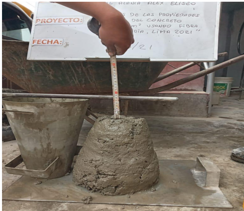
Ensayo del asentamiento del concreto.
