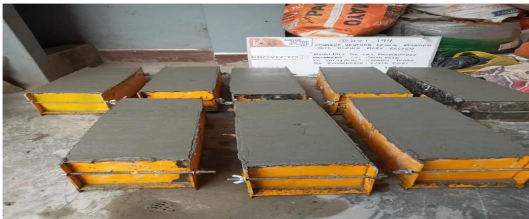
Elaboración de las vigas prismáticas.
