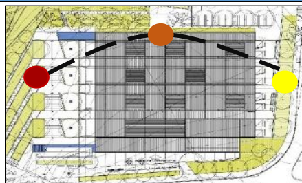
ILUSTRACIÓN 48: Asoleamiento El sol aparece desde la parte posterior del proyecto. Se aprovecho para generar una vista directa hacia el paisaje.
