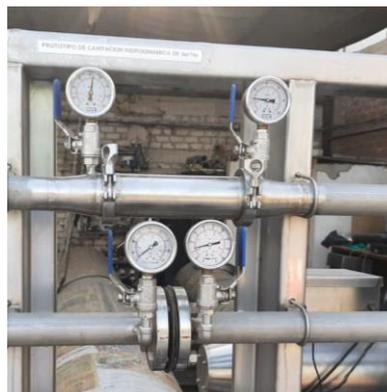
Figura 8: Control y supervisión de la presión
