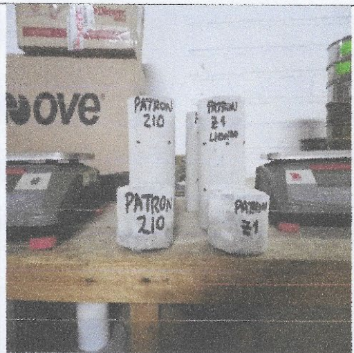
TESTIGOS SECCIONADOS PARA SELECCIONAR LA MUESTRA PARA EL ENSAYO DE VELOCIDAD DE ABSORCION DE AGUA PARA CONCRETOS
