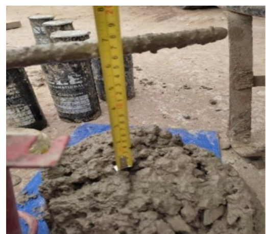
Figura N°27: Medición del asentamiento con el tercer aditivo.
