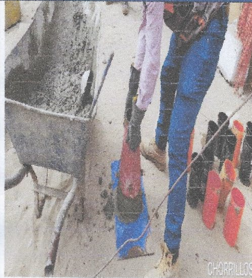
ENSAYO DE ASENTAMIENTO DEL CONCRETO Y ELABORACION DE PROBETAS CILINDRICAS
