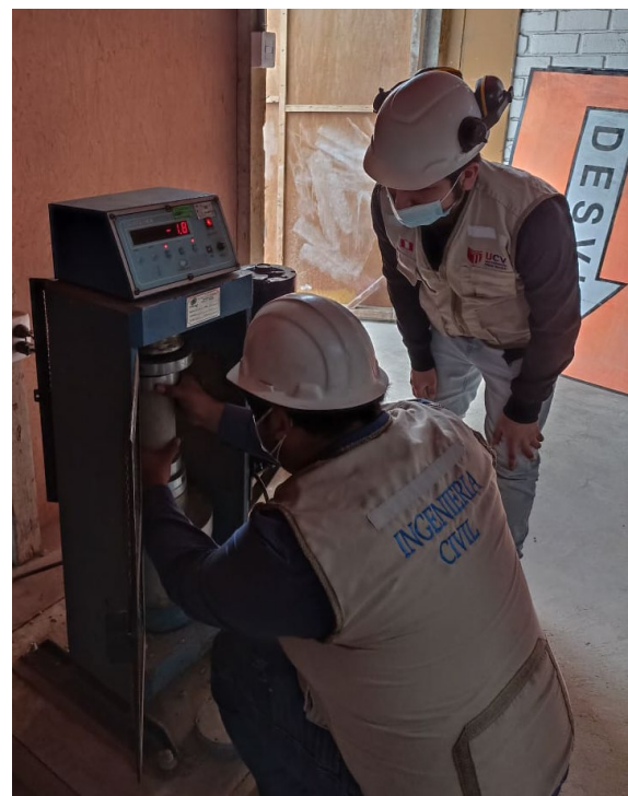
Figura N°30: Rotura de concreto a compresión
