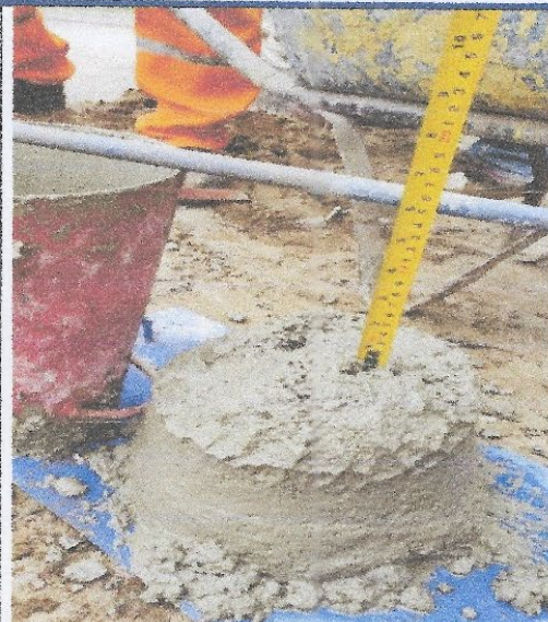
ENSAYO DE ASENTAMIENTO DEL CONCRETO Y ELABORACION DE PROBETAS CILINDRICAS
