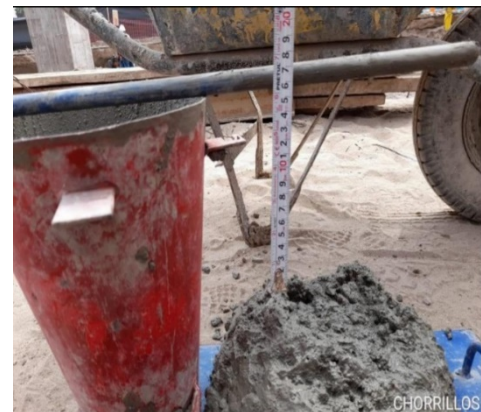
Figura N°25: Medición del asentamiento con el primer aditivo
