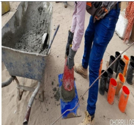
Figura N°24: Retiro del cono de Abrams
