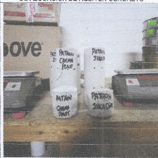
TESTIGOS SECCIONADOS PARA SELECCIONAR LA MUESTRA PARA EL ENSAYO DE VELOCIDAD DE ABSORCION DE AGUA PARA CONCRETOS
