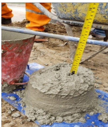
Figura N°26: Medición del asentamiento con el segundo aditivo.
