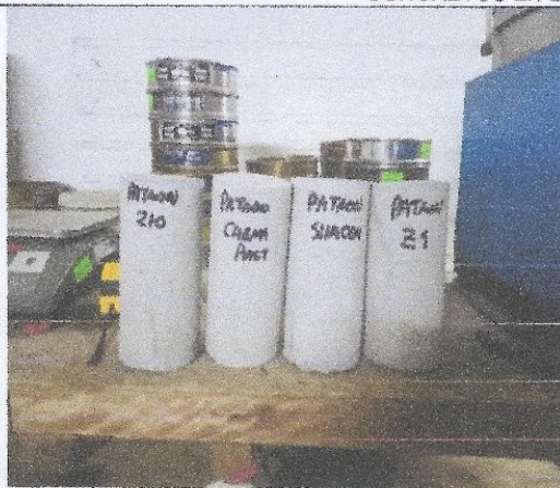
PREPARACIÓN DE MUESTRAS PARA LA EJECUCIÓN DEL ENSAYO DE RESISTENCIA A LA COMPRESION
