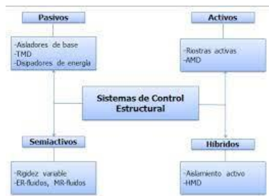
Figura 3. Tipos de Sistemas de protección sísmica
