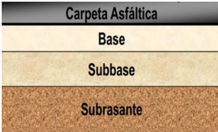
Figura 1. Capas del paquete estructural del pavimento flexible.
