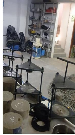
Realizando el ensayo de Permeabilidad a Alta Presión
