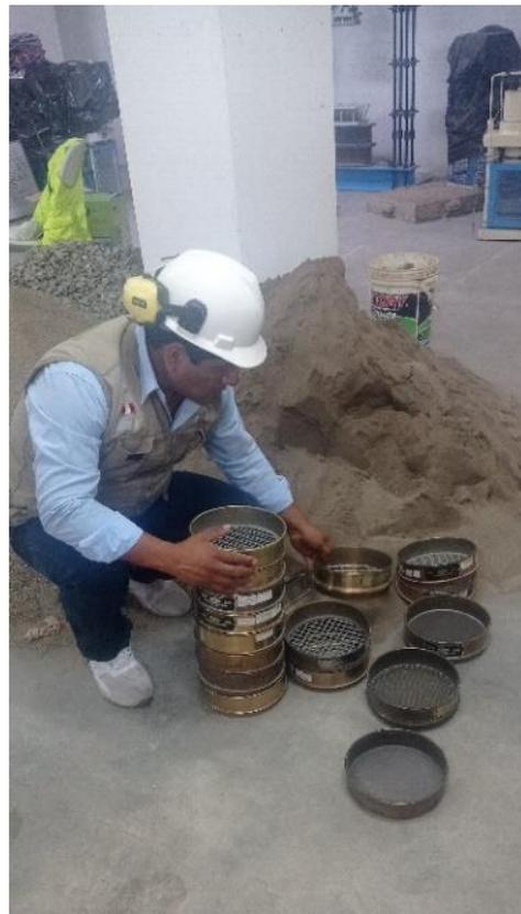
Colocando los Tamices para el Ensayo de Granulometría
