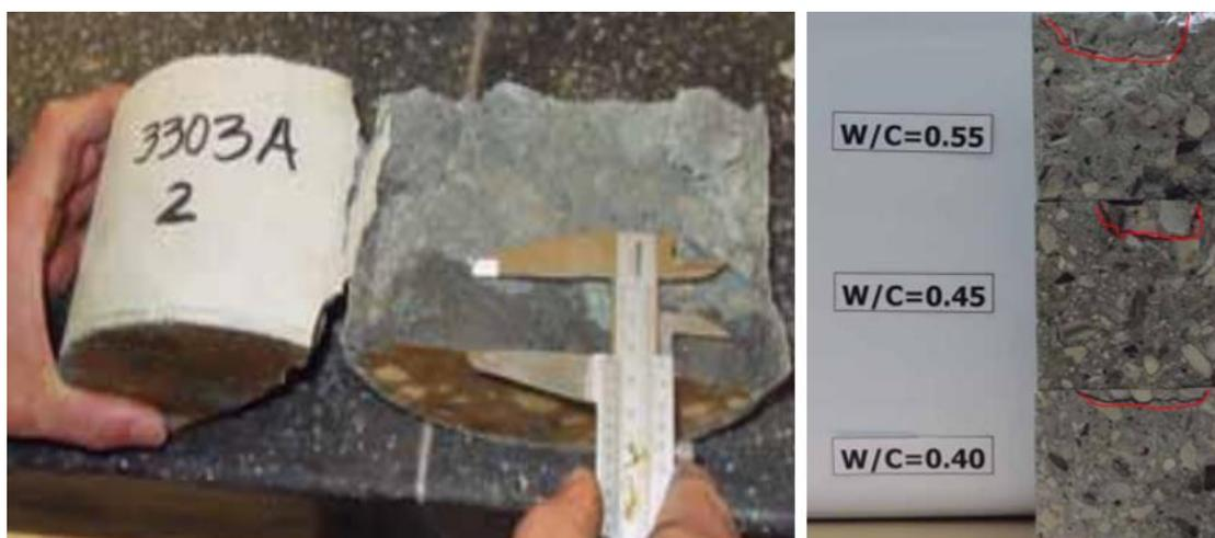
**Fig. 9.** Determinación de la penetración del agua en el concreto
