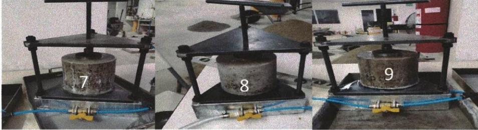
NOTA : La evaluación del ensayo de permeabilidad del concreto bajo UNE 12390-8 Ensayo de Penetración de agua por presión a los 3 testigos cilíndricos de 150 mm de diámetro , 15 mm de altura y ninguna otra dimensión menor a 100 mm.
