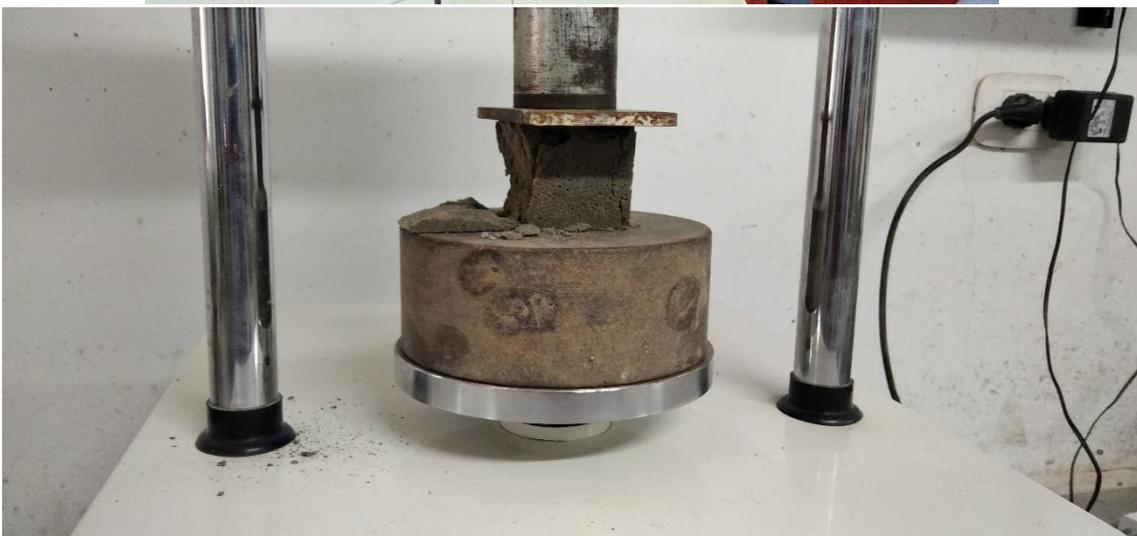
Realizando la Rotura de las Muestras para determinar la Resistencia a la Compresión
