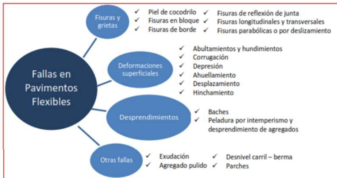
Figura 1: Fallas en los pavimentos flexibles establecidos por el PCI
