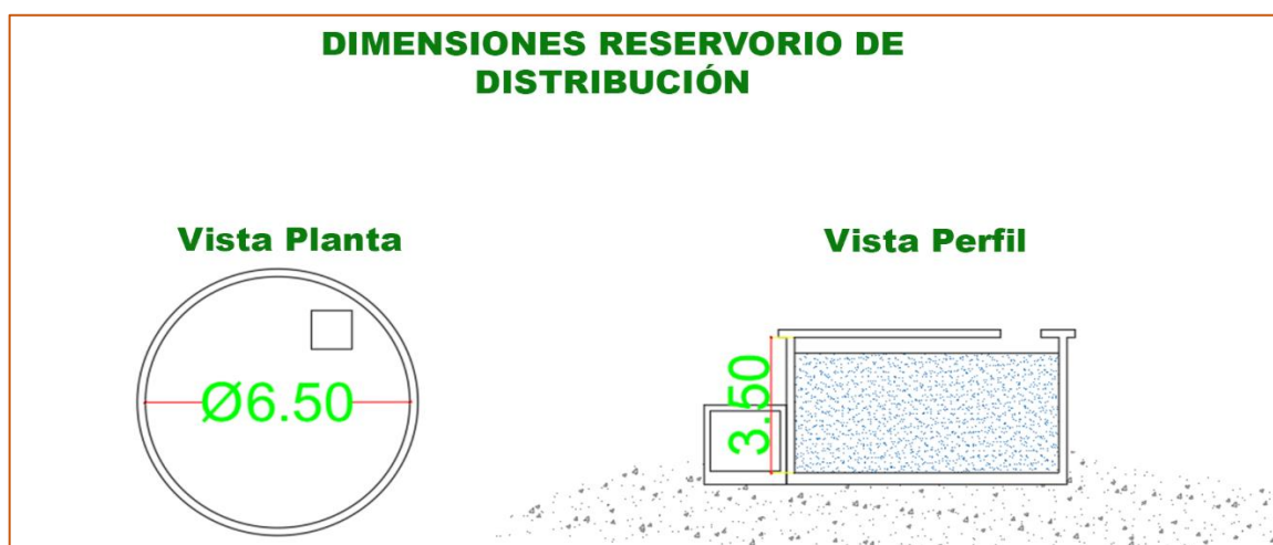
Figura N° 04. Dimensiones Reservoirio de Distribución
