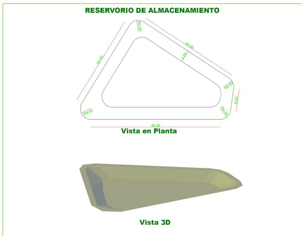
Figura N° 01. Dimensiones Reservoirio de almacenamiento
