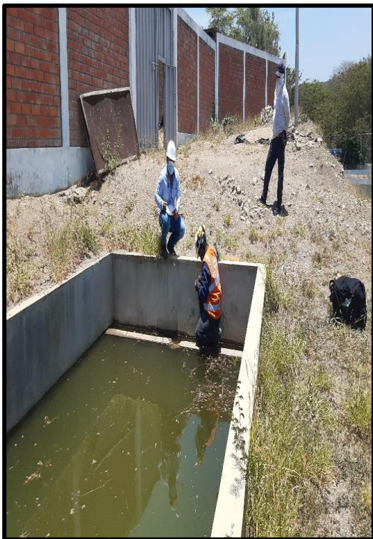
Fotografía N° 09: Realización del ensayo de esclerometría en el sedimentador y filtro de arena.
