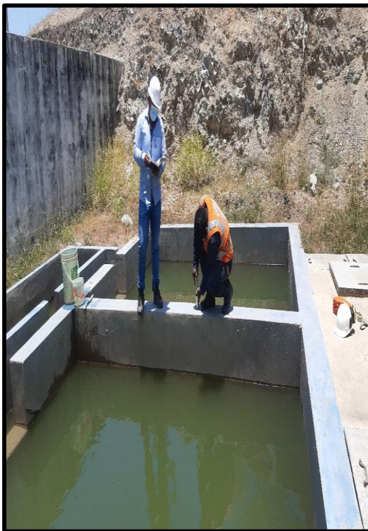
Fotografía N° 09: Realización del ensayo de esclerometría en el sedimentador y filtro de arena.
