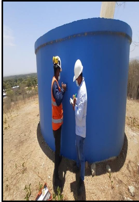
Fotografía N° 17: Realización del ensayo de esclerometría en la pared del reservorio de distribución
