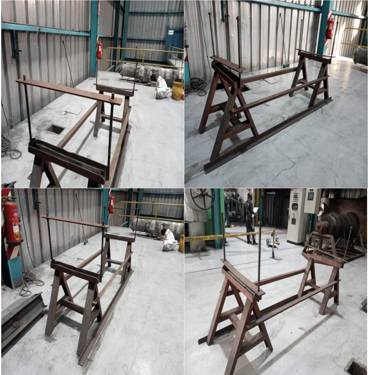
Figura 29: Construcción del caballete regulable
