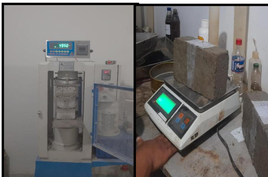
Fig. N° 17. Resistencia a la compresión en pilas de ladrillo - rotura
