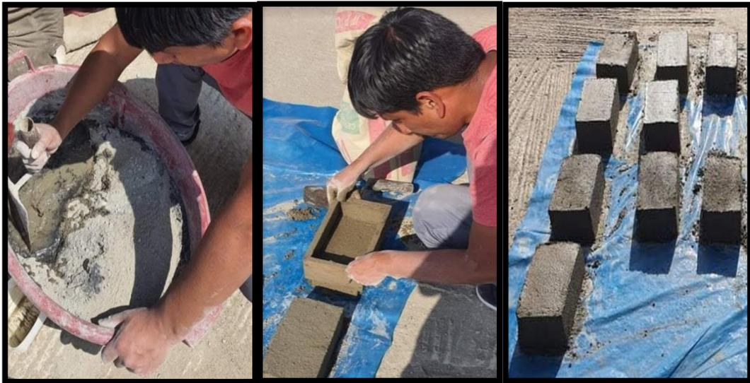
3° Determinamos el diseño de mezcla con adición de CBCA en porcentajes de 5%, 10% y 20%; de las que tendremos 9 ladrillos de concreto para cada porcentaje, siendo en total 27 ladrillos que fueron sometidas a ensayo de compresión en 7, 14 y 28 días. para comparar los resultados obtenidos con el concreto  $f'c=210$  kg/cm<sup>2</sup> convencional y el concreto  $f'c=210$  kg/cm<sup>2</sup> con adicionamiento de CBCA.
