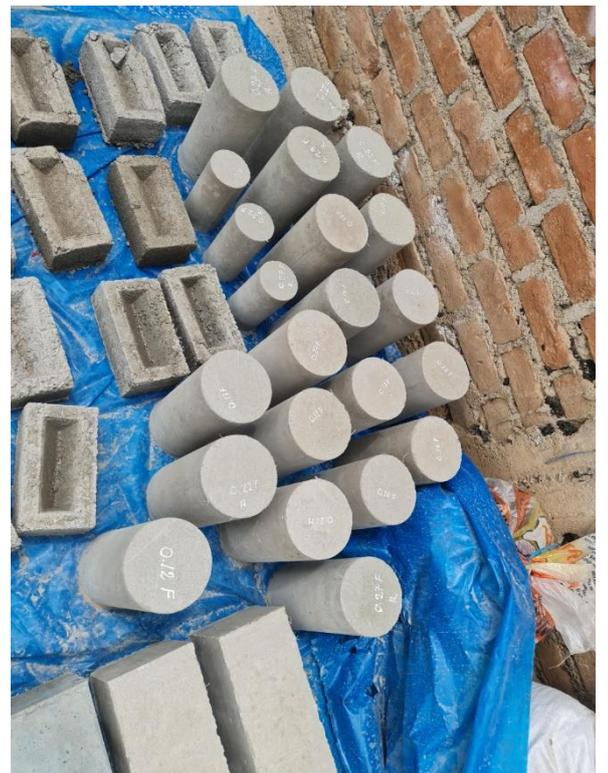
CURADO DE LOS ESPECÍMENES DEL  $f_c=210\text{kg/cm}^2$  MUESTRAS PATRÓN O CONTROL Y EXPERIMENTAL A LOS 7, 14 Y 28 DÍAS
