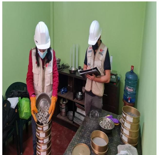
ELABORACIÓN DEL CONCRETO  $f'c=210\text{kg/cm}^2$  PARA LAS MUESTRAS PATRÓN Y LAS MUESTRAS CON ADICIONES DE FIBRA DE PROLIPROPILENO RECICLADAS DE MASCARILLAS FACIALES AL 0.12%,0.17%,0.22%,0.27% EN VOLUMEN
