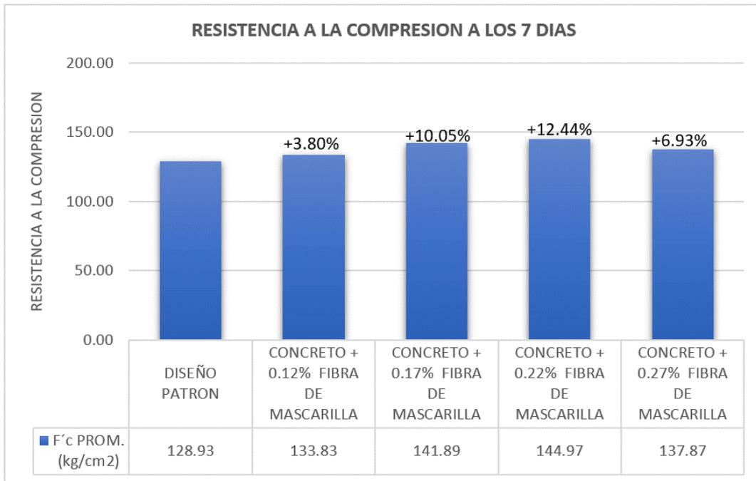
Figura 16. Resistencia a la compresión a los 7 días del concreto  $f'c=210$  kg/cm<sup>2</sup> incorporando fibras de polipropileno recicladas de mascarillas faciales.
