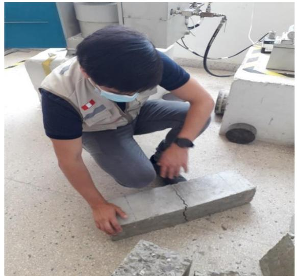
ENSAYO A LA FALLA DE LOS ESPECIMENES DE LA MUESTRA PATRÓN Y LA EXPERIMENTAL A LOS 7, 14 Y 28 DÍAS DE RESISTENCIA A LA TRACCION INDIRECTA
