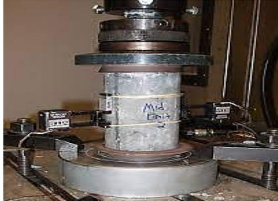
Figura 7. Ensayo de resistencia a la compresión
