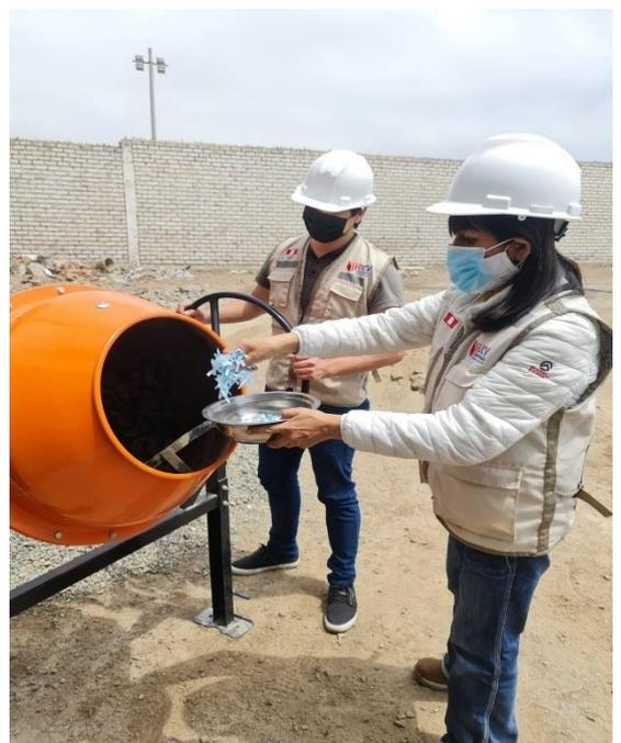
ELABORACIÓN DE LAS MUESTRAS DE CONCRETO DE  $FC=210\text{kg/cm}^2$  DE MUESTRAS PATRÓN Y ESPERIMENTAL AL 0.12%,0.17%,0.22%,0.27% EN VOLUMEN, UTILIZANDO PROBETAS CILINDRICAS PARA LA RESISTENCIA A LA COMPRESIÓN Y TRACCION INDIRECTA, PROBETAS PIRAMIDALES PARA LA RESISTENCIA A LA FLEXIÓN.
