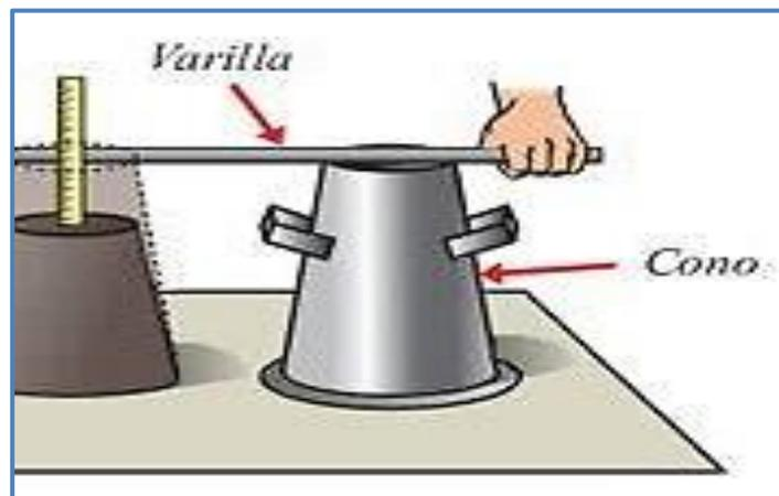
Figura 2. Procedimiento de la medida del Slump
