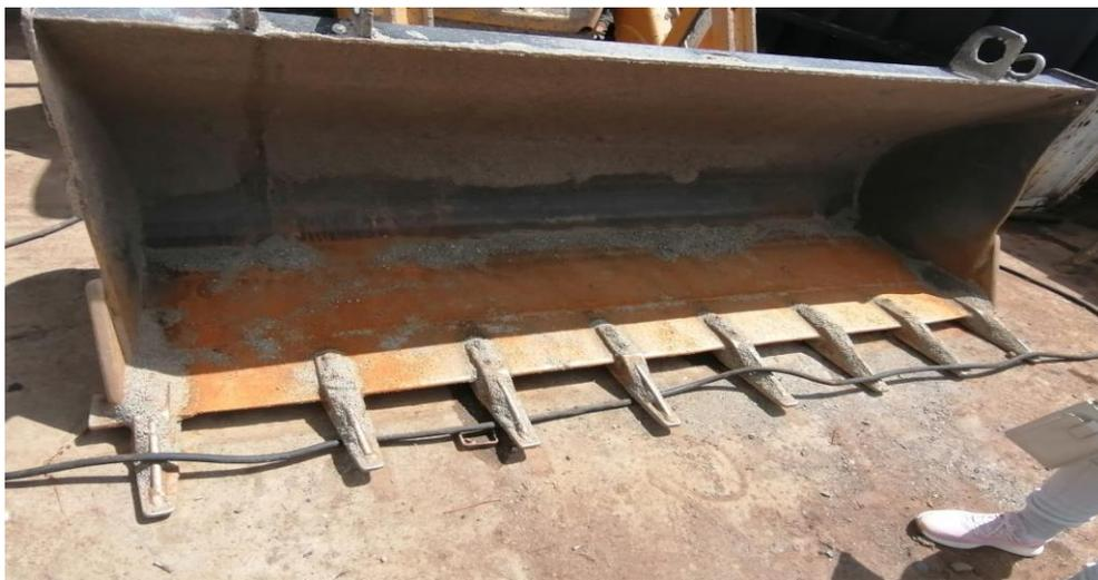
**Figura 56.** Uñas para retroexcavadora.
