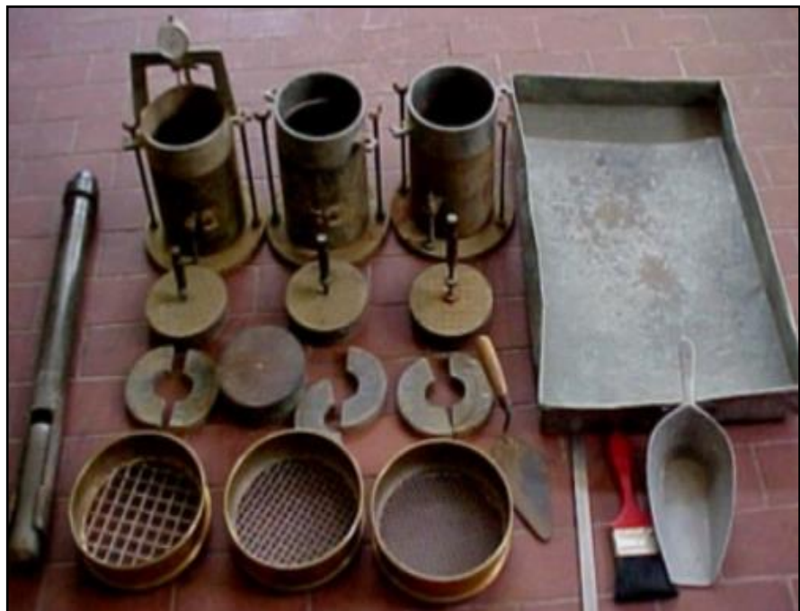
Figura 9. (Equipo de compactación e inmersión del ensayo CBR).
