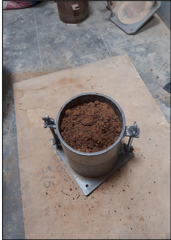
Figura 12. Compactación en molde 6" para CBR.
