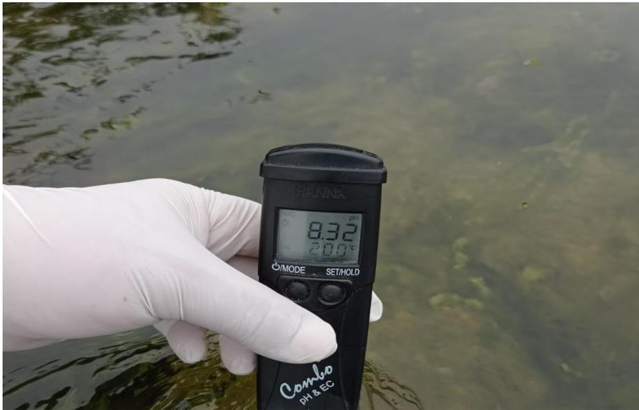
Figura 11. Medición de temperatura y pH In Situ de la muestra.
