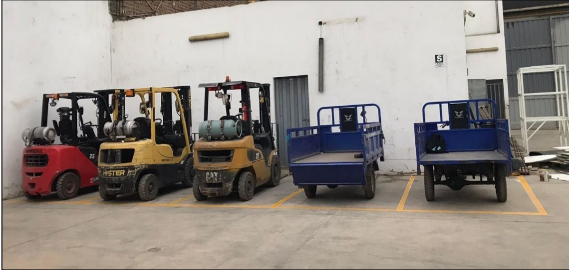
Figura 52: Señalización de suelo del área parqueo de motos y montacargas.
