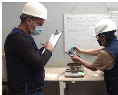
Foto N° 05: Ensayo de peso unitario suelto
