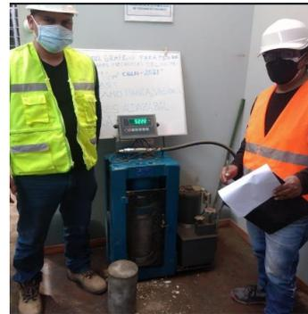
**Foto N° 22:** Resistencia a compresión a los 7 días
