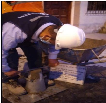
*Figura 10.* Elaboración de ensayo de slump
