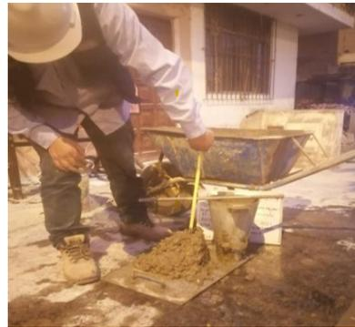
**Foto N° 16:** Medición del slump
