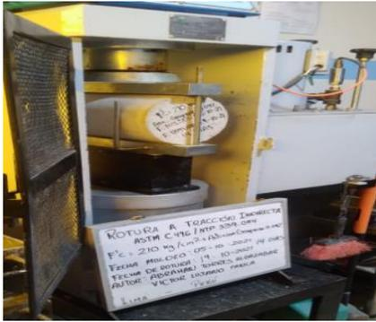
**Foto N° 25:** Ensayo resistencia a tracción 14 días
