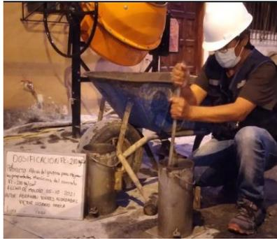
**Foto N° 13:** Etapas de llenado de probetas
