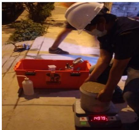
*Figura 3. Ensayo de la densidad del concreto*
