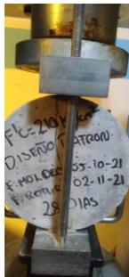
**Foto N° 27:** Falla de ensayo patrón 28 días
