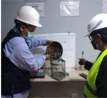
**Foto N° 07:** Peso específico y absorción
