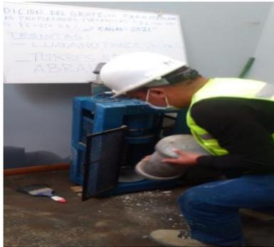
**Foto 19:** Ensayo de compresión
