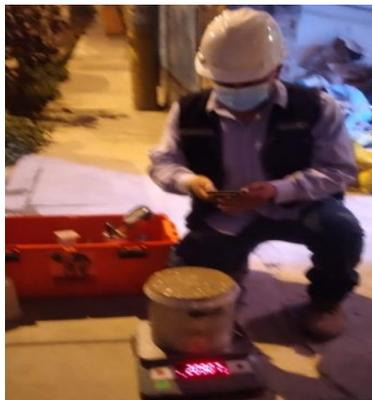
Figura 11. Ensayo de la densidad del concreto
