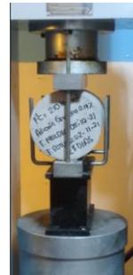
**Foto N° 28:** Falla de ensayo 0.19% de grafeno
