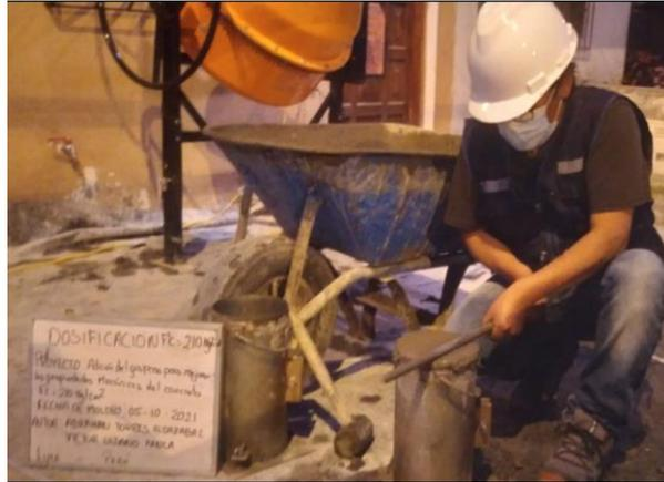
Figura 5. *Elaboración de probetas*
