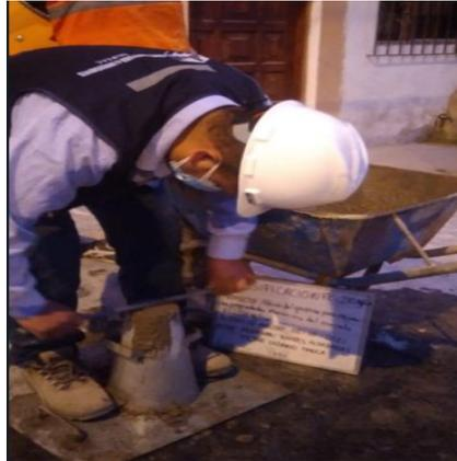
*Figura 4. Elaboración de ensayo de slump*
