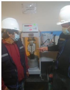
**Foto N° 29:** Resistencia a tracción 0.15% de grafeno
