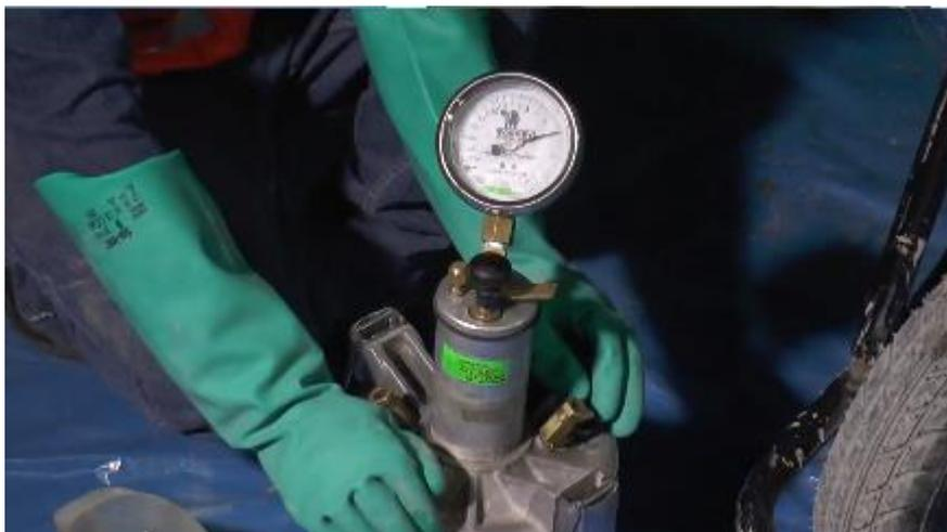
*Figura 5.* Prueba de contenido de aire según ASTM C231
