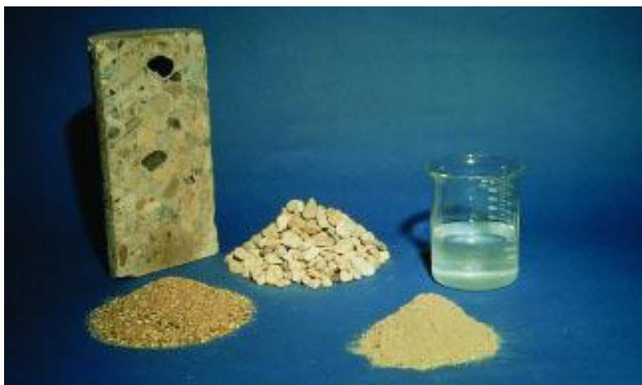
*Figura 1.* Elementos que componen el concreto.
