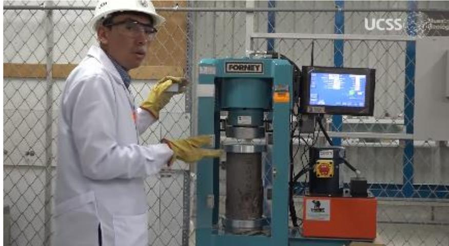
*Figura 7.* Prueba de dureza del concreto según NTP 339.034-2015.
