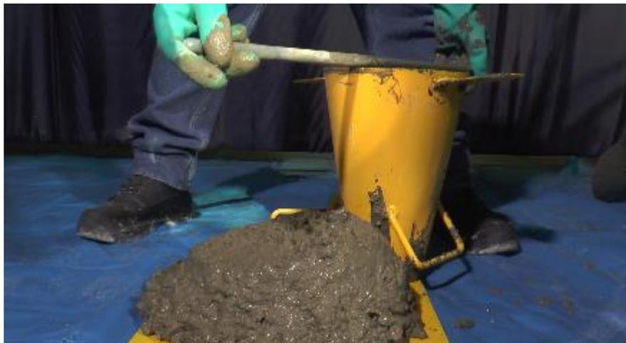
*Figura 3. Ensayo de consistencia según la NTP 339.035-2009*
