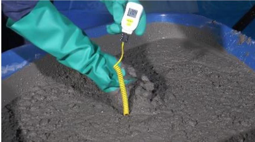
*Figura 4.* Prueba de temperatura según la NTP 339.184-2018
