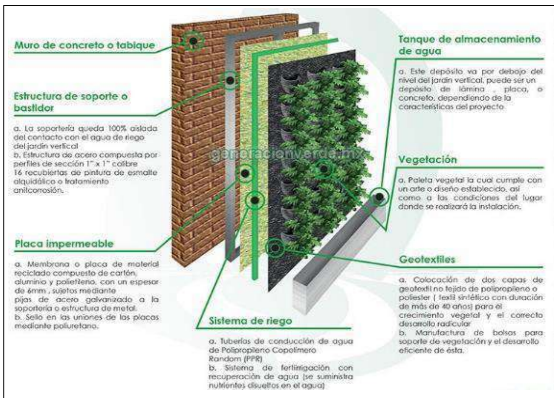
Figura 28. Muro verde. Partes de un muro verde.
