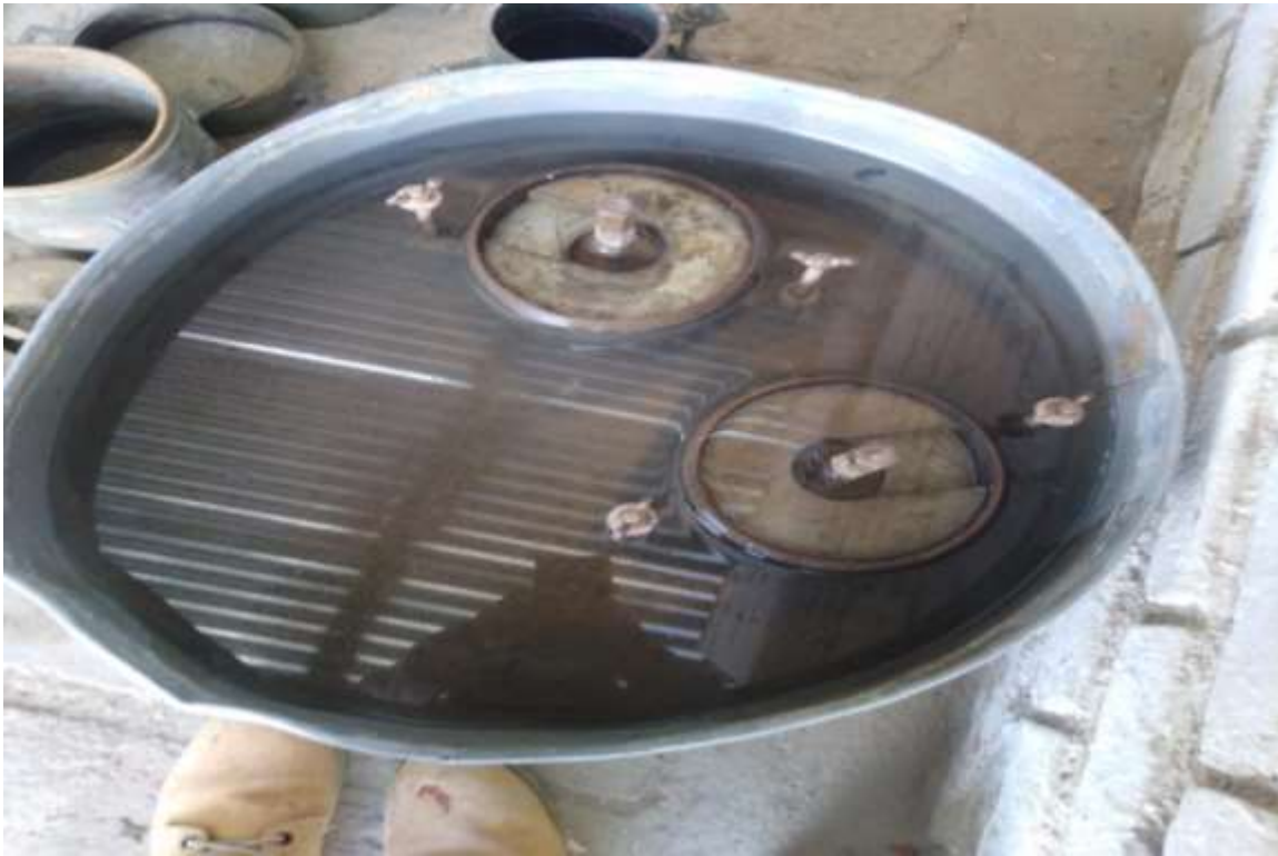
Figura 53: Especímenes sumergidos en agua por un periodo de 4 días.
