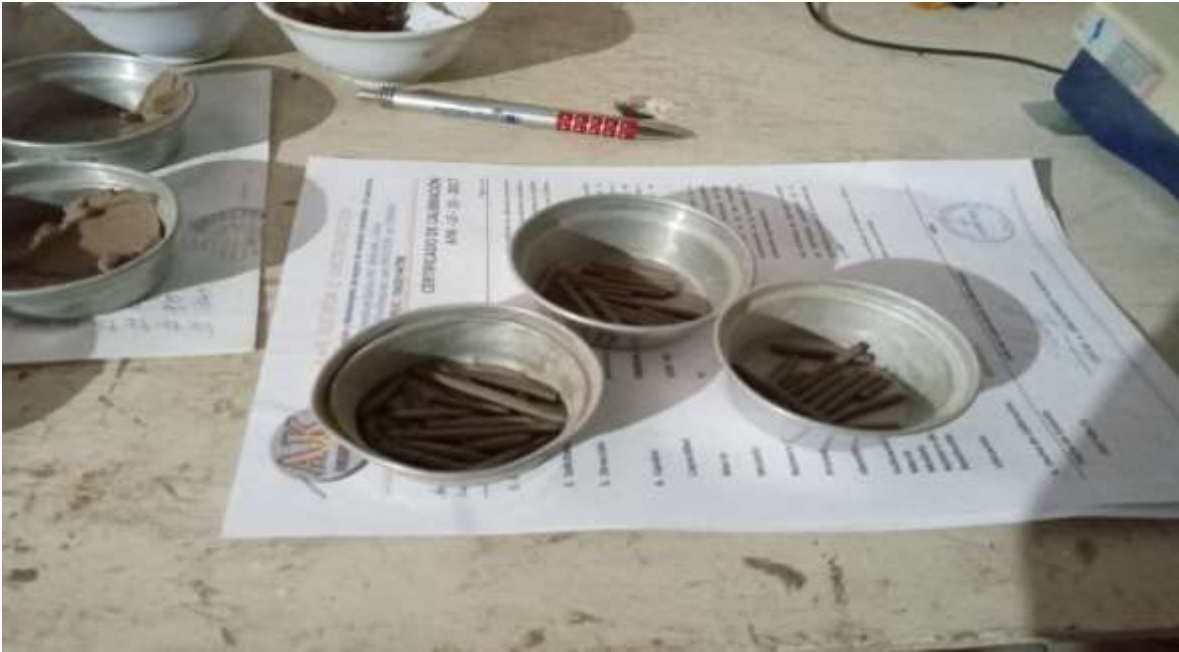
Figura 45: Realización de ensayo de límite plástico.
