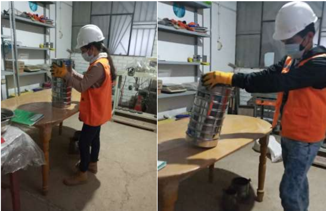
Figura 43: Realización del ensayo de análisis granulométrico
