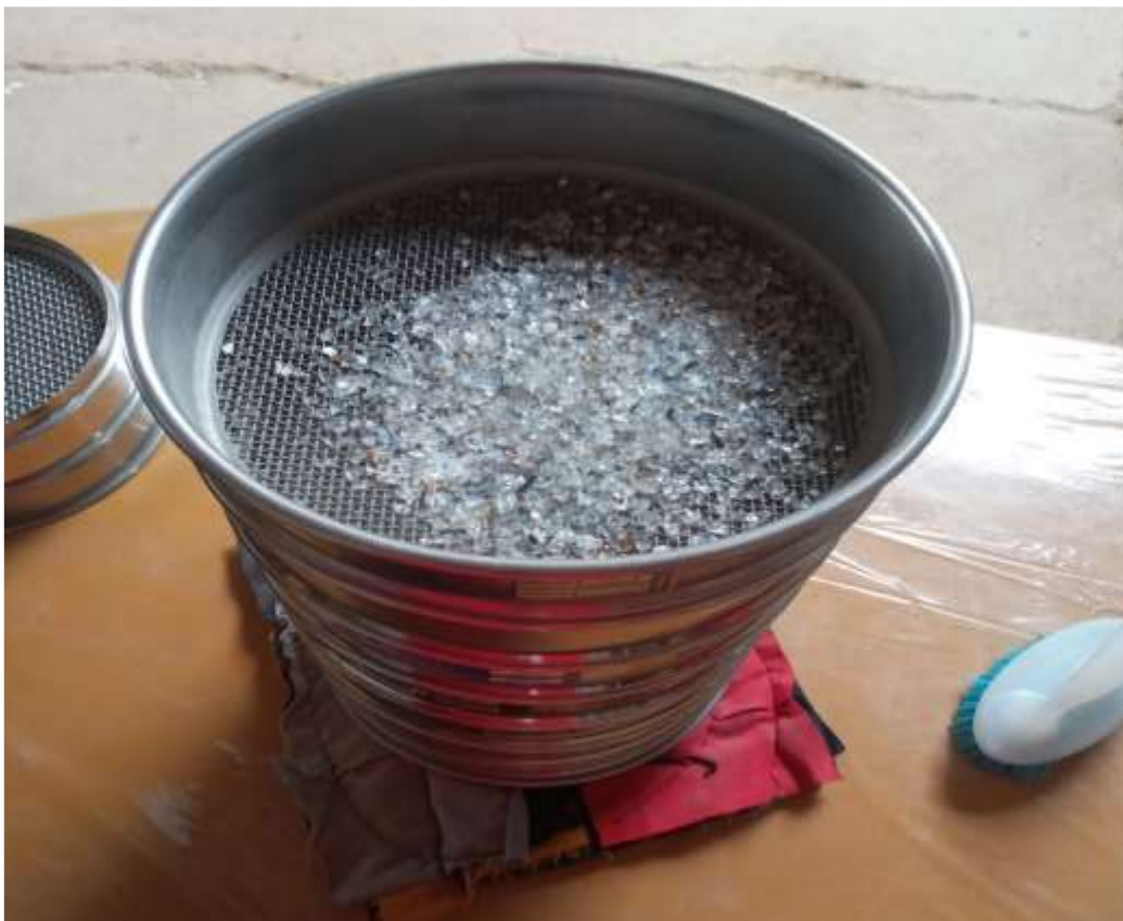
Figura 50: Realización de la granulometría del vidrio triturado.
