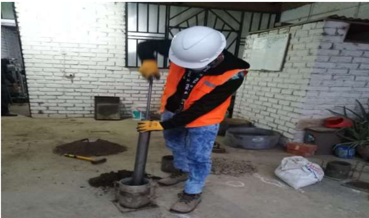
Figura 46: Ensayo de proctor modificado suelo natural, 2021
