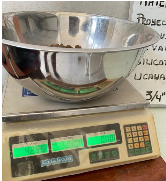
. Imagen 3. Pesado de muestra sin clasificar
