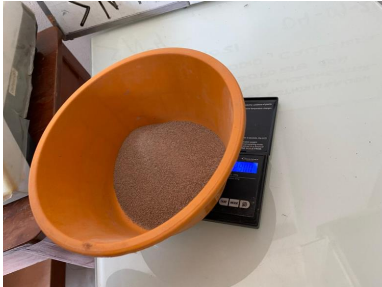
. Imagen 6. Pesado de muestra clasificada.
