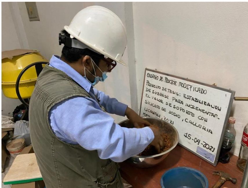
. Imagen 7. Dosificación de materiales.
