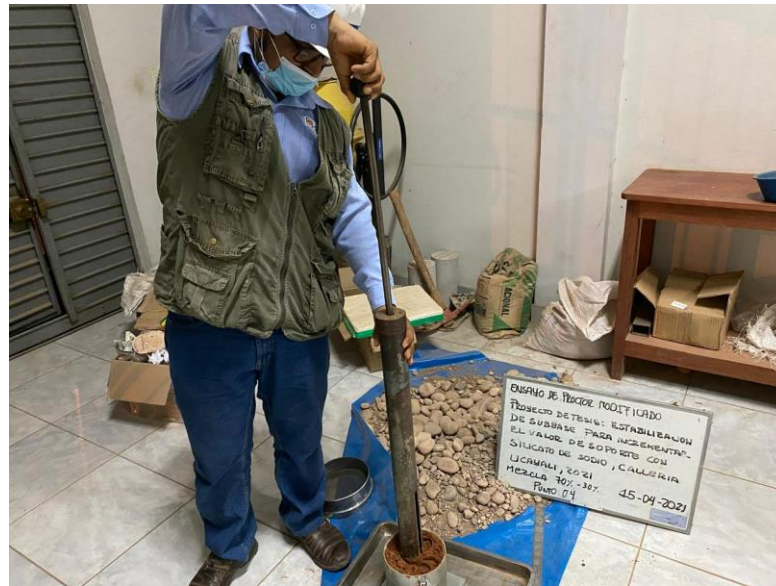
. Imagen 8. Aplicación de fuerza a muestra dosificada.
