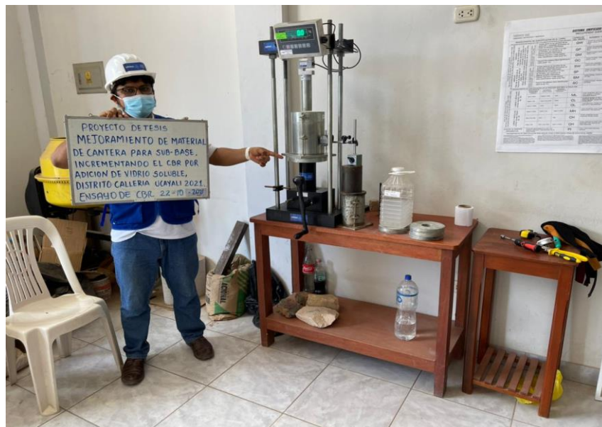
. Imagen 14. Estructura para el ensayo del CBR
